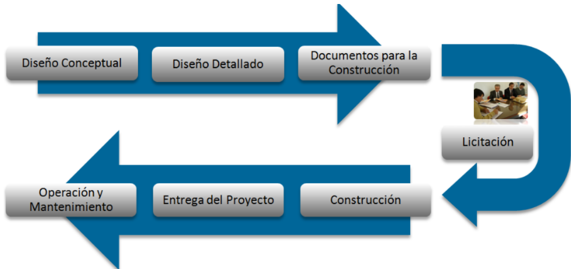
Figura 38 : Etapas del modelo Diseño/Licitación/Construcción
