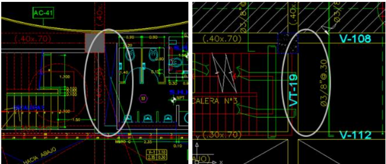
Figura 29 :(Izquierda) Dueto según el plano de arquitectura. (Derecha) Omisión del dueto en los planos de estructuras
