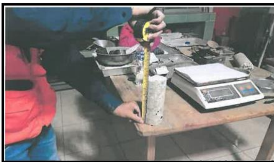
Foto 2 Testigos Diamantinos (N°1-153mm - N°2-150mm y N°3-159mm)
