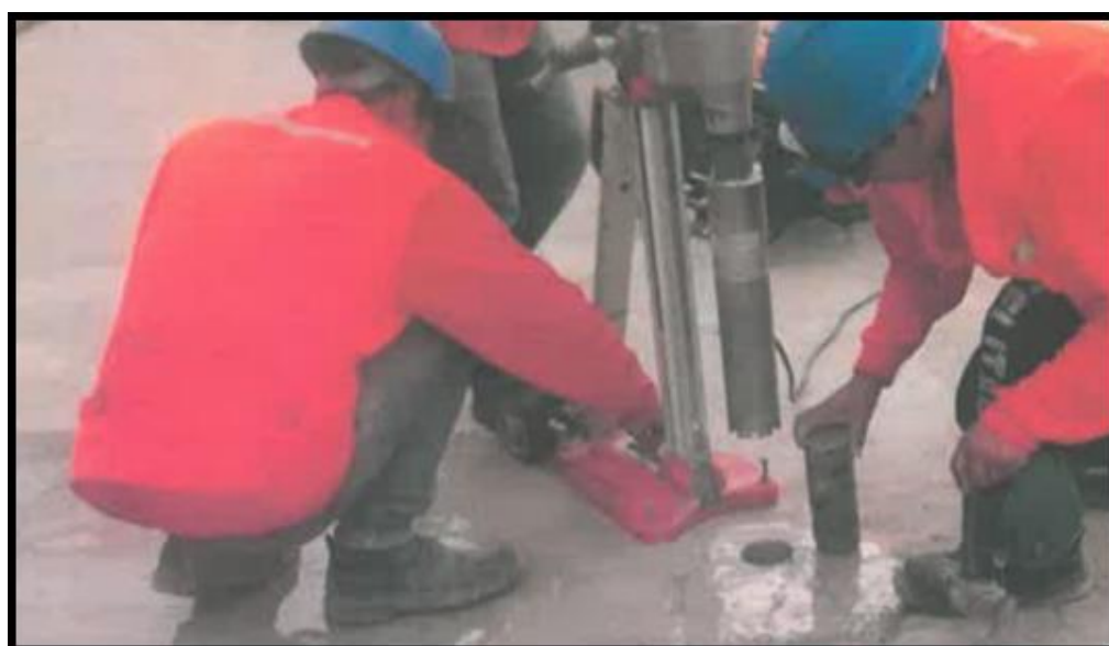
Foto N°6: Extracción del Testigo Diamantino, Diamantina N° 1
