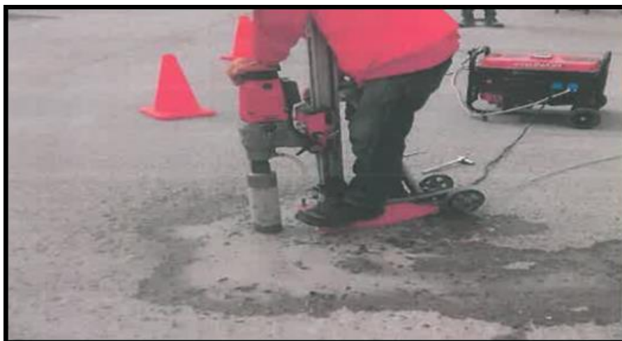
Foto N°9: Extracción del Testigo Diamantino, Diamantina N° 3
