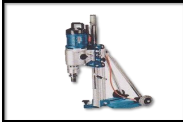
Figura N°6: Pedestal para la fijación del equipo de Diamantina
