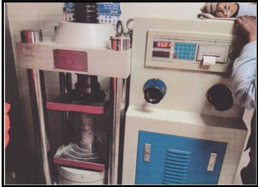
Foto N°4: Rotura de Testigos Diamantinos.
