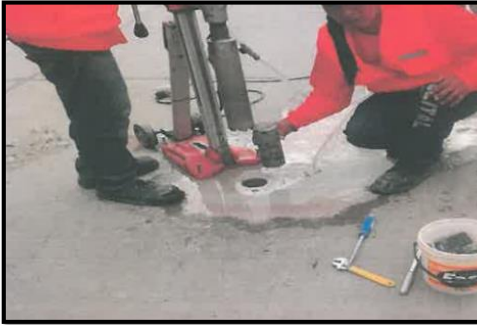
Foto N°10: Extracción del Testigo Diamantino, Diamantina N° 3
