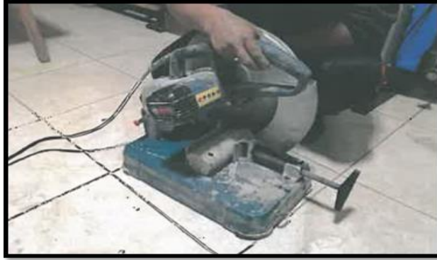
Foto 3: Tallado y Pulido de Testigos Diamantinos.
