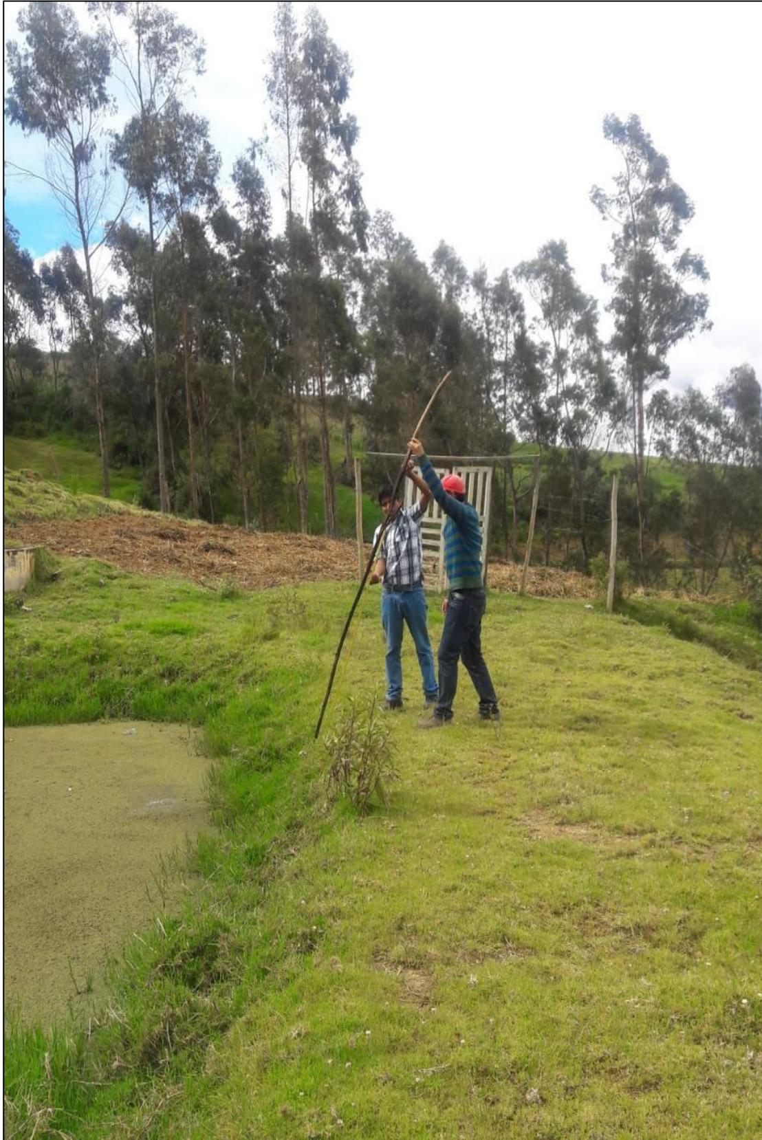
Fotografía 10. Se realiza la medición de la altura de las lagunas en diferentes puntos, con la ayuda de una barra de madera con medición.
