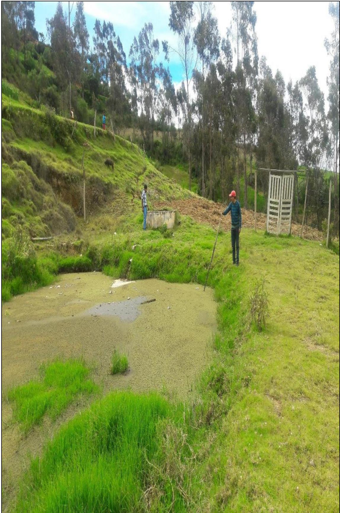
Fotografía 9. Se realiza la medición de la altura de las lagunas en diferentes puntos, con la ayuda de una barra de madera con medición.
