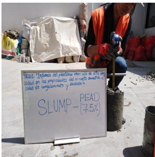
Figura 69. Obtención de la Trabajabilidad del concreto con 7.5% de PEAD
