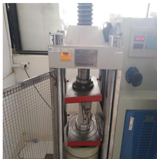
Figura 48. Probeta después del Ensayo a Compresión
