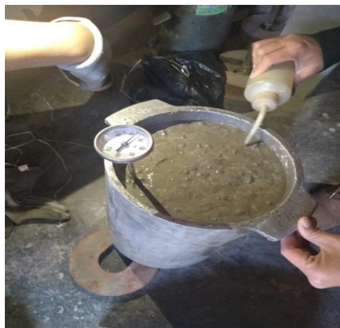
Figura 87. Registrando la Temperatura del concreto
