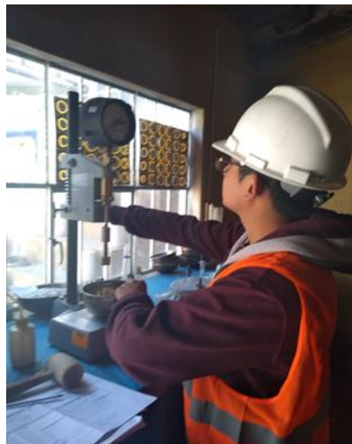
Figura 83. Insertando la aguja en la determinación de la resistencia a la Penetración (4000 PSI)
