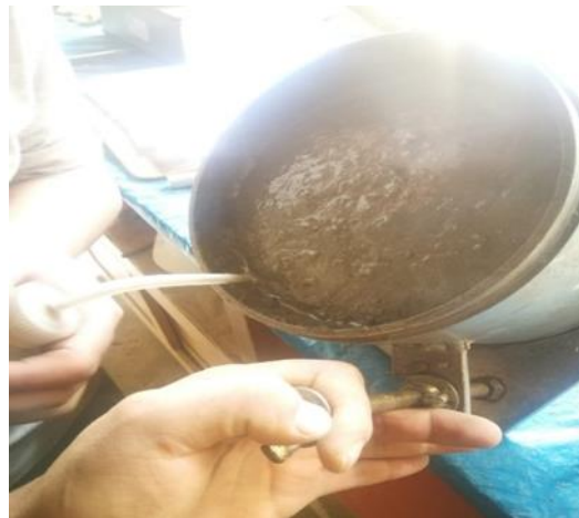
Figura 98. INCLINACIÓN DE MUESTRA DE CONCRETO SIN PEAD PARA RECOLECCIÓN DE AGUA DE EXUDACIÓN.
