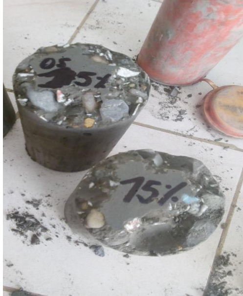
Figura 64. Especímen de concreto con 15% de PEAD después del Ensayo a Compresión
