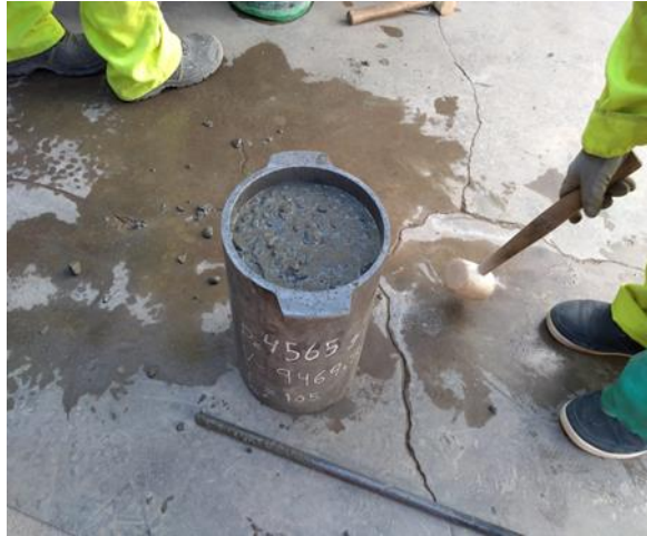
Figura 85. MUESTRA DEL CONCRETO SIN PEAD PARA EXUDACIÓN En la imagen se observa los golpes al costado del recipiente con comba de goma.
