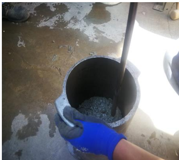
Figura 94. ENSAYO DE EXUDACIÓN DEL CONCRETO CON PEAD
