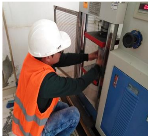
Figura 72. Colocación del espécimen del concreto con 7.5 % PEAD en la Máquina compresora
