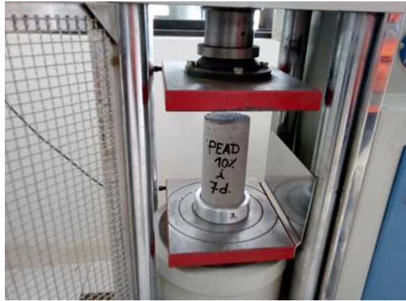
Figura 55. Ensayo a la compresión del Concreto con 10% de PEAD
