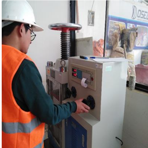
Figura 73. Control de la velocidad del Ensayo a Compresión del Concreto
