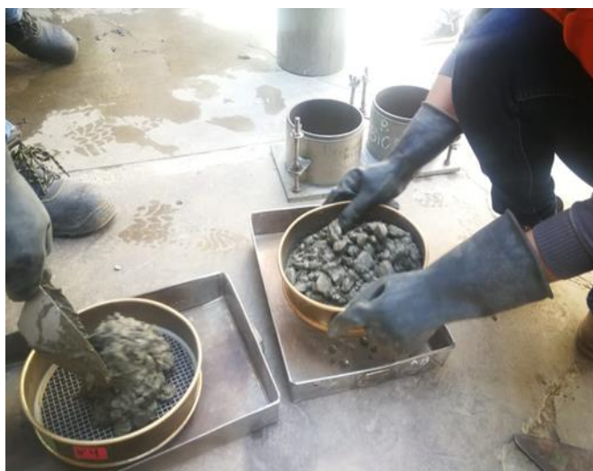
Figura 96. TAMIZADO DE LA MUESTRA CON PEAD POR LA MALLA N° 4
