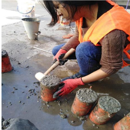
Figura 52. Golpes a los especímenes de concreto con el martillo de goma
