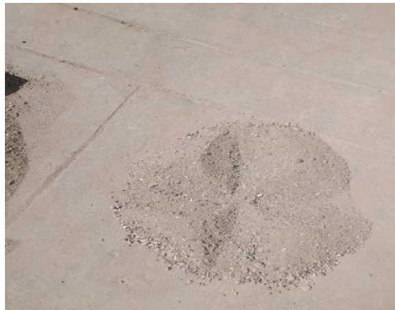
Figura 6. Proceso de cuarteo del Agregado Fino
