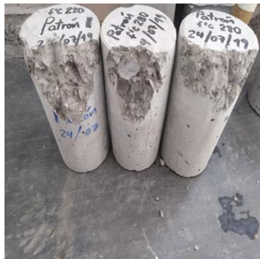
Figura 45. Especímenes de concreto ensayados
