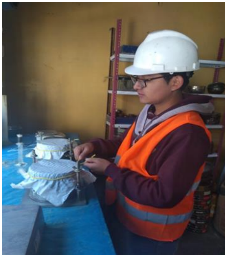
Figura 77. Cubriendo la mezcla con una capa impermeable
