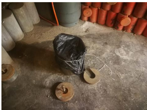
Figura 95. MUESTRA DE CONCRETO CON PEAD PARA ENSAYO DE EXUDACIÓN
