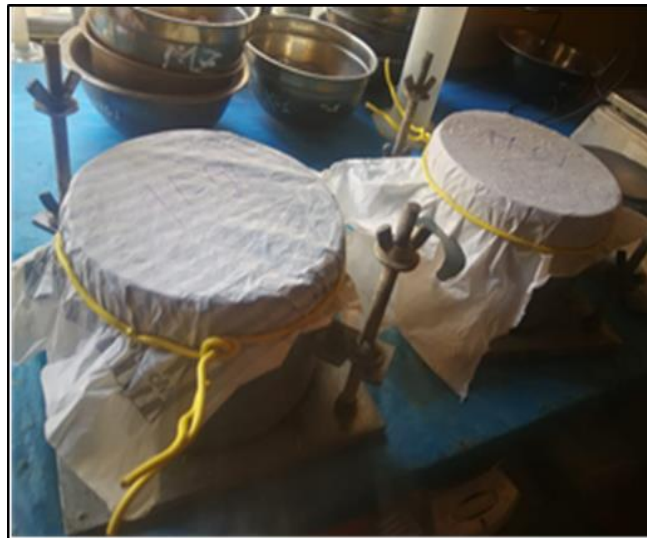
Fotografía 13. Ensayo del tiempo de fraguado.
