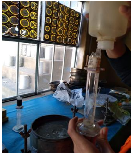
Figura 82. Vertiendo el agua extraída de la mezcla dentro de la probeta de 100 mL
