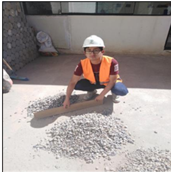
Fotografía 5. Caracterización del agregado grueso
