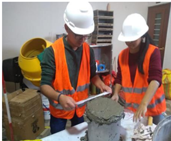
Figura 103. ENRASAMIENTO En la figura se observa el enrasado de la mezcla de concreto.
