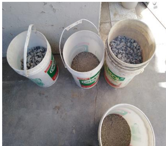
Figura 27. INSUMOS - ELABORACIÓN DEL CONCRETO SIN PEAD
