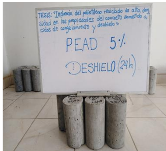
Figura 50. Probetas de concreto con 5 % de PEAD sometidos a Deshielo
