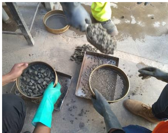
Figura 75. Tamizado de la mezcla por la malla N° 4 (se utiliza el pasante)
