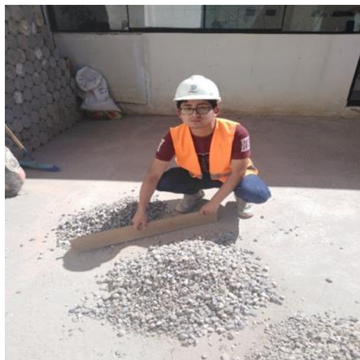
Figura 12. Cuarteo del Agregado Grueso
