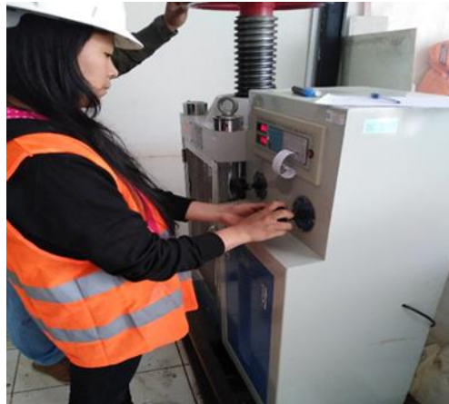
Figura 44. Control de la velocidad del Ensayo a Compresión del Concreto Patrón
