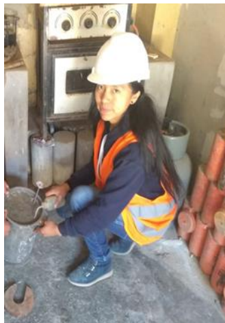
Figura 90. INCLINACIÓN DE MUESTRA DE CONCRETO SIN PEAD PARA RECOLECCIÓN DE AGUA DE EXUDACIÓN.
