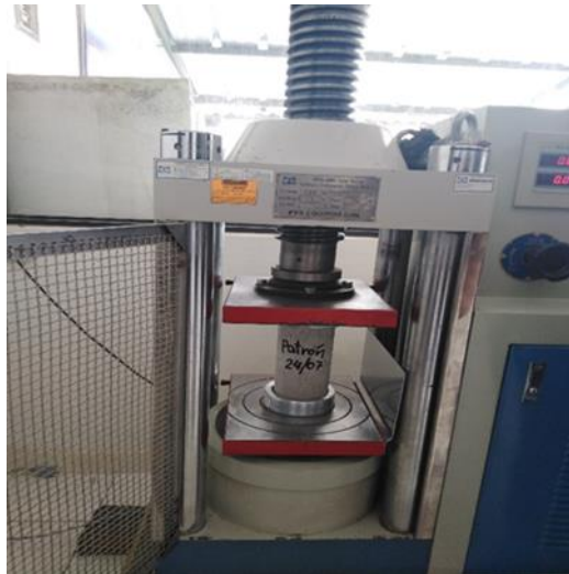
Figura 43. Ensayo de Compresión del Concreto Patrón (Sin adición del PEAD)
