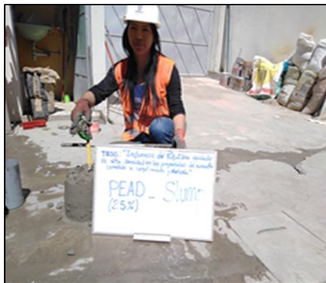
Fotografía 7. Ensayo de asentamiento de la mezcla
