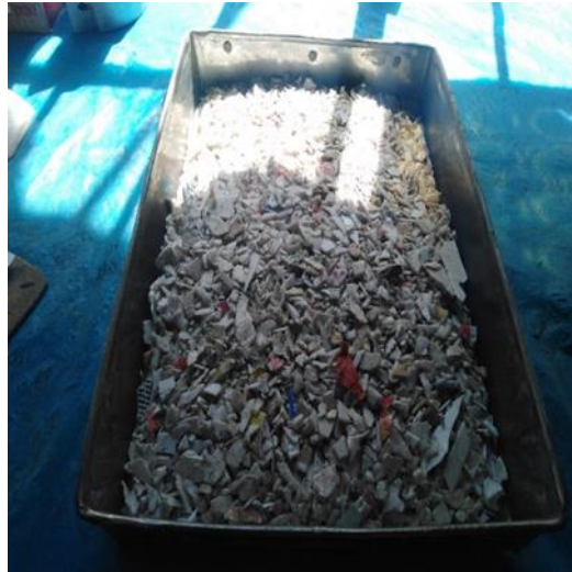
Figura 35. Fibras de Polietileno Reciclado de Alta Densidad (PEAD)
