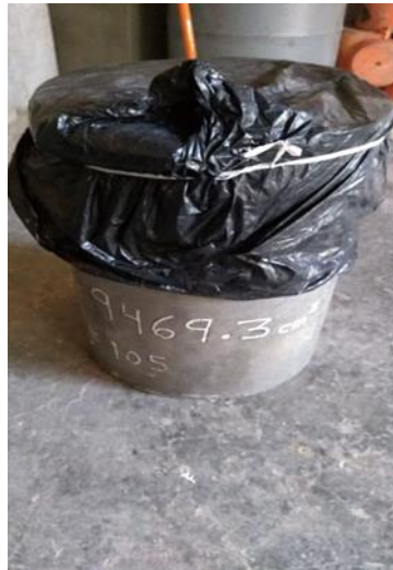
Figura 86. Cubriendo con una capa impermeable
