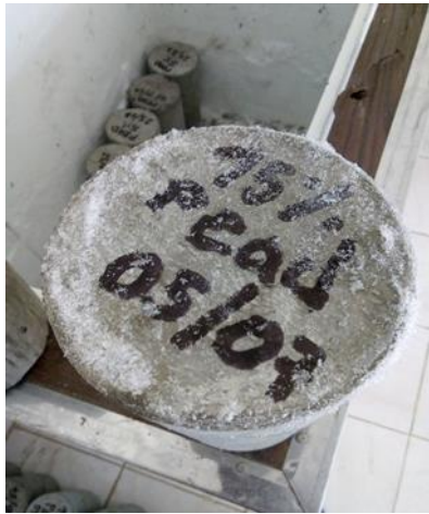
Figura 61. Hielo en la superficie del espécimen de concreto con 15% de PEAD
