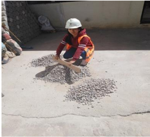
Figura 13. Cuarteo del Agregado Grueso
