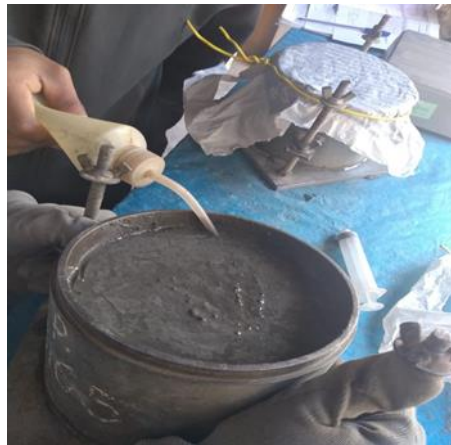
Figura 80. Retirando agua en intervalos de 30 min hasta que cese la exudación
