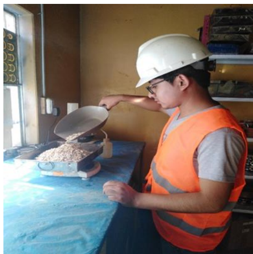
Figura 36. Peso de Polietileno Reciclado de Alta Densidad
