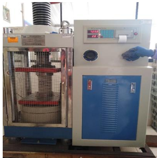
Figura 63. Ensayo a la compresión del espécimen de concreto con 15 % de PEAD
