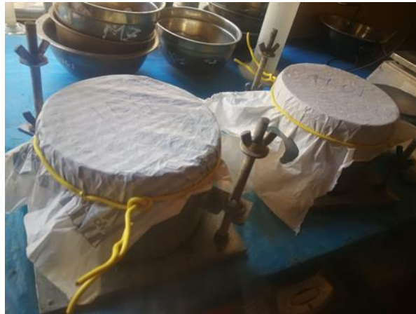
Figura 97. MUESTRA DE CONCRETO SIN PEAD PARA ENSAYO DE TIEMPO DE FRAGUA. En la figura se observa las muestras cubiertas con una capa impermeable.
