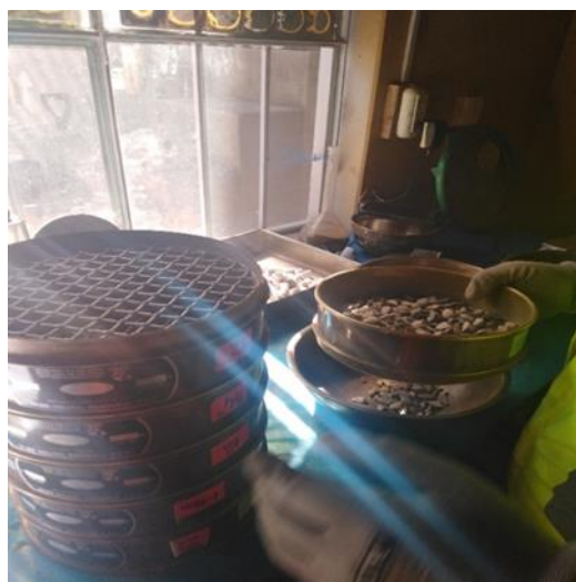
Figura 24. Proceso de tamizado de los agregados
