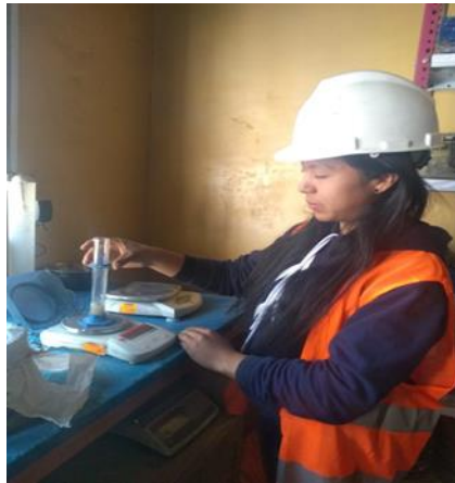
Figura 89. MEDICIÓN DE AGUA DE ENSAYO DE EXUDACIÓN Determinando la masa de recipiente metálico y su contenido
