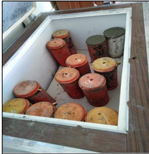
Fotografía 17. Probetas sometidas a congelamiento
