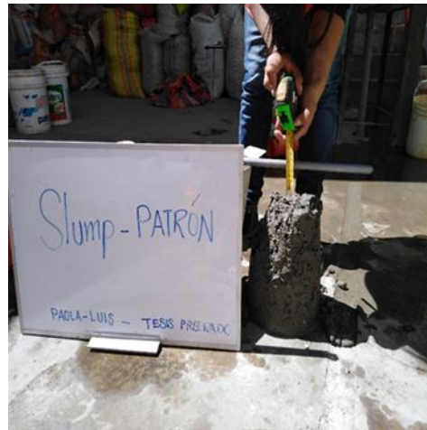
Figura 32. ENSAYO DE REVENIMIENTO CONCRETO SIN PEAD. En la figura se observa cómo se desarrolla el ensayo de revenimiento.
