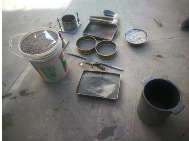
Figura 91. ENSAYO DE TIEMPO DE FRAGUA – GRUPO CONTROL (SIN ADICIÓN DE PEAD) En la figura se muestra los instrumentos para el ensayo de tiempo de fragua
