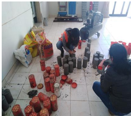
Figura 56. Desmolde de un grupo de especímenes de concreto
