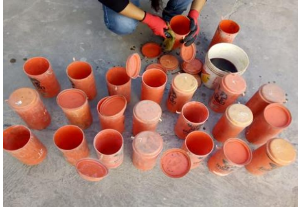
Figura 25. PREPARACIÓN DE LOS MOLDES DE 4X8" PARA LA ELABORACIÓN DE ESPECÍMENES
