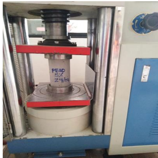
Figura 47. Ensayo a la Compresión de Concreto con 5% de PEAD
