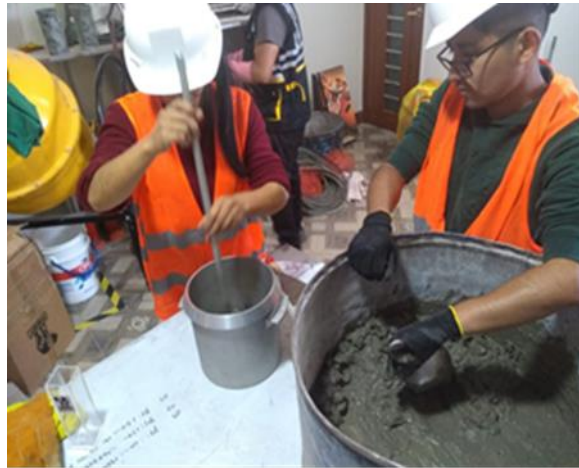
Figura 102. CHUSEO CADA TRES CAPAS DE LA MEZCLA DE CONCRETO En la figura se observa el chuseo con la varilla
