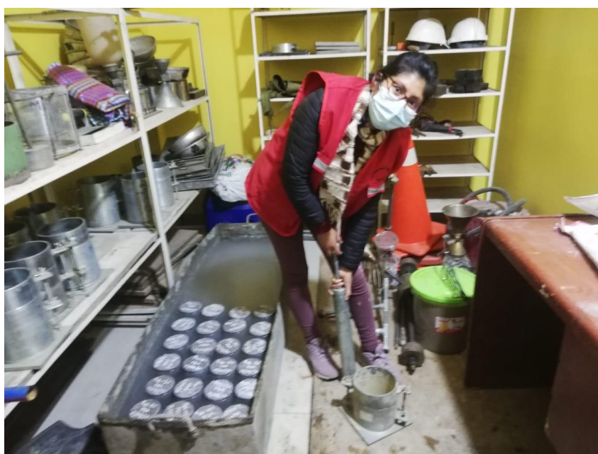
Figura 27. Primera capa de compactación en el ensayo de Proctor.
