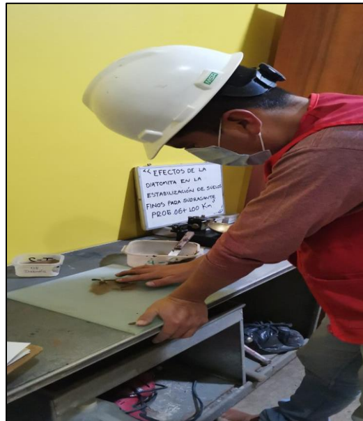
Figura 24. Ejecución del ensayo del límite plástico.
