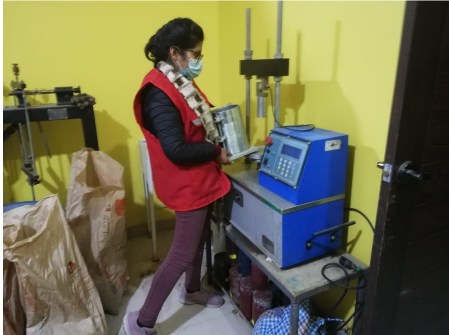
Figura 29. Preparación de la muestra para el ensayo de CBR.
