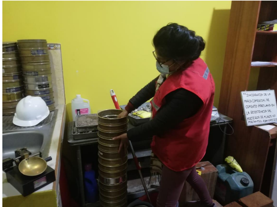
Figura 18. Proceso de tamizaje en laboratorio.
