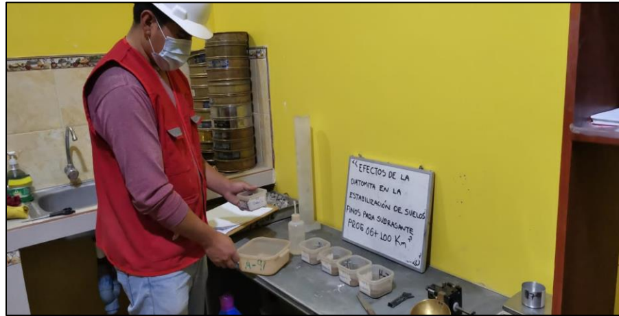
Figura 23. Preparación de muestras para determinar el límite plástico.
