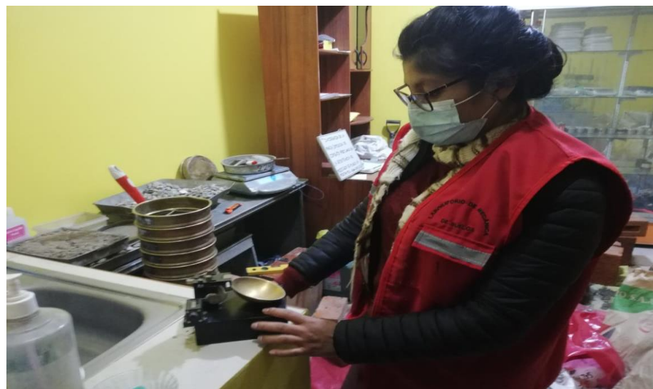
Figura 22. Preparación de la copa de Casagrande para la determinación del límite líquido.
