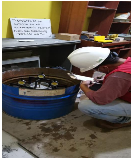
Figura 28. Medición de la expansión del suelo.
