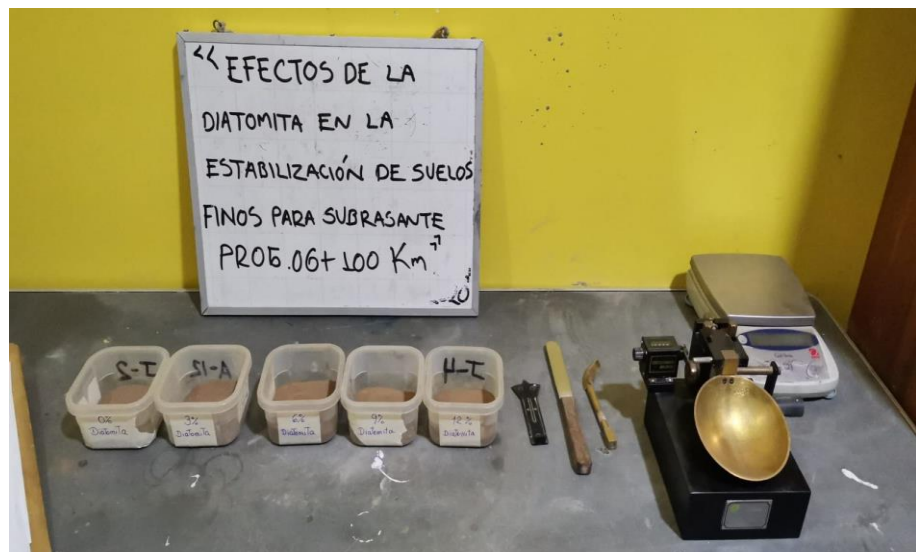
Figura 21. Vista de la muestra de suelo para la determinación del límite líquido.
