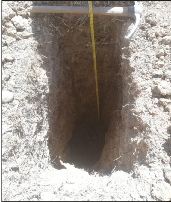
Figura 3. Calicata en la zona de estudio en la que observa la presencia del tipo de suelo fino.
