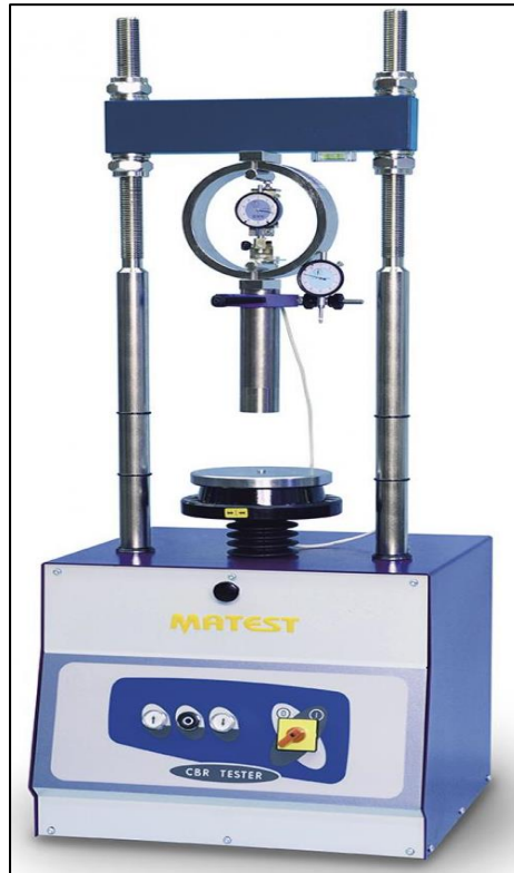
Figura 11. Máquina para determinar el CBR. Fuente: López y Ortiz (2018).
