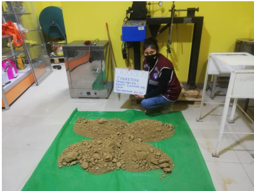
Figura 17. Cuarteo de la muestra de suelo recolectada en campo.
