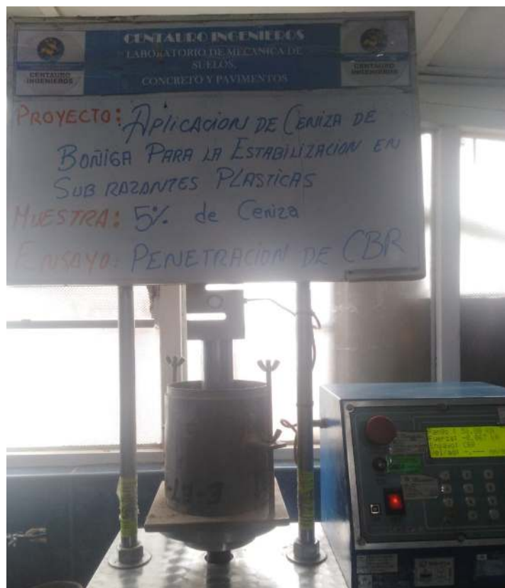
Figura 24. Ensayo de penetración de CBR Fuente: Elaboración propia.
