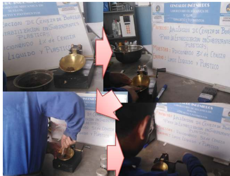
Figura 21. Ensayo de Límite Líquido Fuente: Elaboración Propia.
