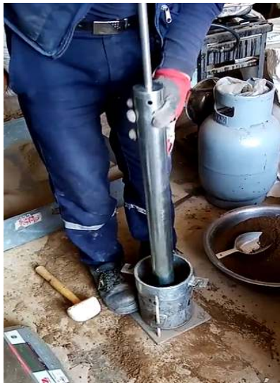
Figura 36. Ensayo de Proctor Modificado. Fuente: Elaboración Propia.
