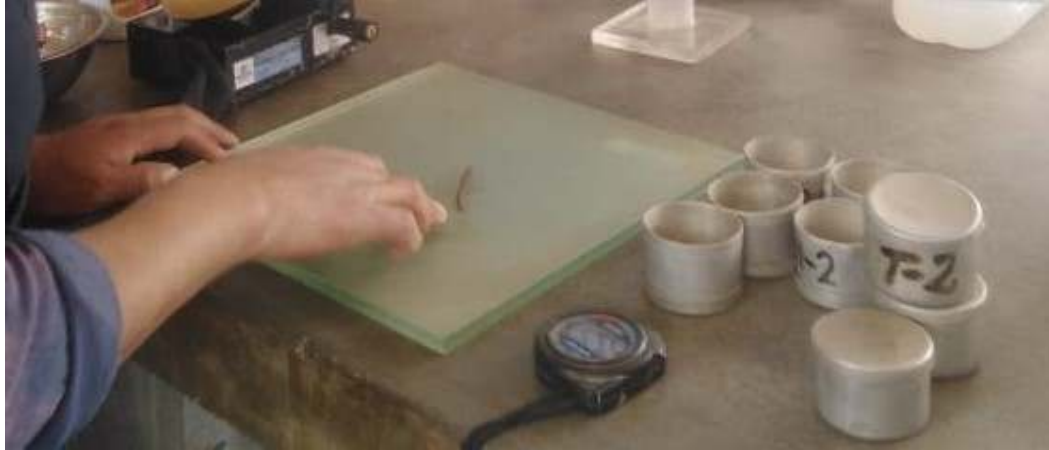
Figura 22. Ensayo del límite plástico Fuente: Elaboración Propia.
