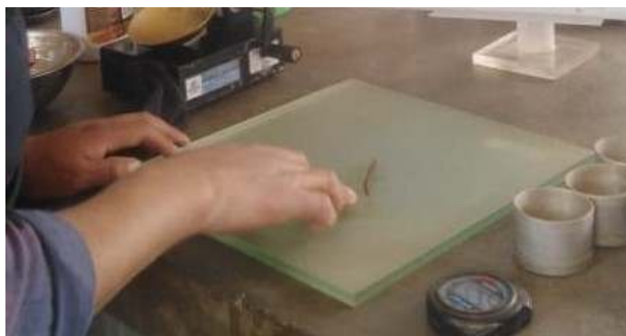
Figura 14. Formando los Cilindros para la plasticidad. Fuente: Elaboración Propia.
