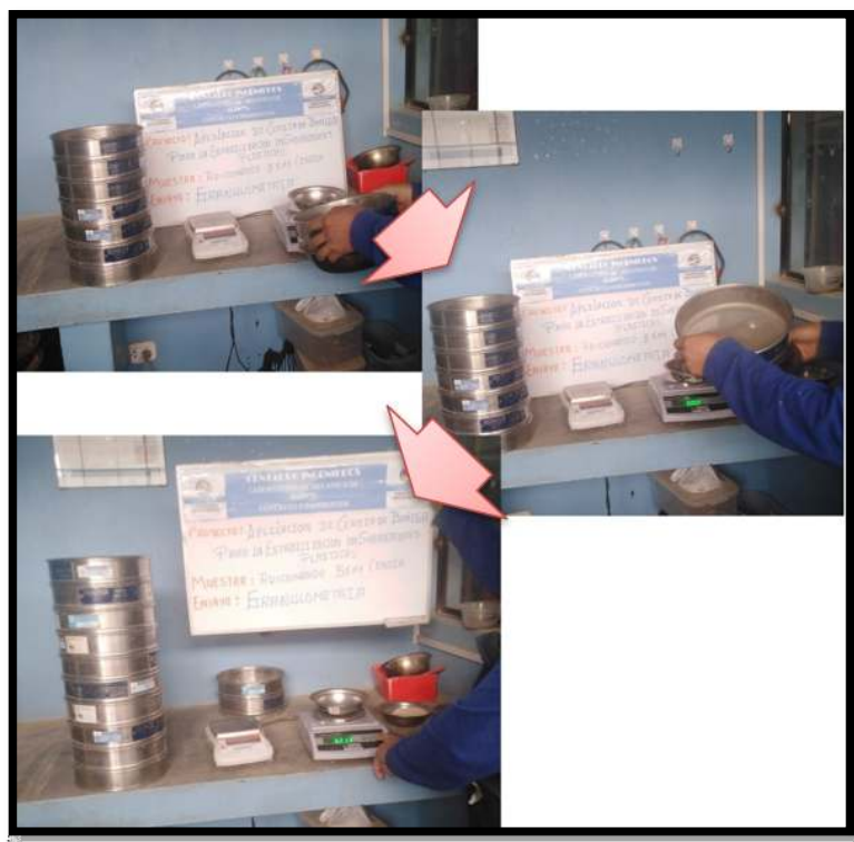
Figura 20. Ensayo de Análisis granulométrico Fuente: Elaboración propia.
