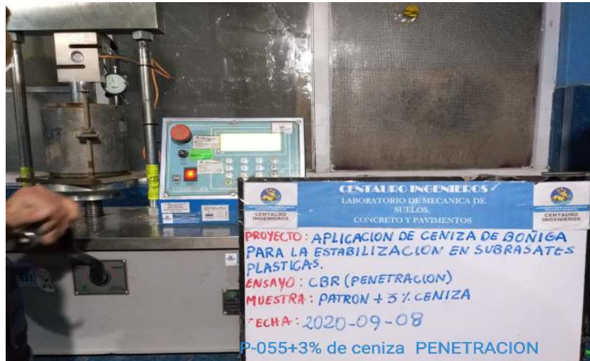
Figura 37. Ensayo de penetración para CBR a la MP + 3% de CB Fuente: Elaboración propia.
