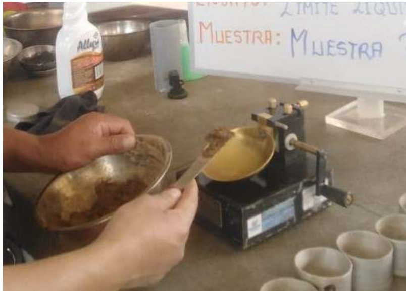
Figura 12. Dispositivo de Límite Líquido Fuente: Elaboración propia.
