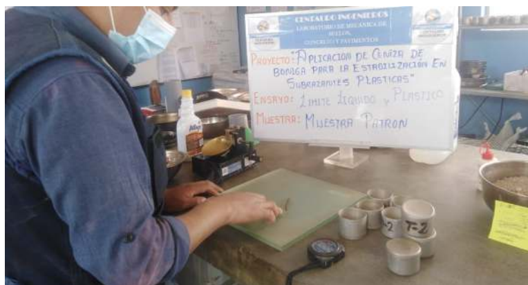
Figura 34. Enrollando a 3.2 mm. Fuente: Elaboración propia.
