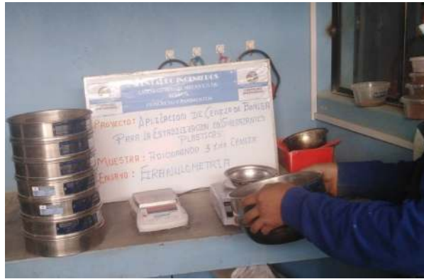
Figura 31. Realizando el tamizado respectivo de la MP y 3% de CB. Fuente: Elaboración Propia.
