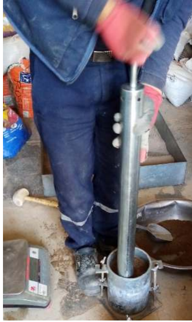
Figura 23. Ensayo de Proctor modificado Fuente: Elaboración propia.
