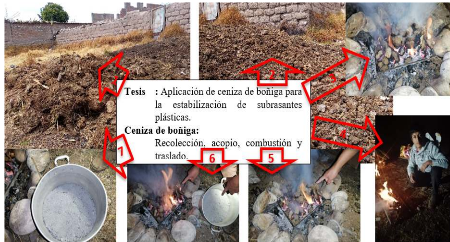
Figura 29. Acopio, Combustión y obtención de CB Fuente: Elaboración Propia
