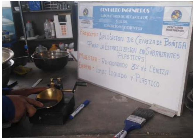
Figura 33. Colocación, ranurado y Aplicación de los golpes con el manubrio a la muestra colocada en la copa de Casagrande. Fuente: Elaboración propia.
