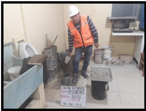
Foto N° 15 Determinando el peso Volumétrico del Agregado grueso
