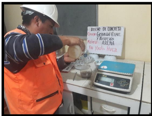
Foto N° 11 Llenado de agua el borde del Picnómetro
