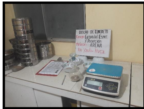
Foto N° 10 Peso del Picnómetro agregado Fino
