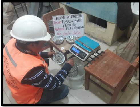
Foto N° 07 Ensayo Gravedad Especifica Y absorción de agregado grueso
