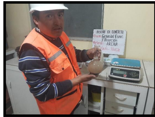
Foto N° 12 Eliminación del aire atrapado del picnómetro.
