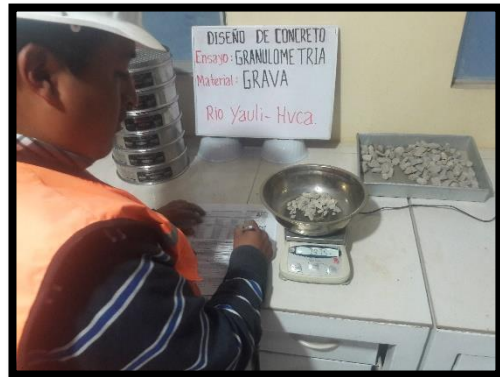
Foto N° 06 Peso de la muestra del agregado Grueso
