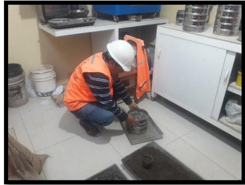
Foto N° 02 realizando la granulometría agregado Fino
