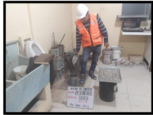
Foto N° 16 Determinando el peso volumétrico del agregado grueso
