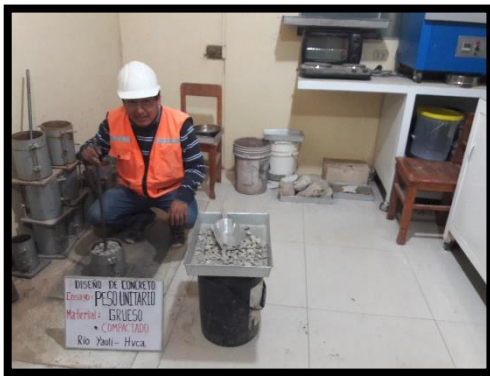
Foto N° 17 Determinando el peso compactado Volumétrico del Agregado grueso
