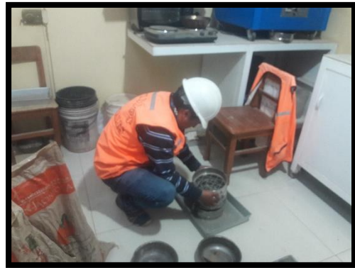
Foto N° 04 Realizando la granulometría agregado Grueso
