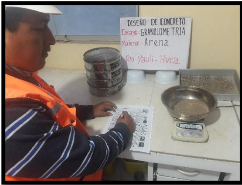
Foto N° 03 Peso de la muestra del Agregado fino
