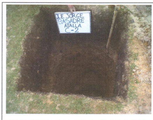
FOTO 06.- C-2, PERFIL ESTRATIGRAFICO DEL TERRENO, SE APRECIA EL TEERENO ORGANICO (TURBA HASTA 1.20 mts), DE 1.20 A2.80 ARCILLAS INORGANICAS.
