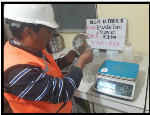
Foto N° 09 Colocado del agregado en Picnómetro (fino)
