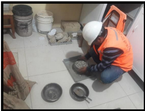
Foto N° 05 Realizando la granulometría Agregado grueso
