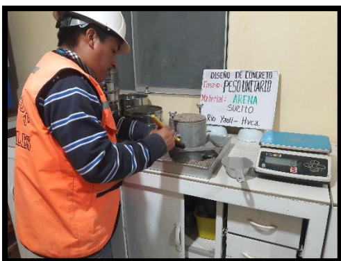
Foto N° 23 peso del agregado fino
