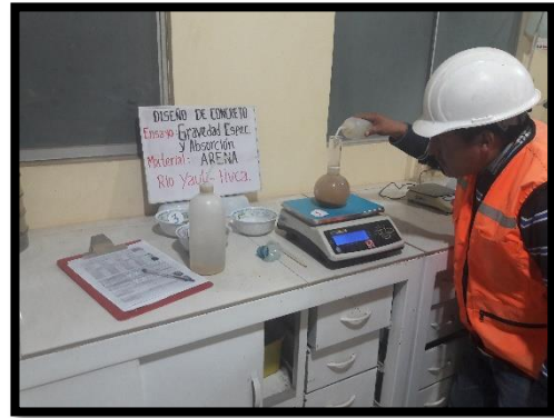
Foto N° 14 Peso del agua dentro del Picnómetro
