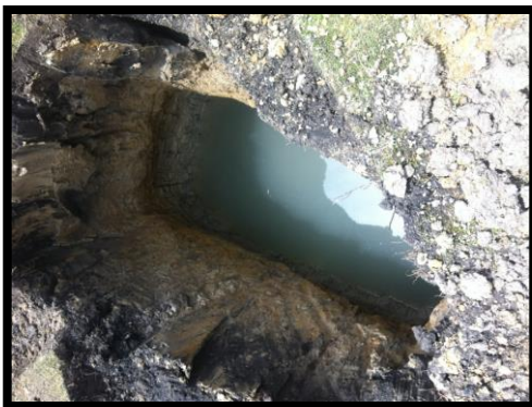
Foto N° 05 calicata 02 presencia de Nivel freático
