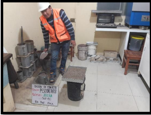
Foto N° 19 Determinando el peso Volumétrico del Agregado fino
