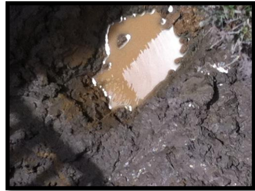
Foto N° 04 realizando las calicatas 01 se encontró nivel freático en 0.80mts.
