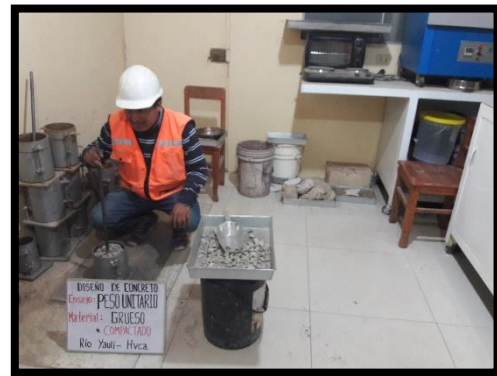
Foto N° 18 Determinando el peso volumétrico del agregado grueso compactado
