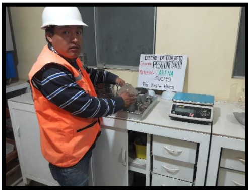
Foto N° 21 Enrasando del material fino
