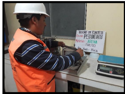
Foto N° 20 Determinando el peso volumétrico del agregado fino
