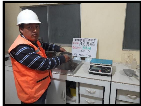
Foto N° 20 Determinando el peso volumétrico del agregado fino
