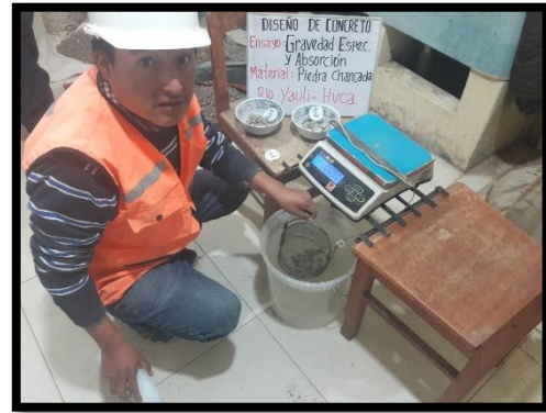
Foto N° 08 Ensayo Gravedad Especifica Y absorción de agregado grueso
