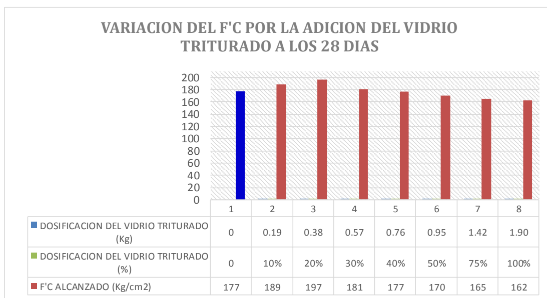
Grafico N° 10. Variación del F'c por la Adición del Vidrio Triturado Tipo Sodo Cálcico a los 28 días.
