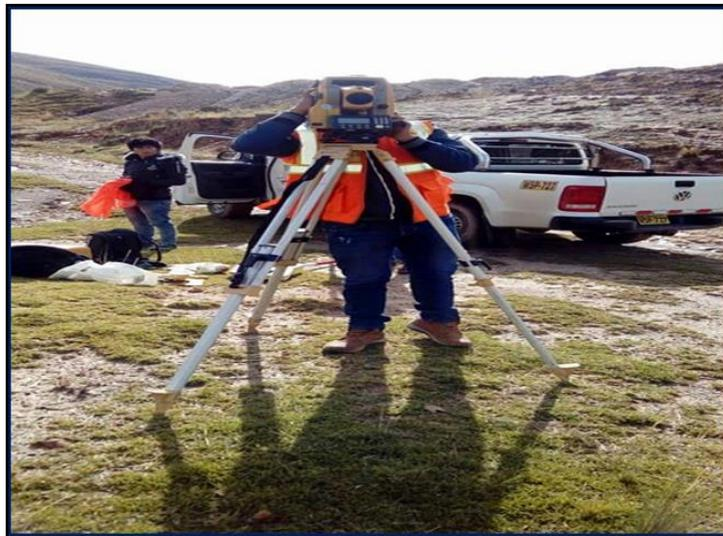
*Fotografía 5.- Estacionando el equipo topográfico en el BM correspondiente para realizar el levantamiento Topográfico.*
