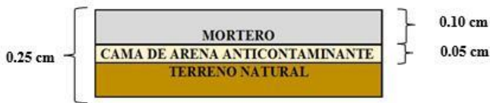
FIGURA 7: CAPAS DE VEREDA DE MORTERO RÍGIDO
