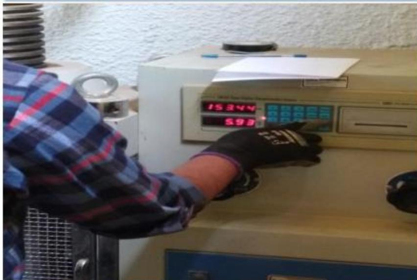
Foto N°36: Vista programación de equipo de rotura – Fc'
