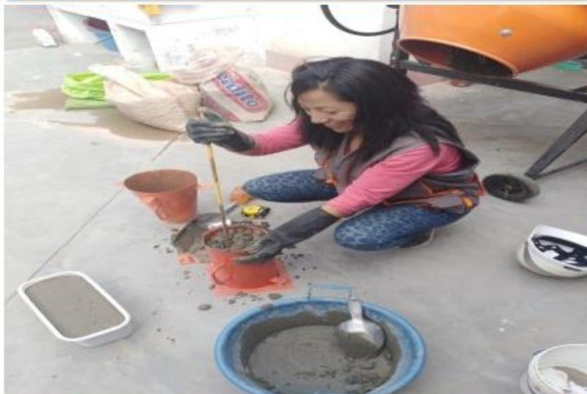
Foto N°26: Vista de chuceado de mezcla dentro del molde - Densidad
