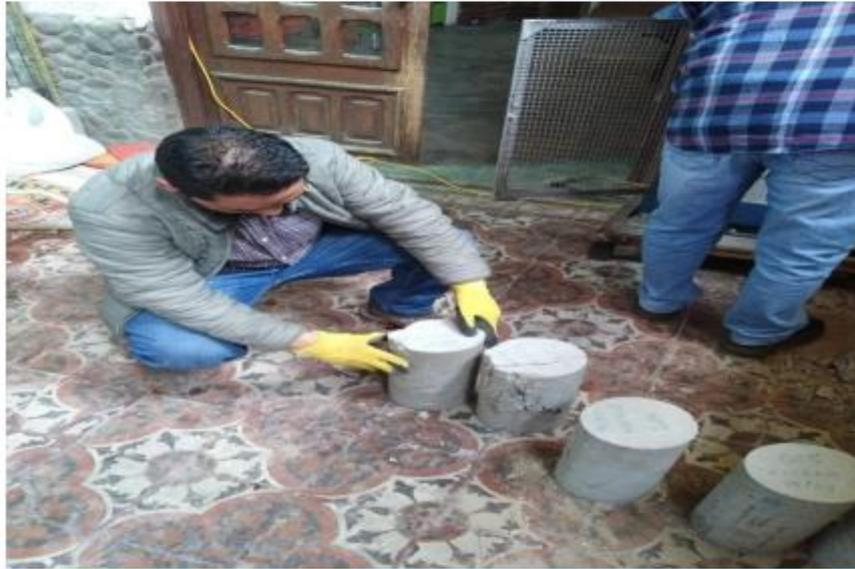
Foto N°39: Vista de espécimen fallados por compresión – Fc'
