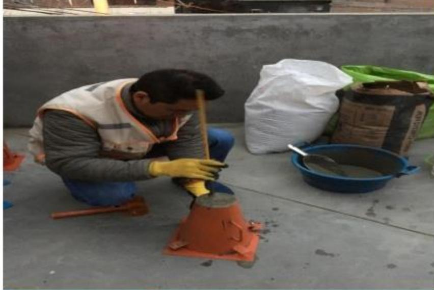
Foto N°19: Vista de chuceado de mezcla - Asentamiento
