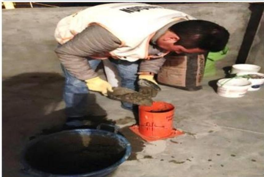
Foto N°32: Vista de llenado de mezcla en molde cilíndrico – Fe'
