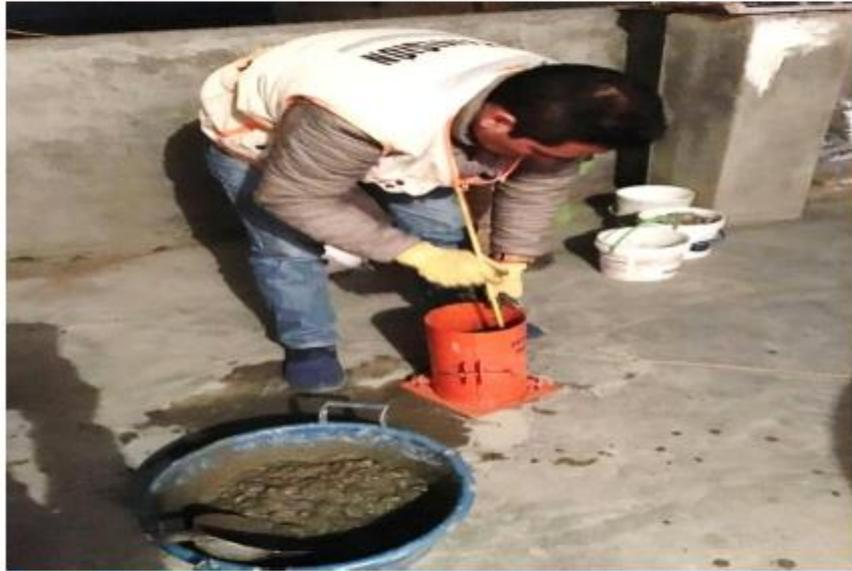
Foto N°33: Vista de chuceado de mezcla - Fc'
