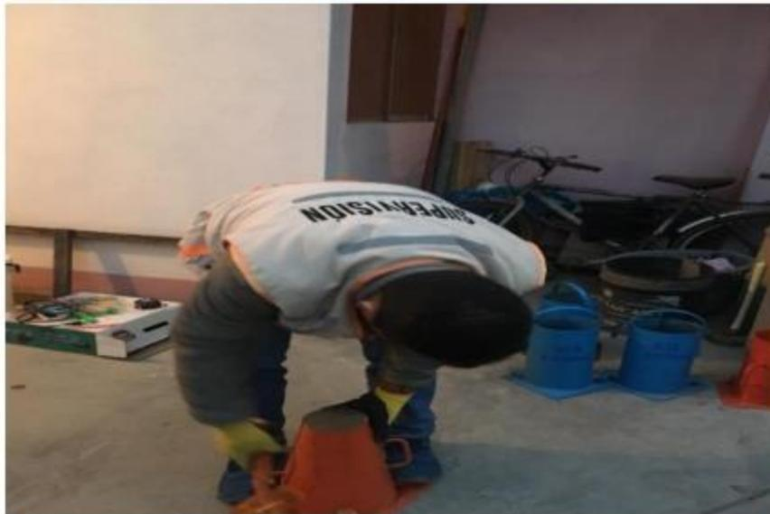
Foto N°18 Vista de procedimiento de goldeo de molde - Asentamiento
