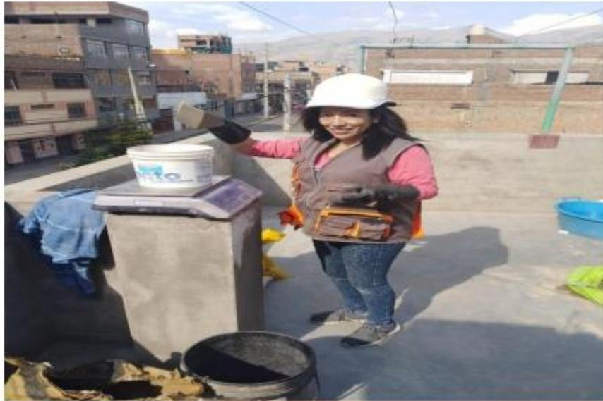
Foto N°09: Vista de control de peso del recipiente vacío
