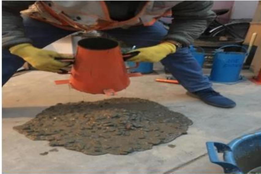
Foto N°21: Vista de mezcla muy fluido - Asentamiento
