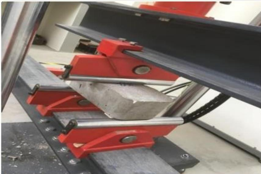
Foto N°48: Vista de la operación de la maquina para la rotura del espécimen - MR
