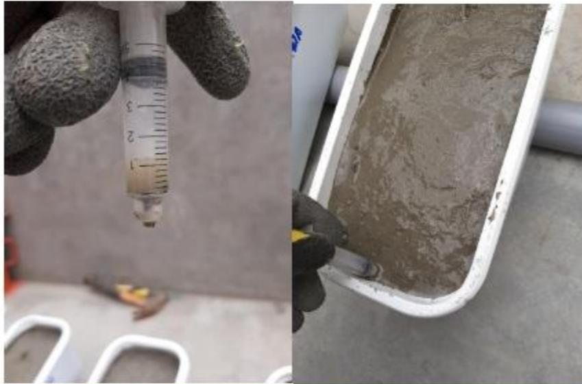
Foto N°23: Vista de separación de agua de la mezcla - Exudación
