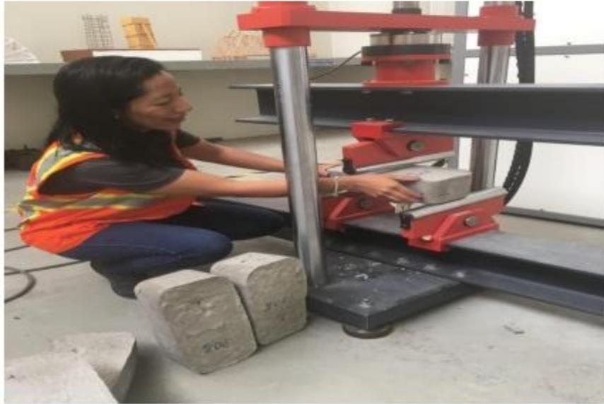
Foto N°47: Vista de la colocación del espécimen para la rotura - MR
