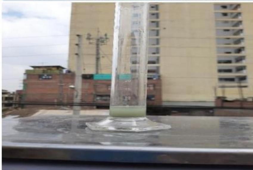
Foto N°24: Vista de control de agua de la mezcla - Exudación
