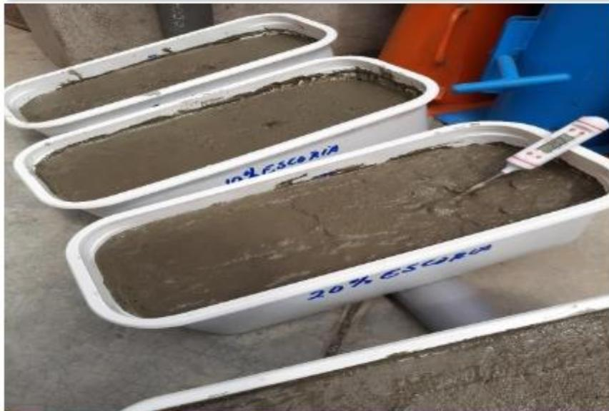
Foto N°30: Vista de control de temperatura al 20% de esc. - Temperatura
