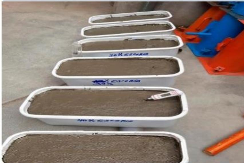
Foto N°44: Vista de probetas rectangulares llenos de mezcla - MR
