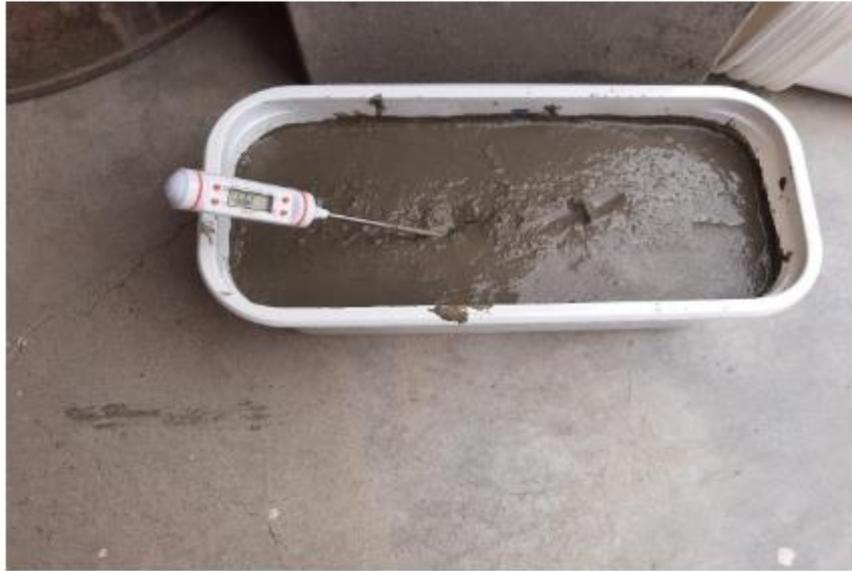
Foto N°29: Vista de control de temperatura al 30% de esc. - Temperatura
