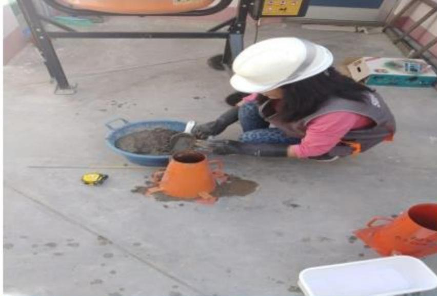
Foto N°17: Vista de procedimiento de llenado de molde - Asentamiento
