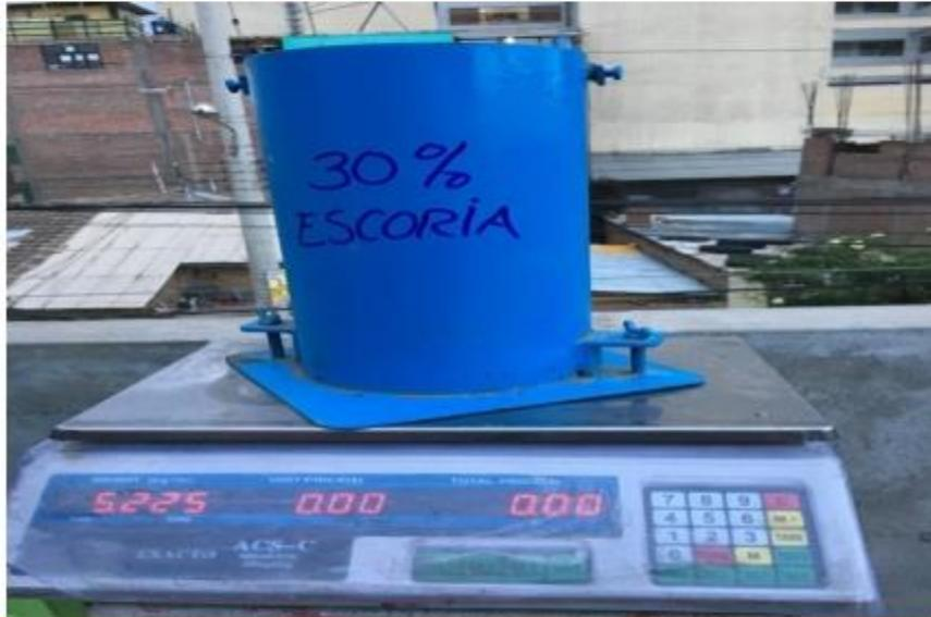
Foto N°25: Vista de control de peso de molde vacío - Densidad
