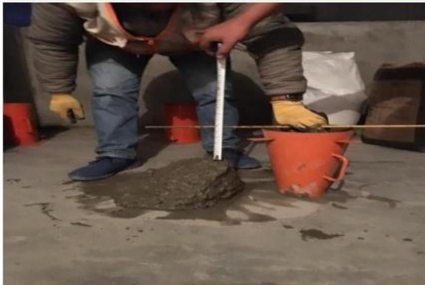
Foto N°22: Vista de toma de medida de mezcla fluido - Asentamiento
