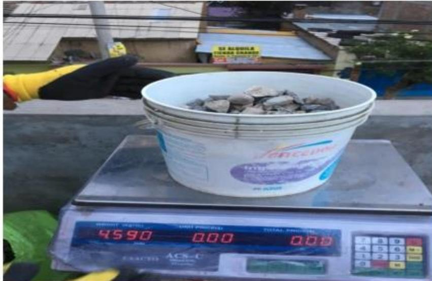
Foto N°11: Vista de control de peso de agregado grueso dosificado
