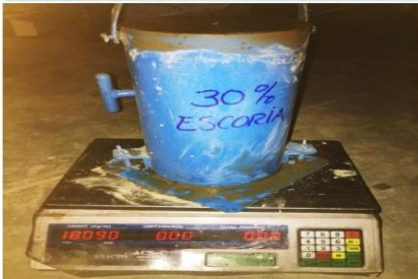
Foto N°28: Vista de control de peso de mezcla de espécimen 30% esc. - Densidad
