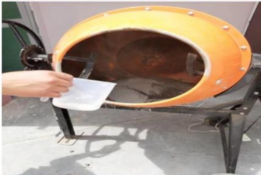
Foto N°14: Vista de adición de agua en la mezcladora
