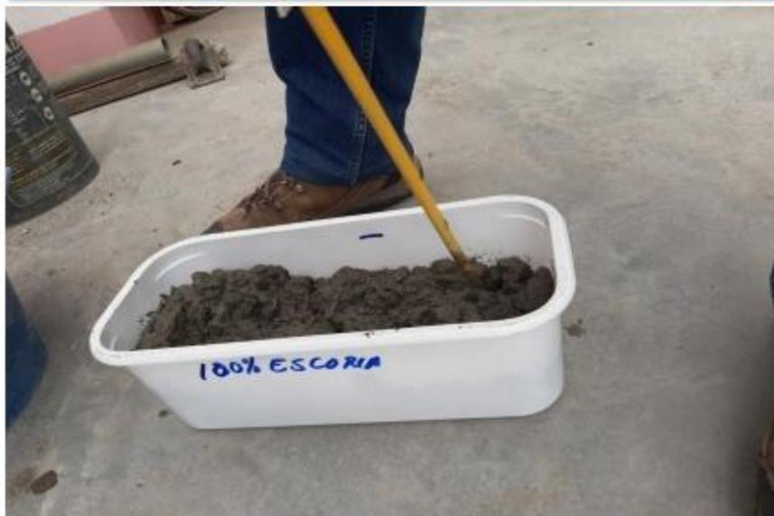
Foto N°42: Vista chuceado de mezcla en molde rectangular - MR
