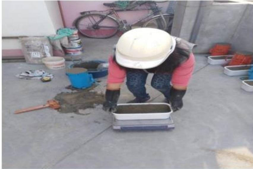
Foto N°43: Vista de control de peso de mezcla en moldrectangular - MR
