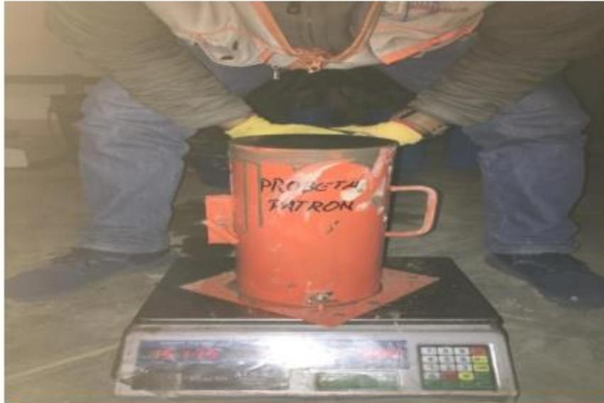
Foto N°27: Vista de control de peso de mezcla de espécimen patron - Densidad
