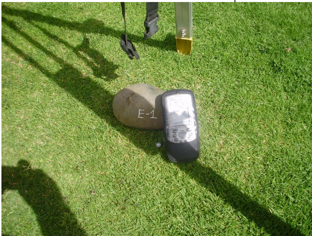
Foto 2. Toma de datos de las coordenadas UTM del GPS en el punto de control E-1
