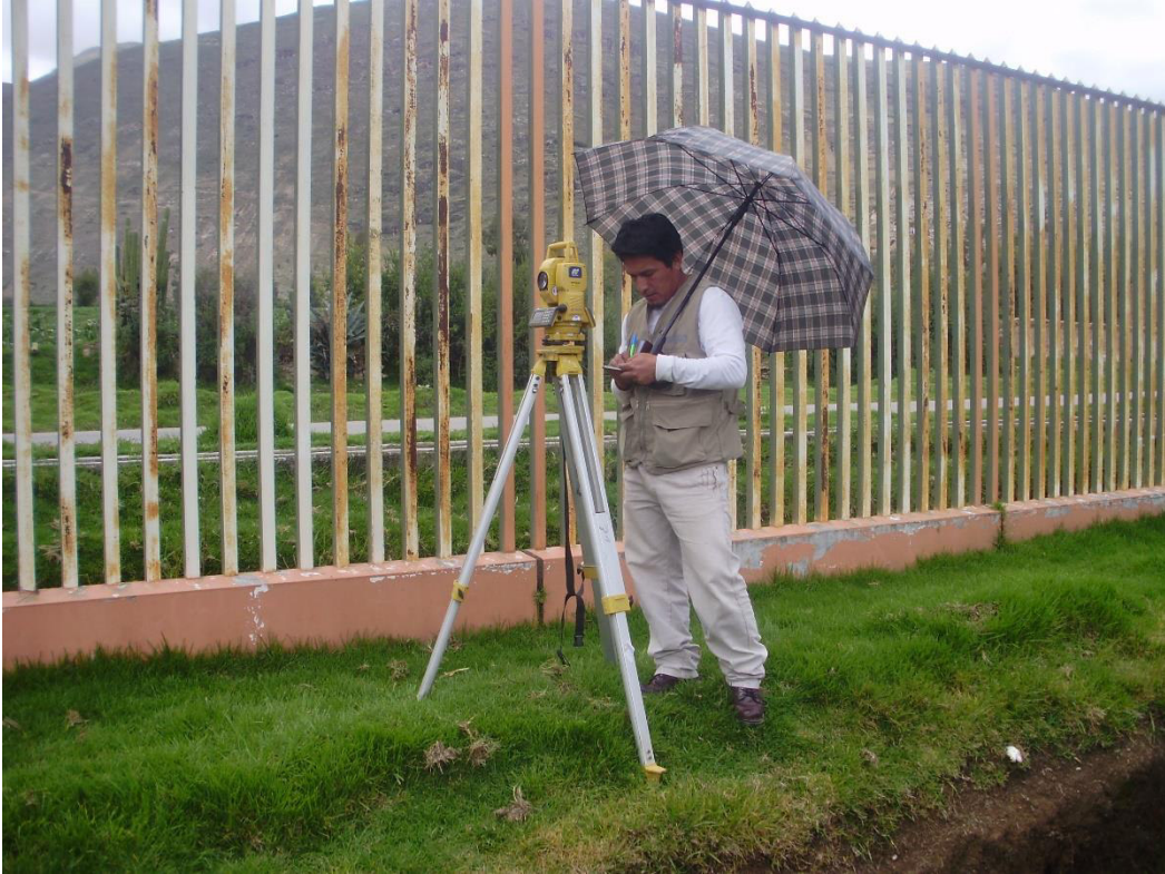
Foto 6. Toma de datos de la estación total para corroborar en el punto de cambio.
