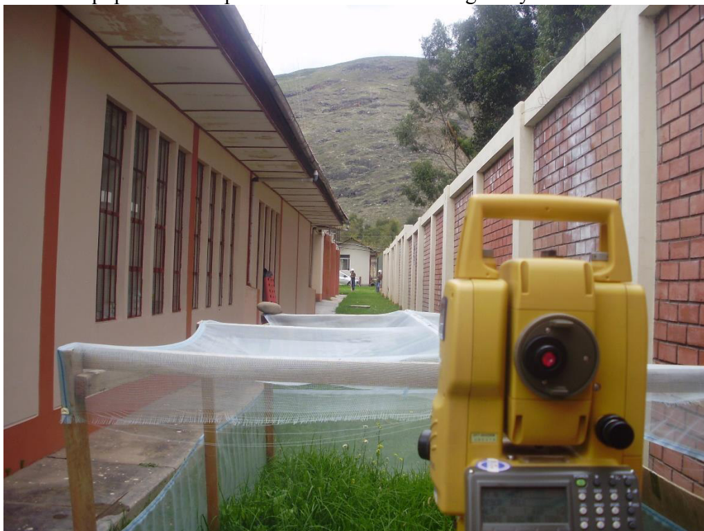
Foto 8. Equipo utilizado para la toma de datos de ángulos y distancias.
