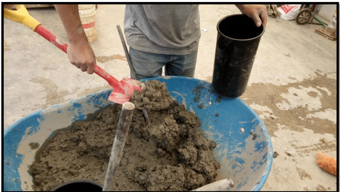
Sacando muestras para las probetas del concreto
