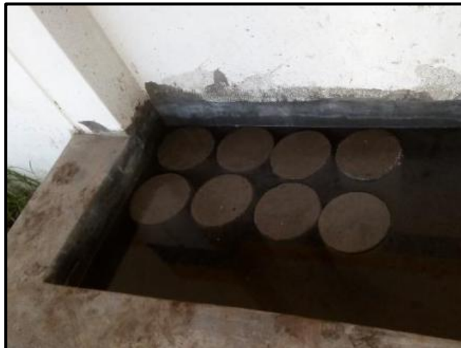
Fotografía 17. Probetas en curado
