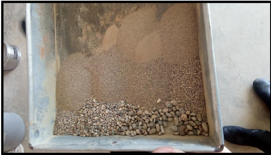
Tamizado del agregado
