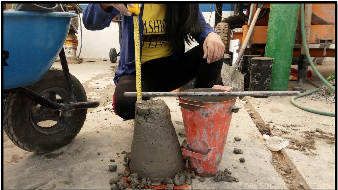
Midiendo el slump del concreto en estado fresco
