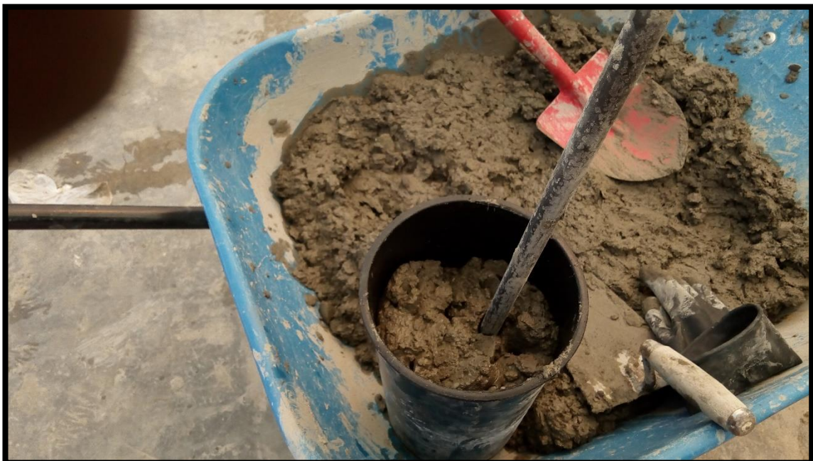
Sacando muestras para las probetas del concreto
