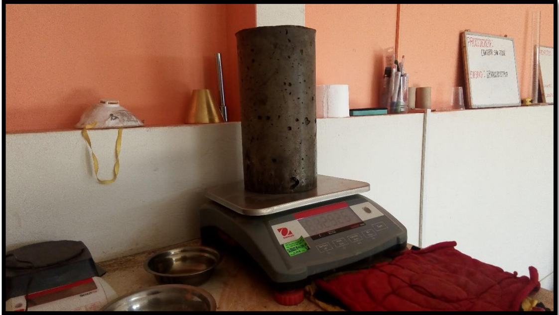
Peso de las probetas para su rotura
