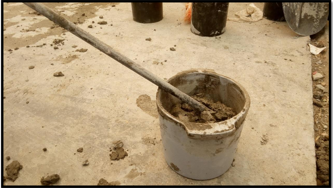
Muestras para el peso unitario del concreto
