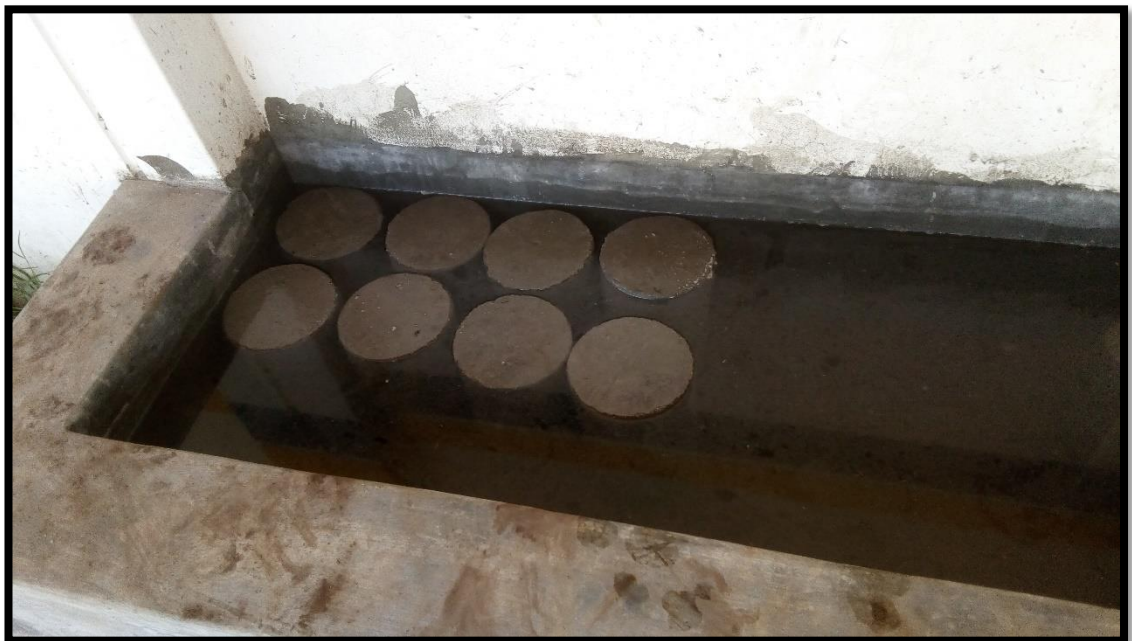
Curado de probetas
