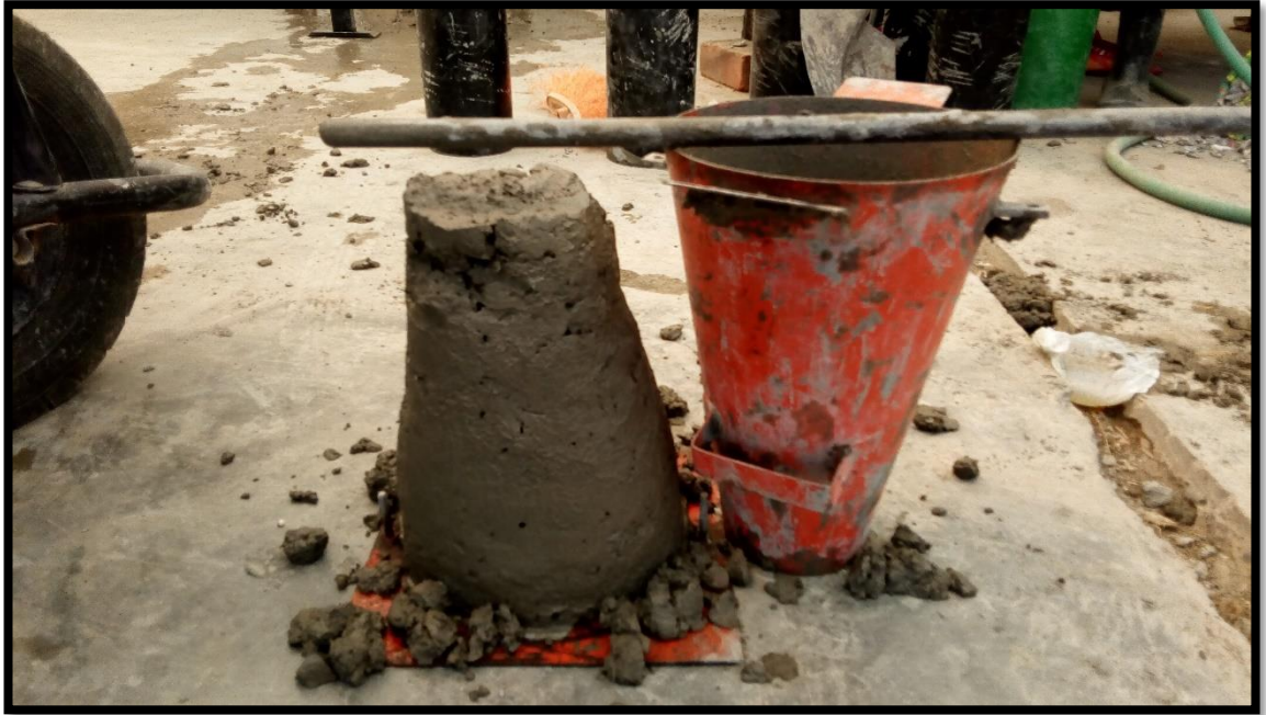
Midiendo el slum del concreto en estado fresco
