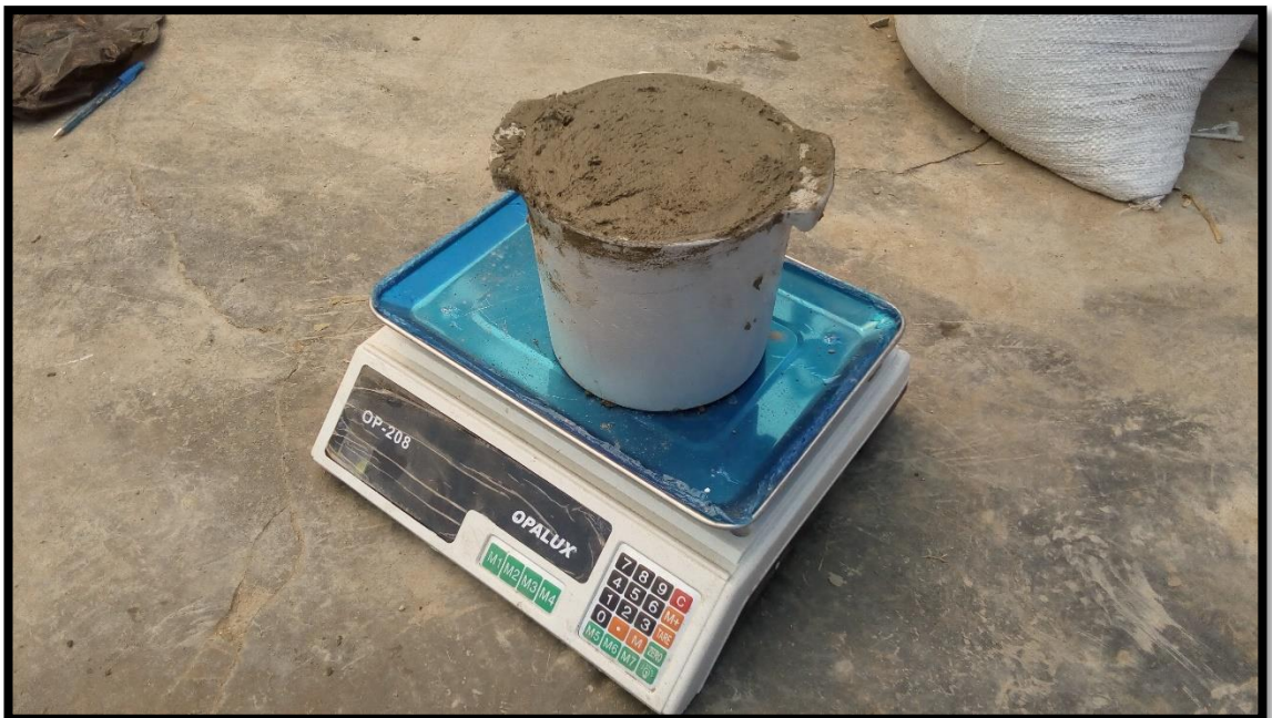
Muestras para el peso unitario del concreto
