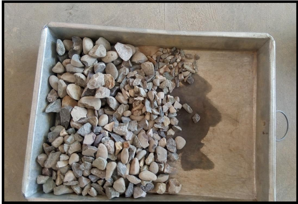
Tamizado del agregado
