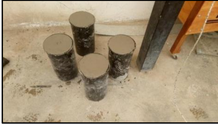
Fotografía 15. Probetas elaboradas para control a la compresión
