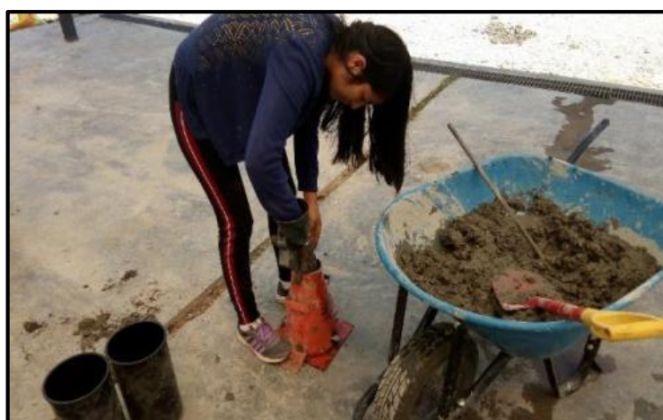
Fotografía 10. Preparación de la mezcla para control de la trabajabilidad
