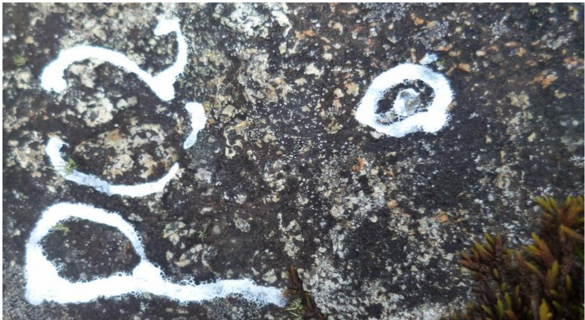
Fotografía N°8: Marcamos los puntos de cambio de estación en cada tramo del levantamiento.
