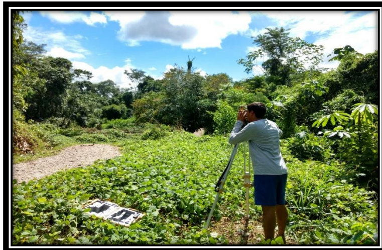
Figura 18- Medición de ángulos horizontales y verticales.
