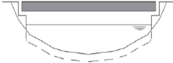
Figura 11- Erosión durante avenidas.
