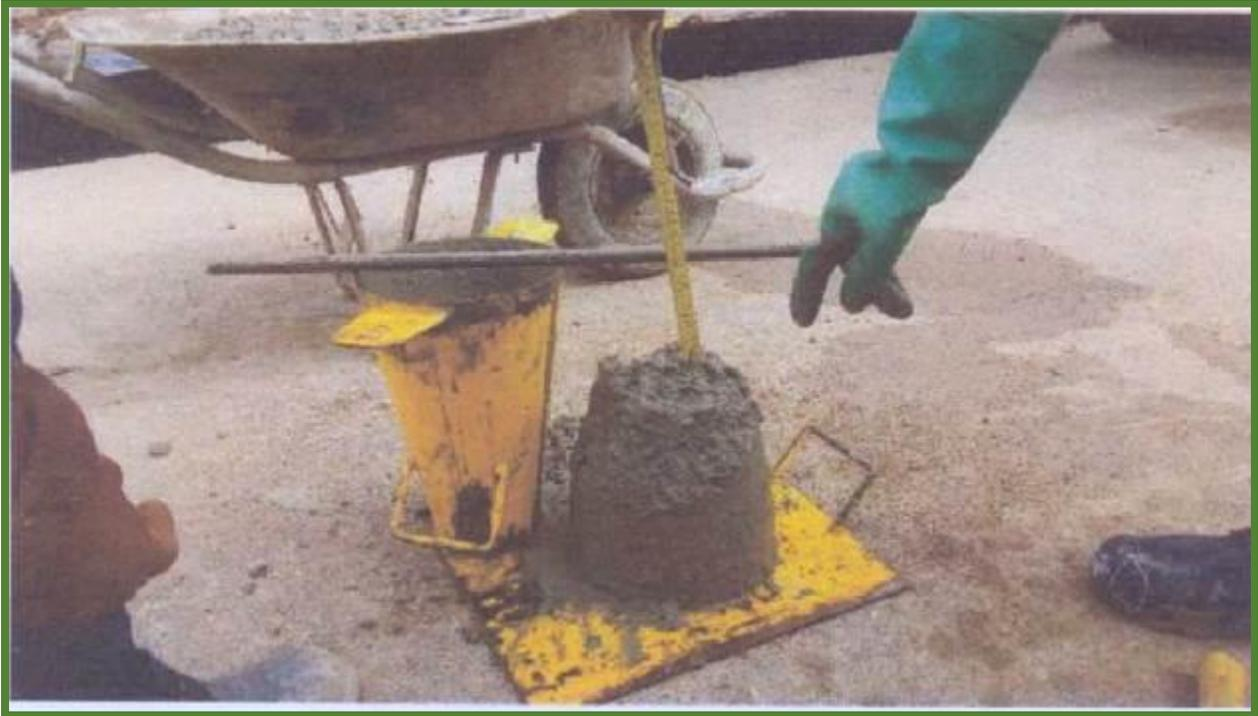
**XXVII. PREPARACION DE PROBETAS DEL CONCRETO PREMEZCLADO**
