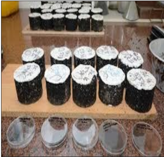
VISTAS FOTOGRAFICAS DE LAS BRIQUETAS ENSAYADAS DEL DISEÑO DE MEZCLA ASFALTICA POR EL METODO MARSHALL. EN EL LABORATORIO DE LA DIRECCION REGIONAL DE TRANSPORTES Y COMUNICACIONES
