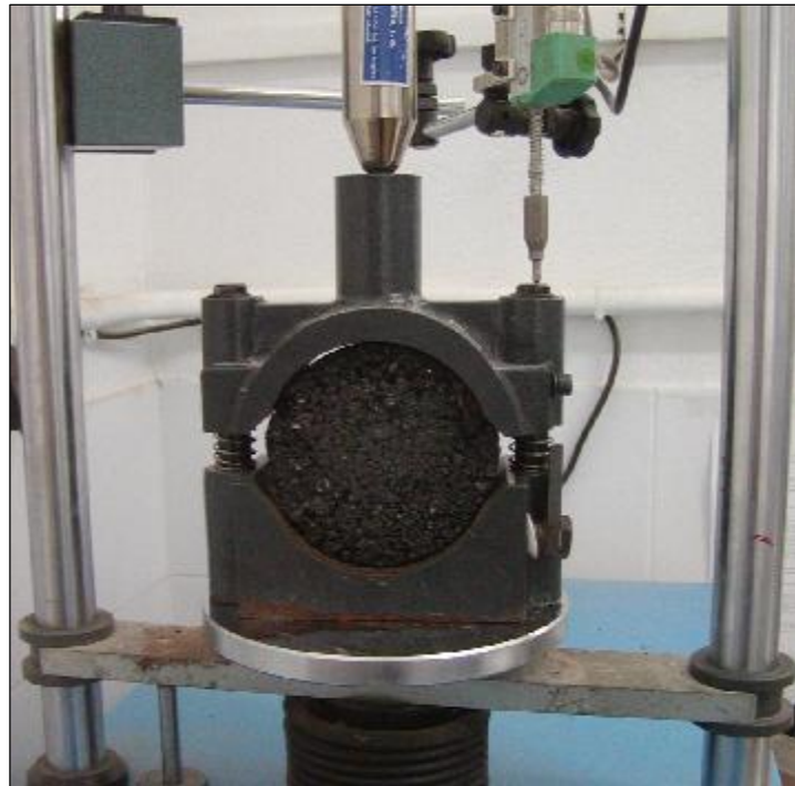
EQUIPO MARSHALL EJECUTANDO EL ENSAYO CON LAS BRIQUETAS DE LA MEZCLA REALIZADA CON MATERIAL RECICLADO DE PAVIMENTOS FLEXIBLE ENVEJECIDO.
