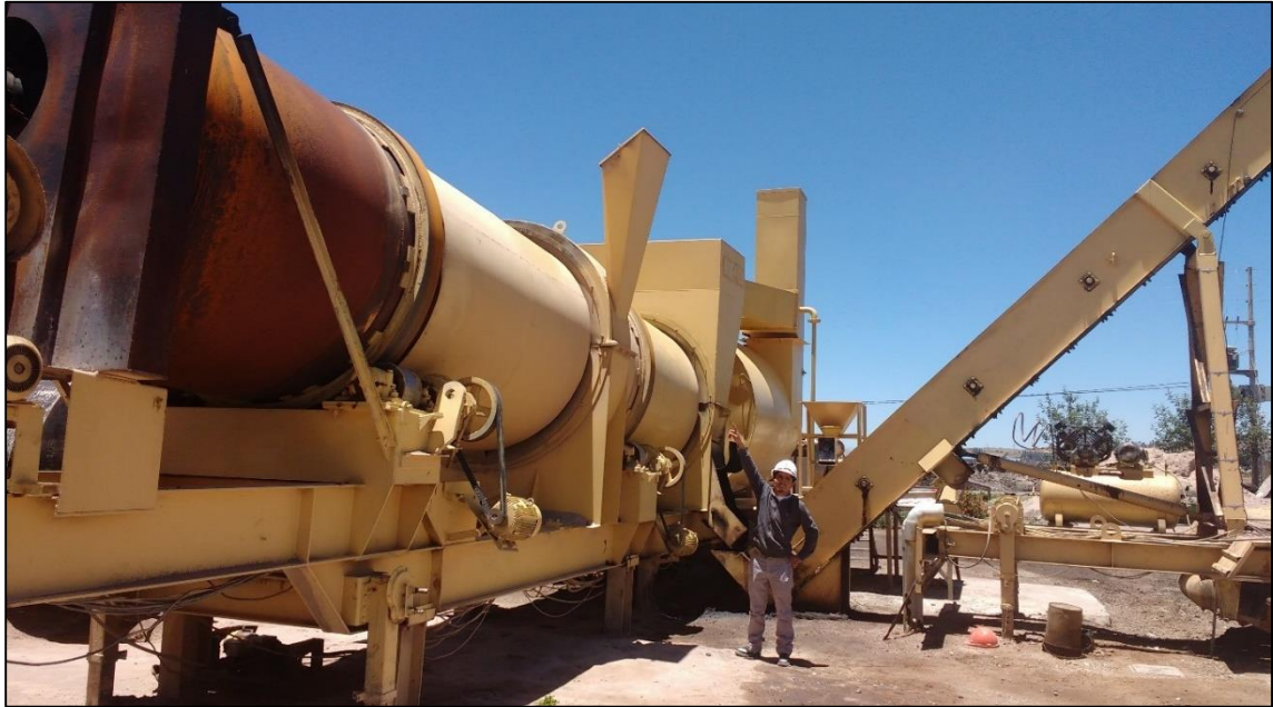
VISTAS FOTOGRÁFICAS DEL PROCESAMIENTO DE LA MEZCLA ASFÁLTICA EN CALIENTE CON EL EMPLEO DE MATERIAL RECICLADO DE PAVIMENTOS FLEXIBLES ENVEJECIDOS EN LA PLANTA DE ASFALTO DE LA DIRECCIÓN REGIONAL DE TRANSPORTES Y COMUNICACIONES.
