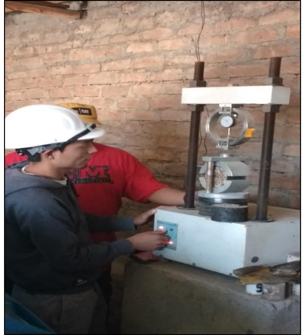
VISTAS FOTOGRAFICAS, EL BACH. JORGE MANUEL CHUMAN AGUIRRE, EJECUTANDO LA RUPTURA DE LAS BRIQUETAS EN LA PRENSA MARSHALL, PARA DETERMINAR LA ESTABILIDAD Y EL FLUJO. EN EL LABORATORIO DE LA DIRECCION REGIONAL DE TRANSPORTES – EN PLANTA SAN JERONIMO DE TUNAN.
