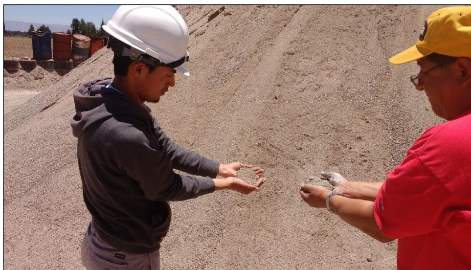
EL AUTOR EN VERIFICACION DE LOS AGREGADOS RECICLADOS PROCESADOS EN LA PLANTA CHANCADORA DE LA DRTC JUNIN
