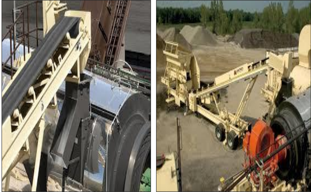
COMPONENTE MECANICO DE RECEPCION DE MATERIAL PARA EL PROCESAMIENTO DEL MATERIAL RECICLADO DE PAVIMENTO ENVEJECIDO EN LA PLANTA DE ASFALTO DE LA DIRECCION REGIONAL DE TRANSPORTES Y COMUNICACIONES JUNIN.
