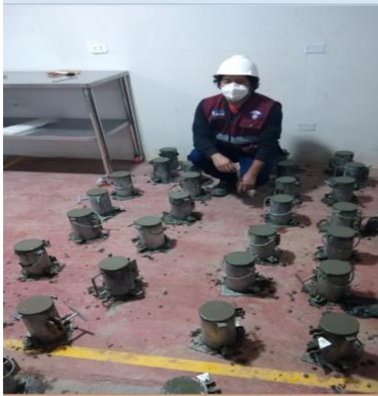
Vaciado de las probetas
