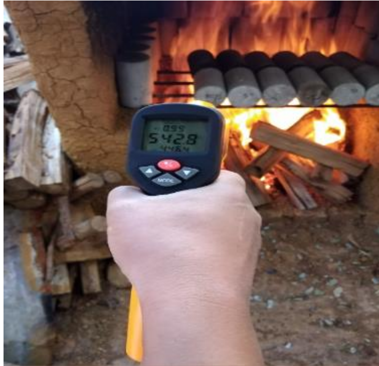
Probetas expuestas al fuego a los 500 °C.
