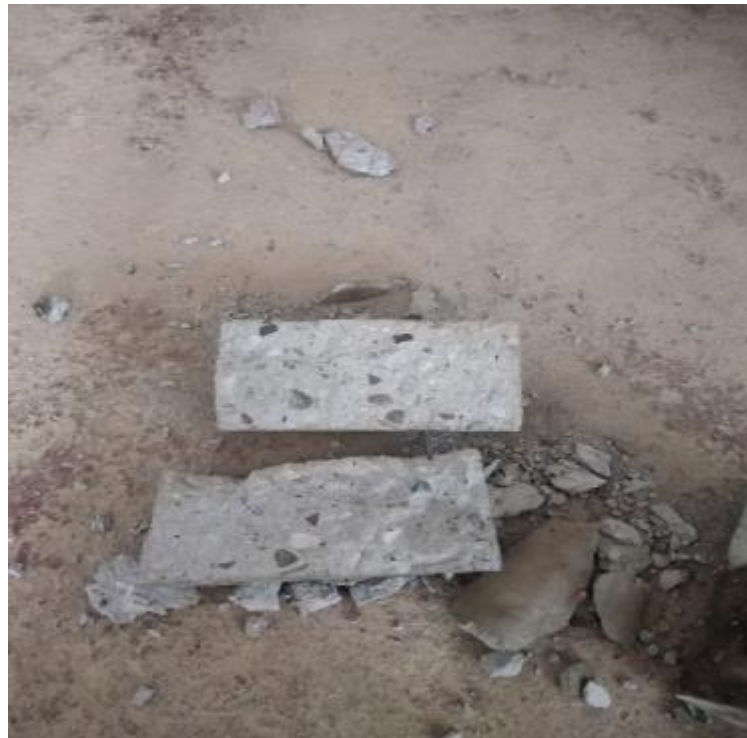
Rotura de la probeta a tracción diametral
