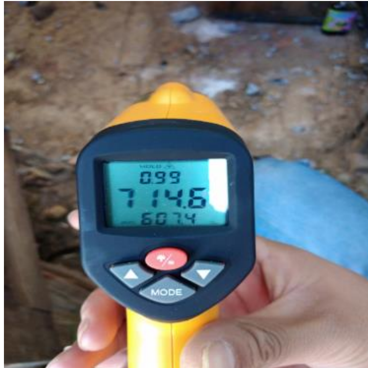
Probetas expuestas al fuego a los 700 °C.
