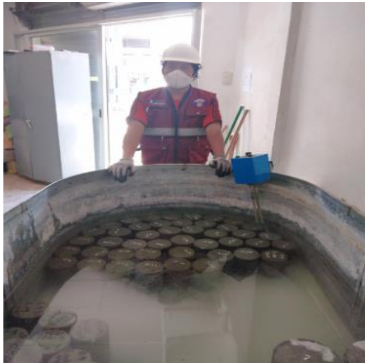
Curado de las probetas.
