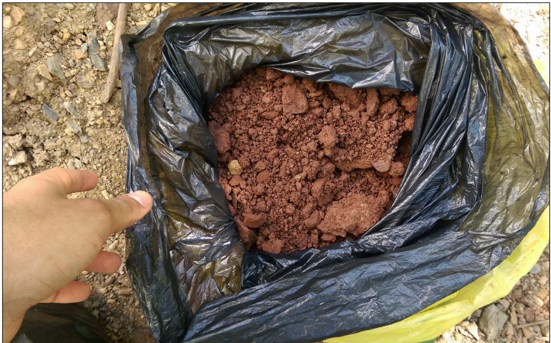
Figura 59: Vista de muestra Calicata N°1, profundidad 1.10 m. (Fuente: Propia, 2017)
