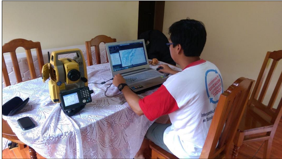
Figura 71: Trabajo de gabinete, Triangulación de puntos en el CivilCAD 3D. (Fuente: Propia, 2017)
