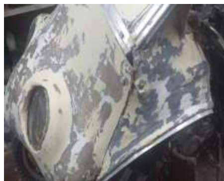
GRÁFICO N° 79: Chasis de fibra de vidrio para la motocicleta TOP RYDER
