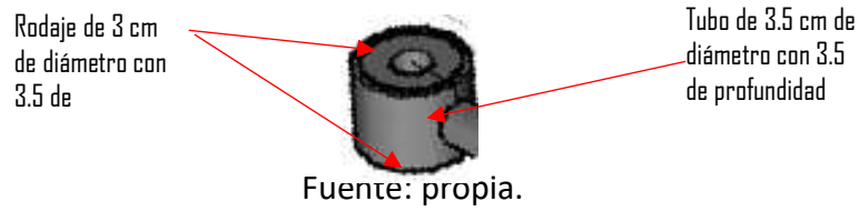
GRÁFICO N° 56: elemento para la unión del sistema de transmisión de dirección = 3und.
