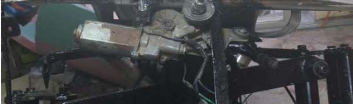
GRÁFICO N° 77: motor del sistema limpia parabrisas
