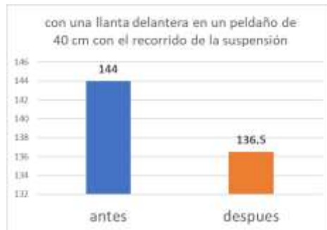
GRÁFICO N° 90: cuadro comparativo del recorrido de la suspensión con una llanta delantera en un peldaño de 40 cm con recorrido de la suspensión
