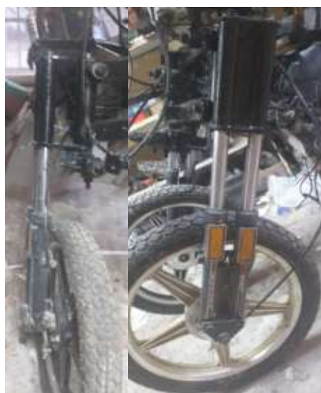
GRÁFICO N° 73: Sujeción de las barras telescópicas y eje de fricción de dirección.
