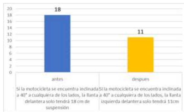
GRÁFICO N° 91: cuadro comparativo de la suspensión durante la inclinación máxima
