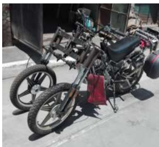
GRÁFICO N° 72: Motocicleta con el sistema delantero de dos llantas
