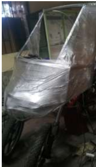
GRÁFICO N° 78: cobertura para aplicar la fibra de vidrio
