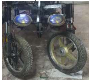
GRÁFICO N° 83: sistema de suspensión delantera
