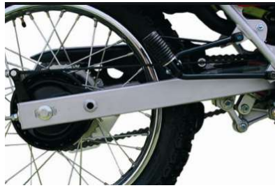
GRÁFICO N° 81: sistema de frenos de la llanta trasera
