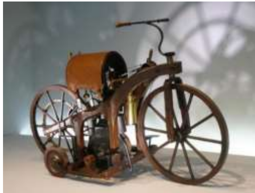
Gráfico N° 03: motocicleta con motor de ciclo Otto
