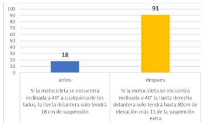
GRÁFICO N° 92: cuadro comparativo de la suspensión durante la inclinación máxima
