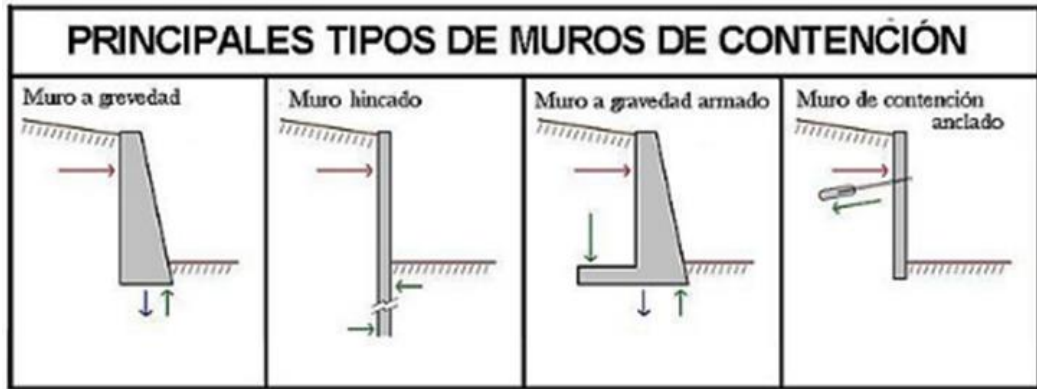
Imagen 1: Tipos de muros de contención
