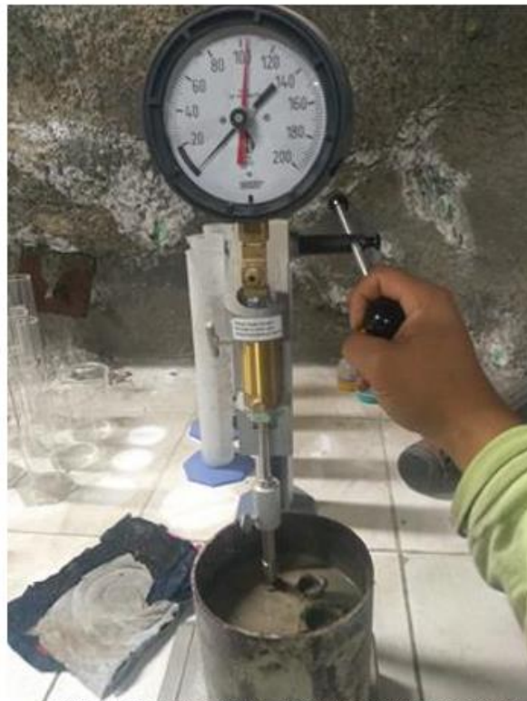
TIEMPO DE FRAGUADO CON EL PENETROMETRO
