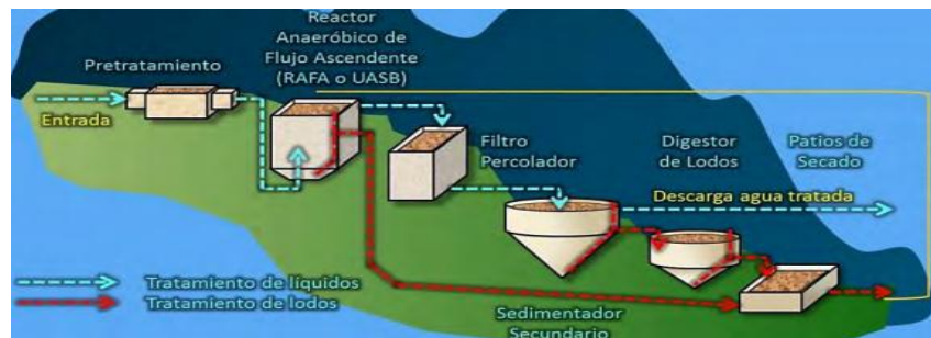
Figura N°40. Diseño conceptual de PTAR con RAFA y filtro percolador con sedimentación
