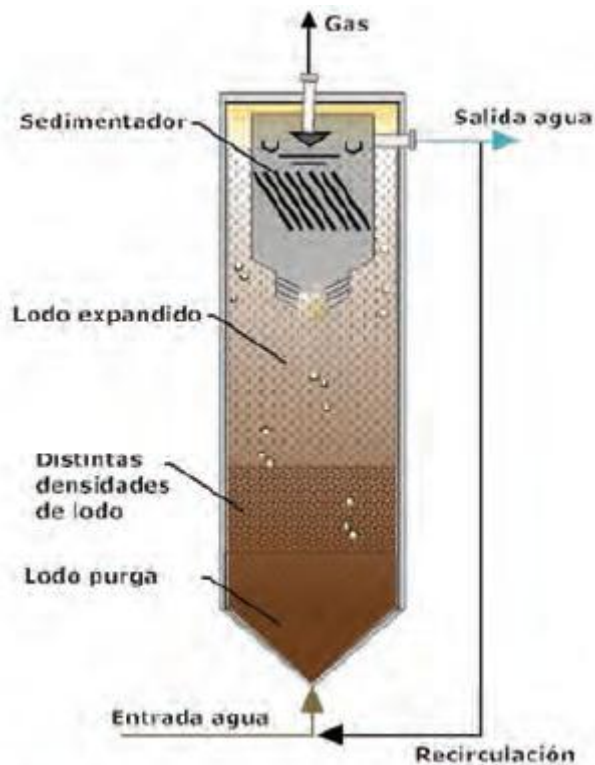
Figura N°29. Reactor de lecho expandido (EGSB)
