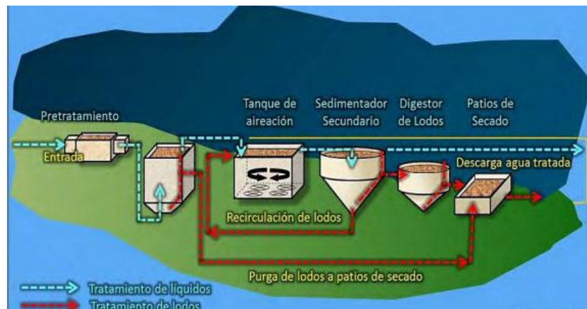
Figura N°41. Diseño conceptual de una planta de tratamiento con reactor anaeróbico y lodos activados
