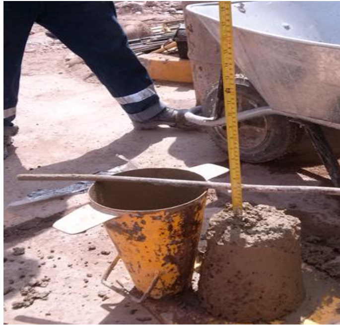
Figura 32: Medición del slump del concreto. Fuente: Elaboración propia.
