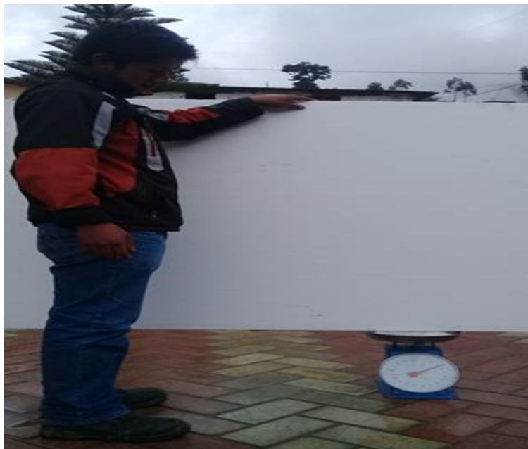
Figura 16: Verificación del peso del poliestireno. Fuente: Elaboración propia
