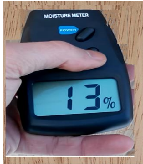
Figura 20: Aparato de medición de humedad para construcción y de la madera Fuente: Elaboración propia.
