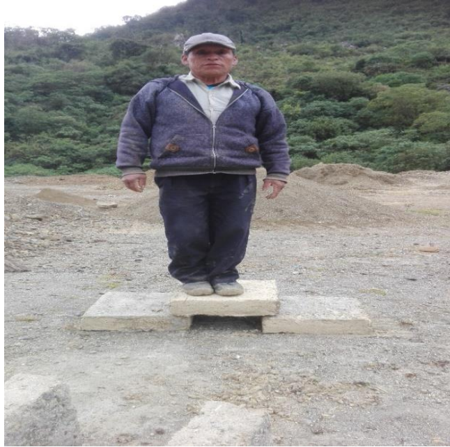
Figura 12: Prueba de resistencia del adobe. Fuente: Elaboración propia.
