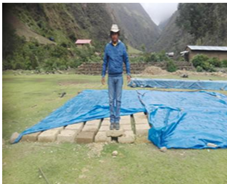
Figura 10: Prueba de calidad del adobe. Fuente: Elaboración propia.
