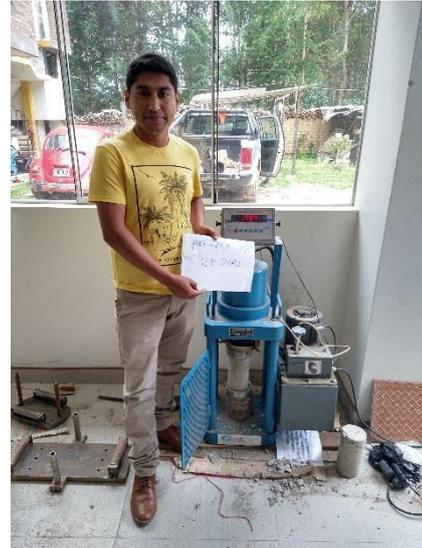
Fotografía 23. Rotura de probetas a los 28 días.
