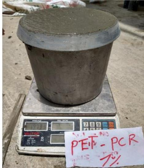
Fotografía 11. Pesaje de las muestras para el contenido de aire.
