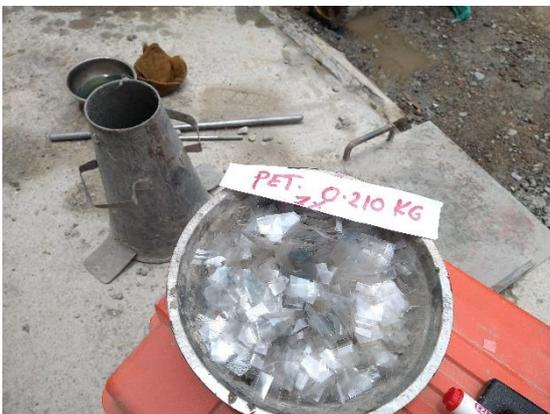
Fotografía 16. Pesaje de la fibra de PET – PCR para la elaboración de muestras.
