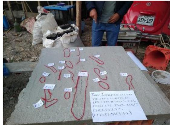
Fotografía 30. Fisuras a los 28 días de la losa convencional
