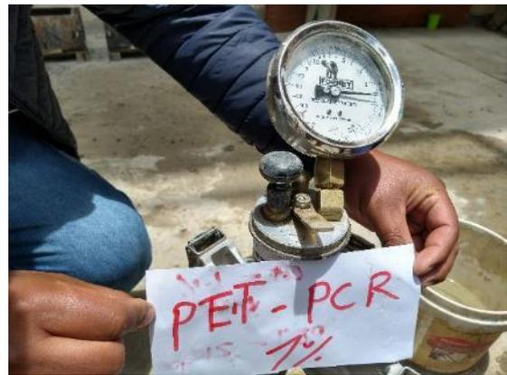
Fotografía 12. Cálculo del contenido de aire del PET – PCR al 1 %.
