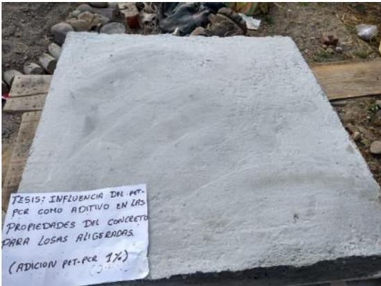
Fotografía 28. V Fisuras a los 28 días de la losa con adición del PET – PCR en 1.0 %.
