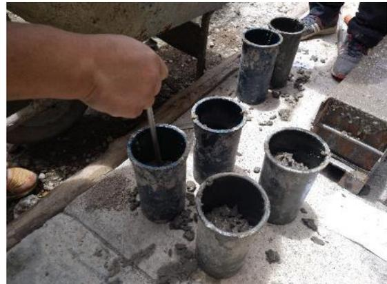
Fotografía 19. Preparación de muestra para resistencia a compresión.
