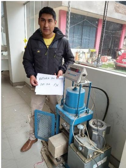
Fotografía 21. Ensayo de rotura de viguetas con 1% de PET - PCR.
