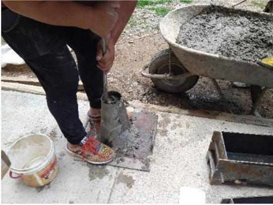
Fotografía 8. Preparación de muestra de asentamiento.
