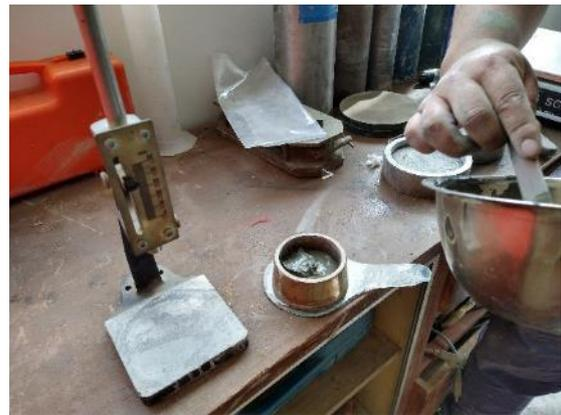
Fotografía 13. Preparación de muestras para el tiempo de fraguado.
