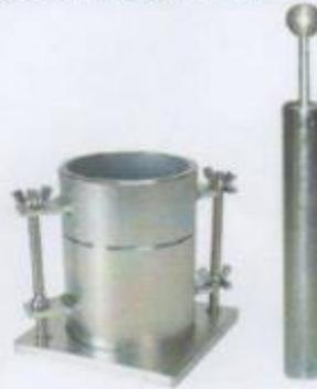
Los Moldes y Martillos están usados para determinar la relación entre el contenido de humedad y la densidad de suelos compactados. Hechos de acero niquelado, incluye collar, cuerpo del molde y base (plato). Los martillos están usados para compactar la muestra de suelo en los moldes Proctor y son hechos de acero niquelado. Diferentes modelos están disponibles, cumpliendo con los estándares pertinentes.
