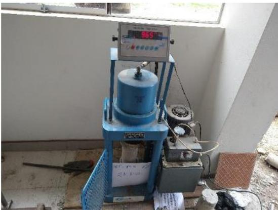
Fotografía 22. Rotura de testigos para el ensayo a compresión.
