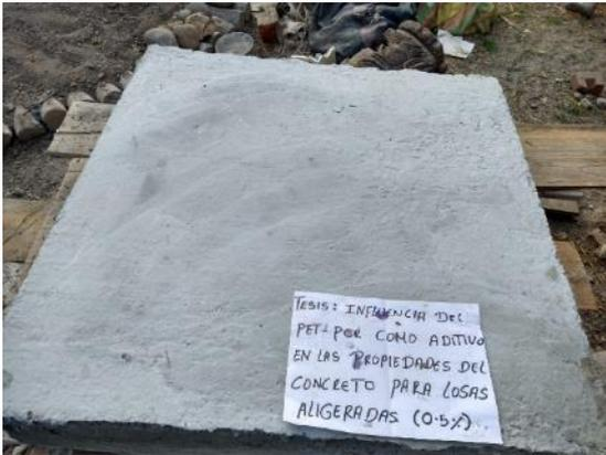
Fotografía 27. Fisuras a los 28 días de la losa con adición del PET – PCR en 0.5 %.
