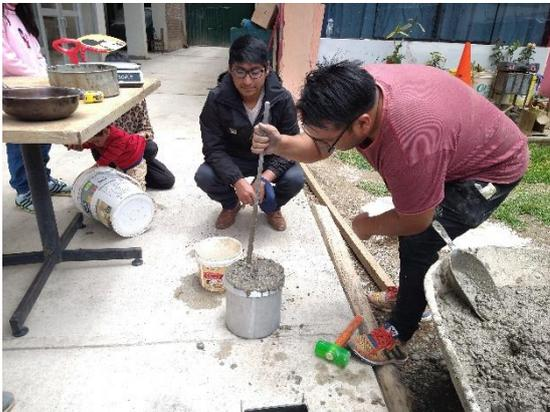
Fotografía 10. Vista de la preparación de la muestra para el contenido de aire.
