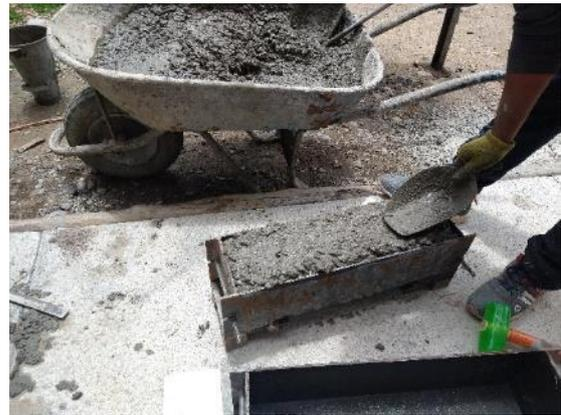
Fotografía 18. Preparación de viguetas para el ensayo de flexión.
