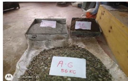
Fotografía 4. Pesaje de los componentes del concreto.
