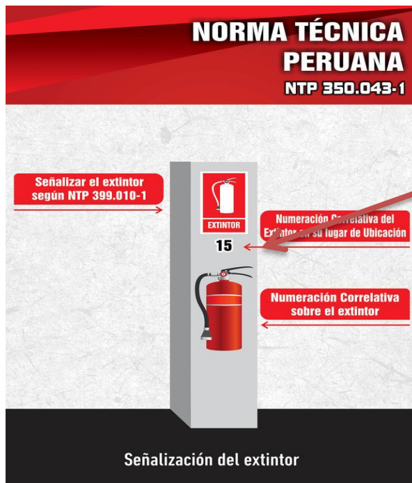
Ilustración 7: Ubicación de extintor según Norma Técnica Peruana
