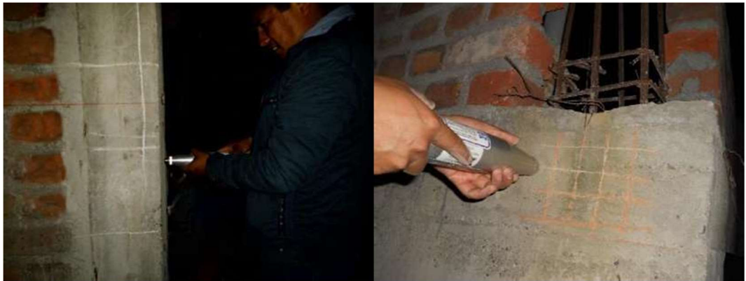
Prueba de resistencia con esclerómetro
