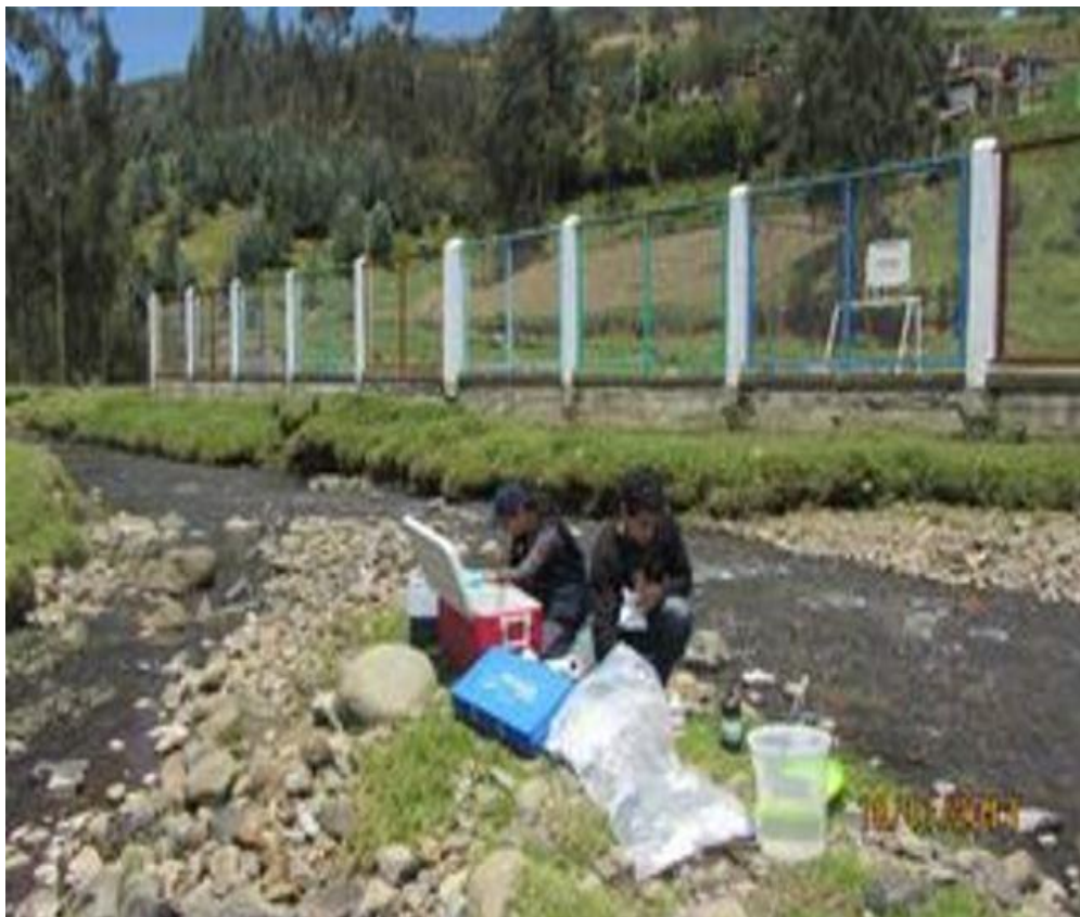
IMAGEN N.02: Muestreo del efluente de aguas residuales – Chacapampa.
