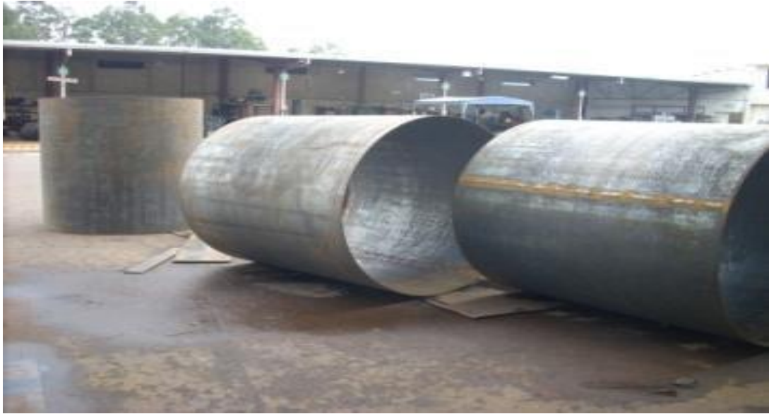
Fotografía: C-5 Planchas roladas y punteadas.
