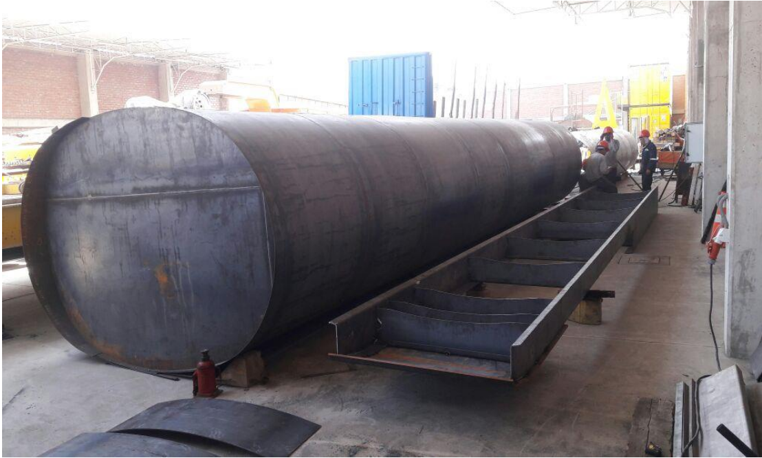
Fotografía: C-9 Estructura lista para montaje de cuerpo sobre chasis.
