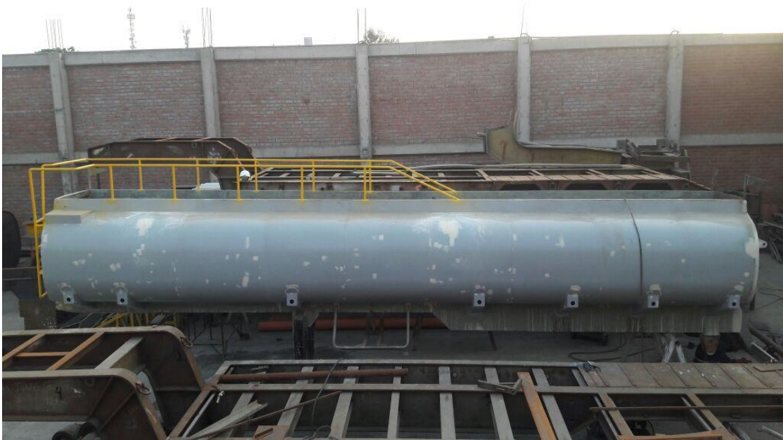
Fotografía: C-10 Estructura montada sobre chasis para lijado, pulido y soldadura en general.
