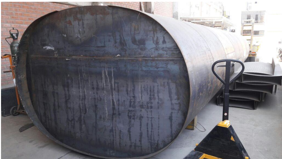
Fotografía: C-8 Cuerpo de cisterna armado.
