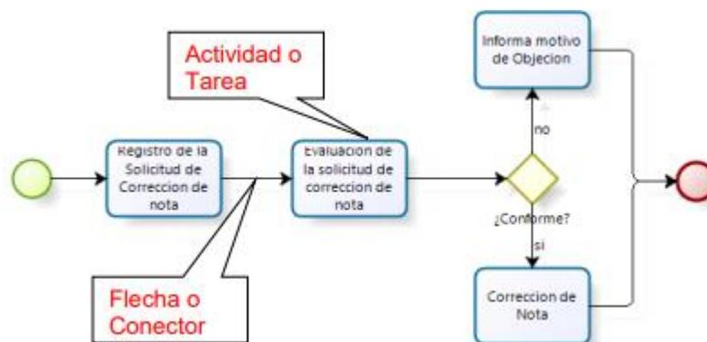
Figura 5. Ejemplo de un proceso básico
