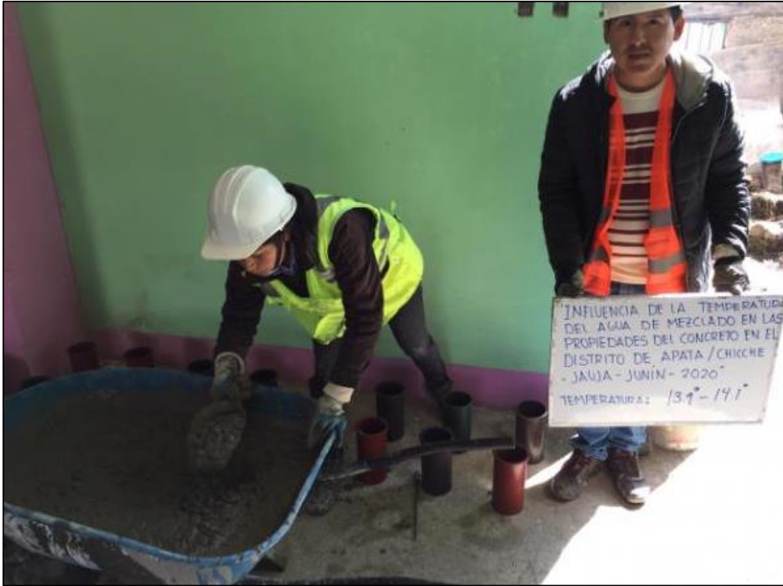
Fotografía 23. Preparación de testigos para los ensayos de compresión flexión de la mezcla de concreto con agua a 14 °C.
