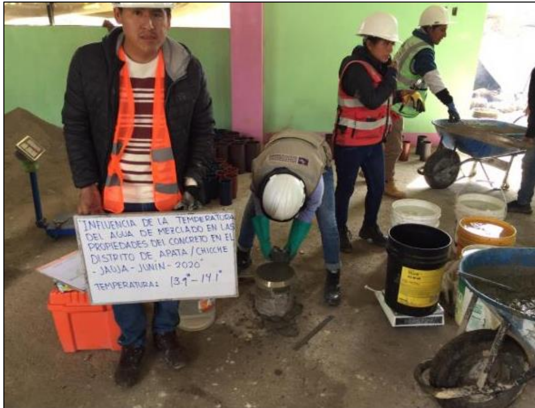
Fotografía 19. Medición del peso unitario de la mezcla del concreto con agua a 14 °C.
