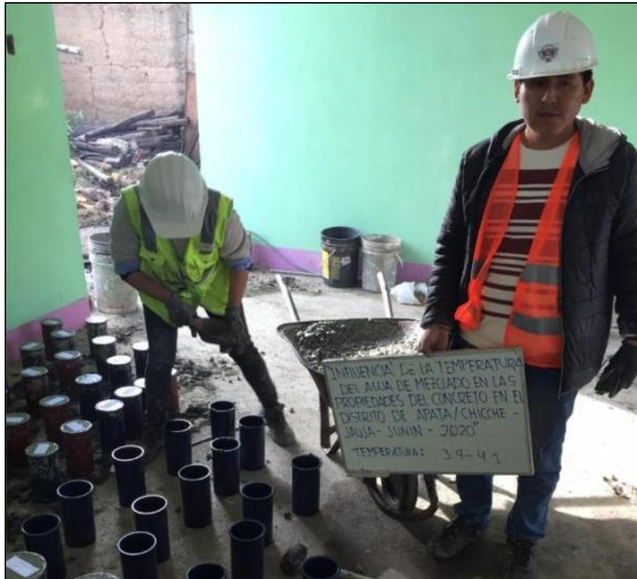
Fotografía 15. Elaboración de probetas para roturas a compresión y a flexión.
