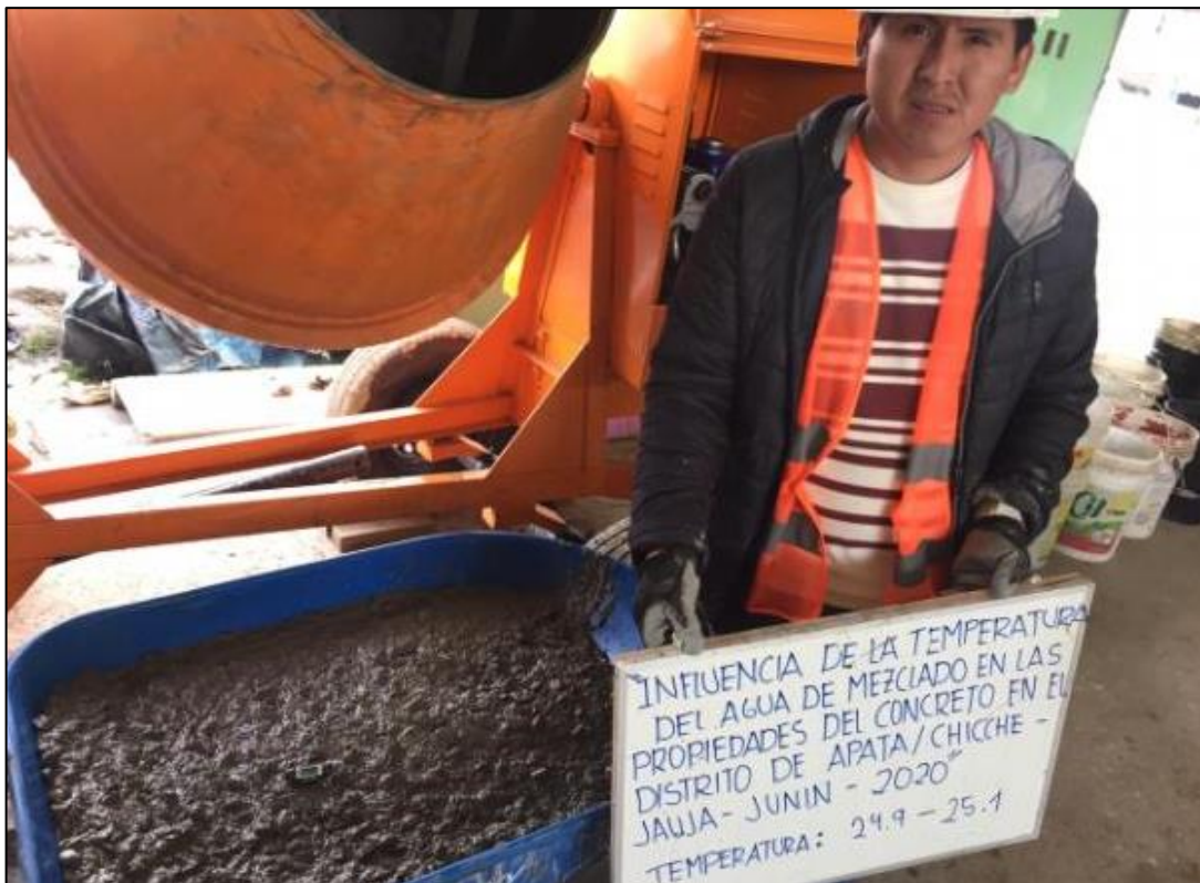
Fotografía 26. Medición de la temperatura del concreto con agua a 25 °C.
