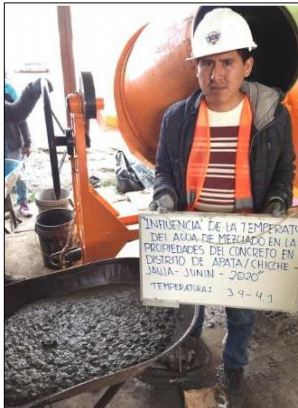
Fotografía 10. Medición de la temperatura de la mezcla con agua a 4 °C.
