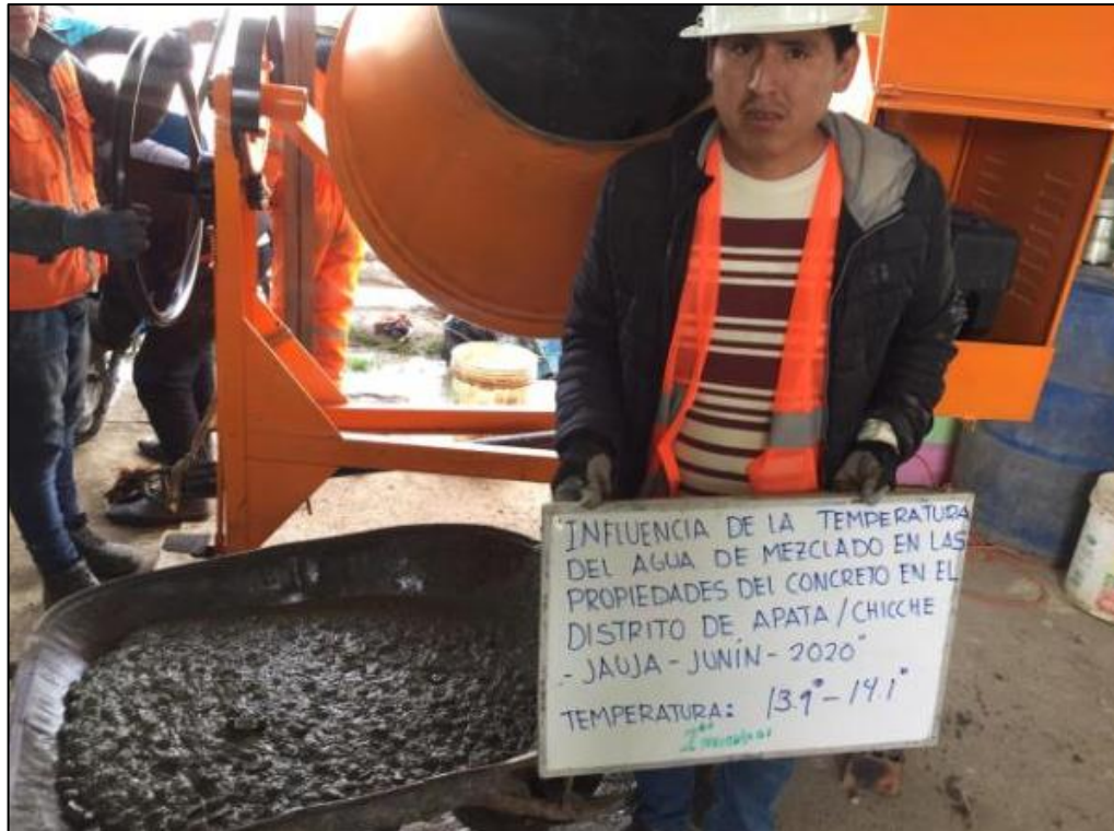
Fotografía 17. Medición de la temperatura de la mezcla de concreto con agua a 14 °C.
