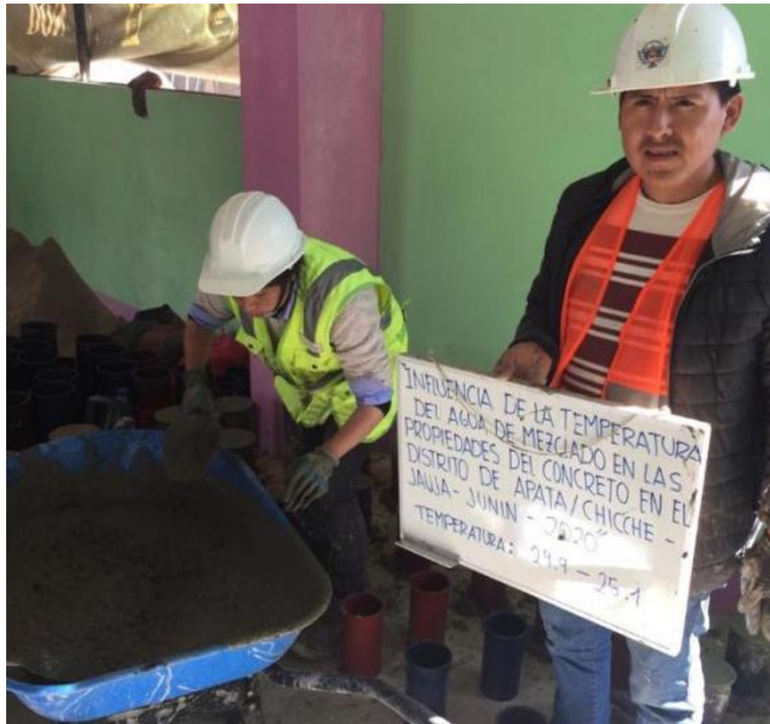
Fotografía 30. Preparación de los testigos para las roturas a compresión y flexión del concreto con agua a 25 °C.
