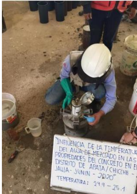
Fotografía 29. Ensayo de contenido de aire para la mezcla con agua a 25 °C.
