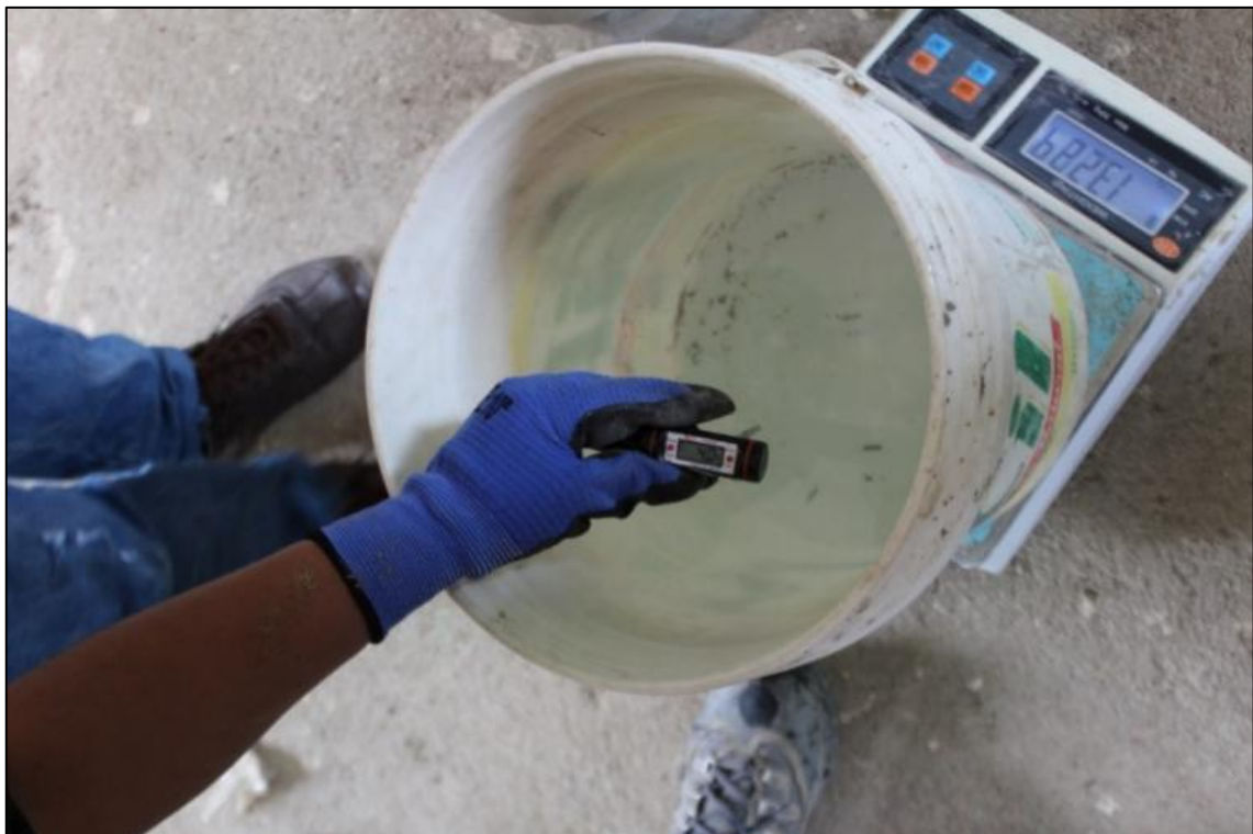
Fotografía 8. Medición de la temperatura del agua a 4 °C, se dio mezclando hielo y agua caliente para cumplir con la temperatura.
