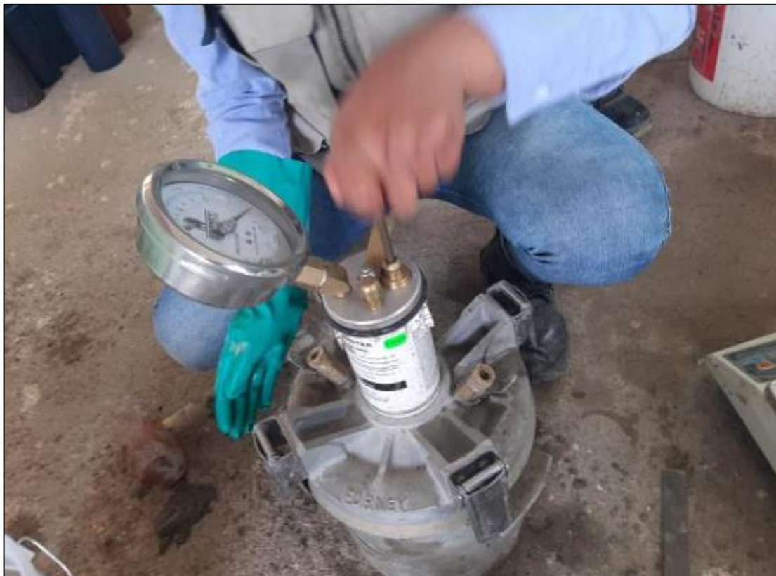
Fotografía 22. Ensayo de contenido de aire de la mezcla de concreto con agua a 14 °C.
