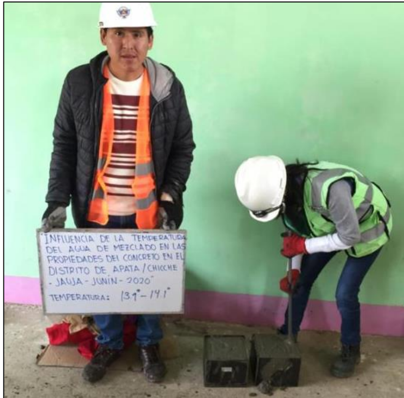
Fotografía 21. Ensayo de Exudación del concreto para la mezcla con agua a 14°C.
