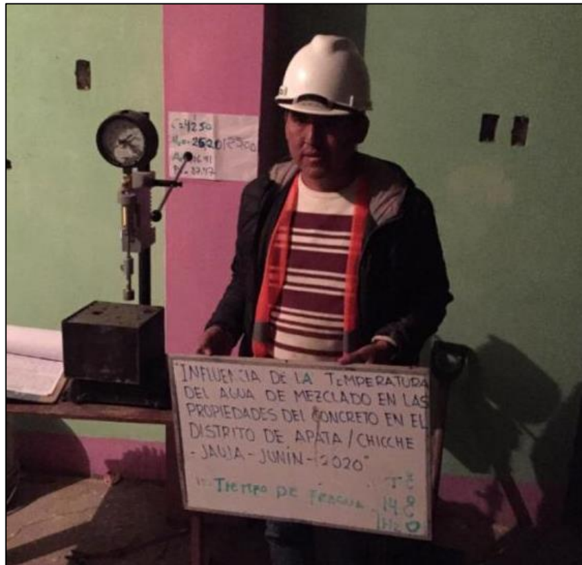
Fotografía 24. Ensayo de tiempo de fragua de la mezcla de concreto con agua a 14 °C.
