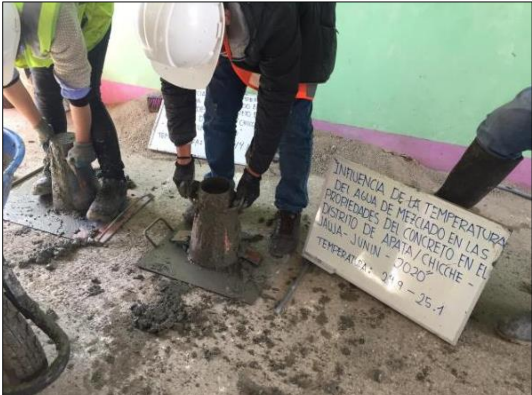
Fotografía 27. Medición del slump con el cono de Abrams para la mezcla de concreto con agua a 25 °C.
