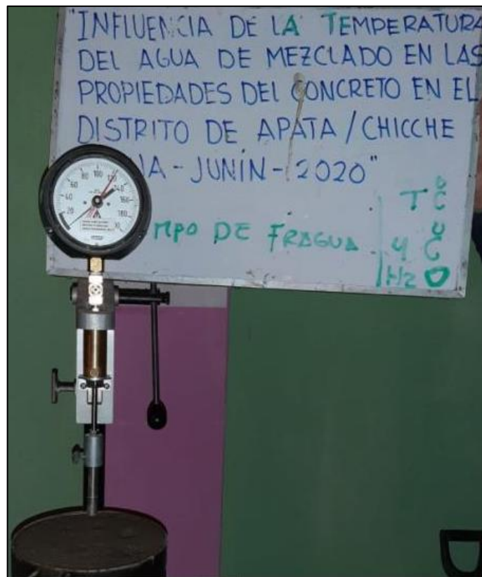
Fotografía 14. Ensayo de tiempo de fragua del concreto con agua a 4 °C.
