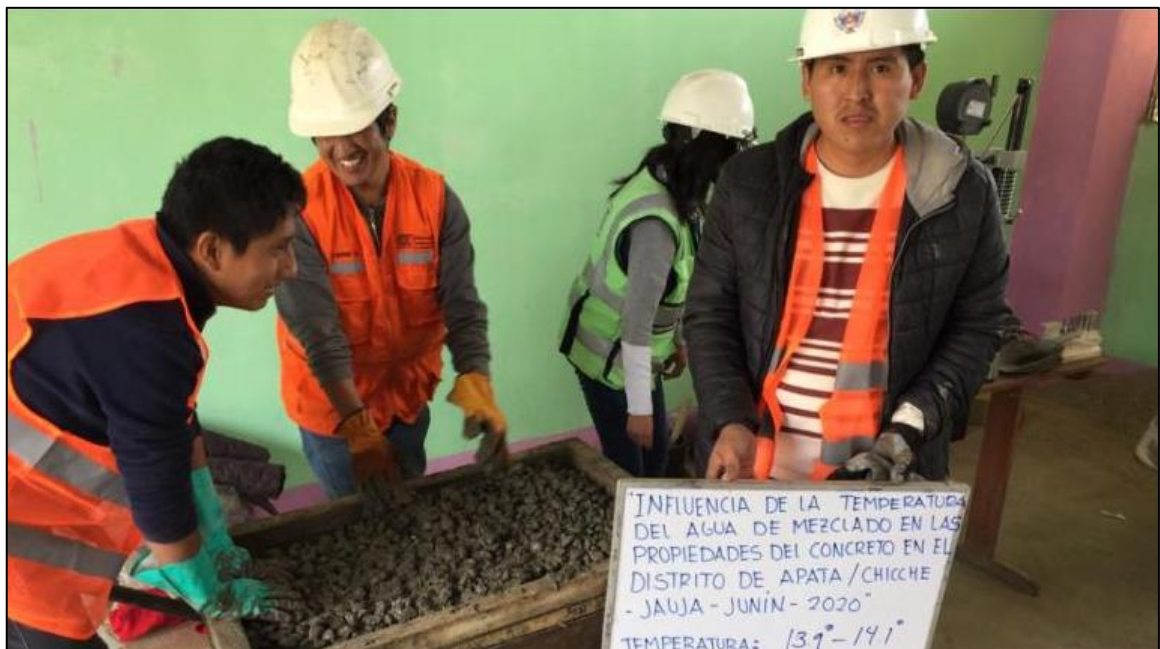
Fotografía 20. Tamizado de la mezcla de concreto a 14 °C para el ensayo de fraguado y exudación.
