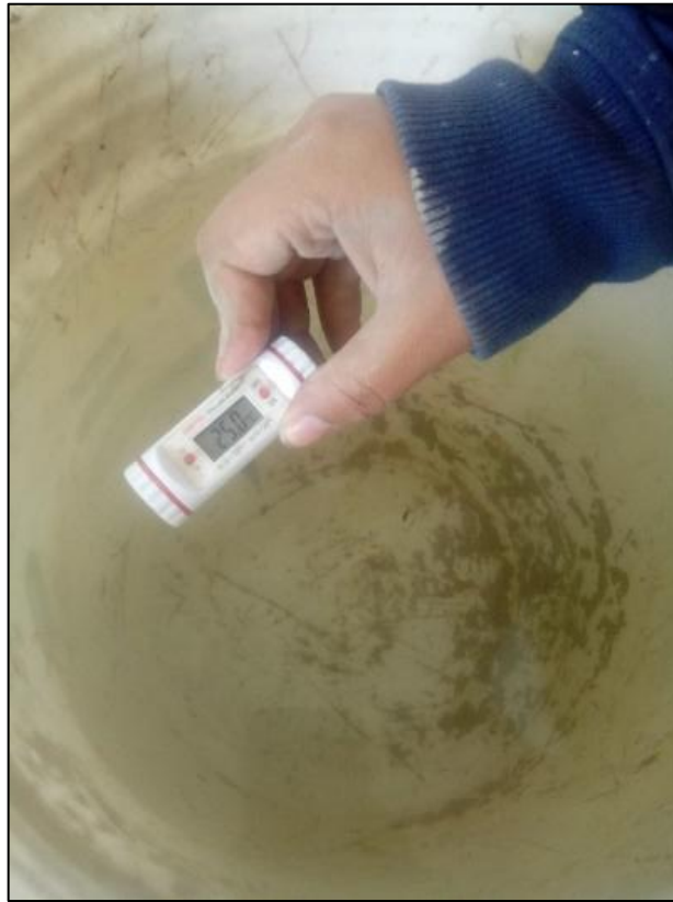
Fotografía 25. Medición de la temperatura del agua a 25 °C, para ello se mezcló agua congelada y agua caliente para cumplir con la temperatura.
