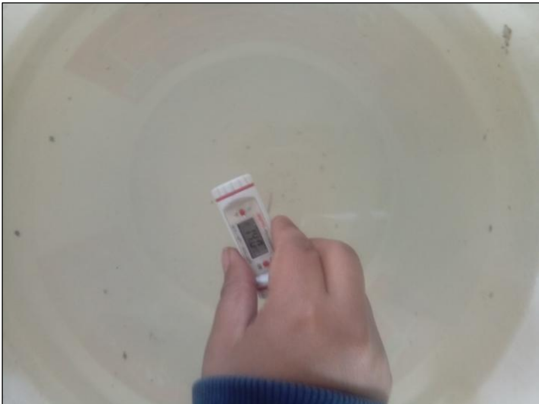
Fotografía 16. Medición de la temperatura del agua a 14 °C, para lo cual se utilizó agua congelada y agua caliente para cumplir con la temperatura.
