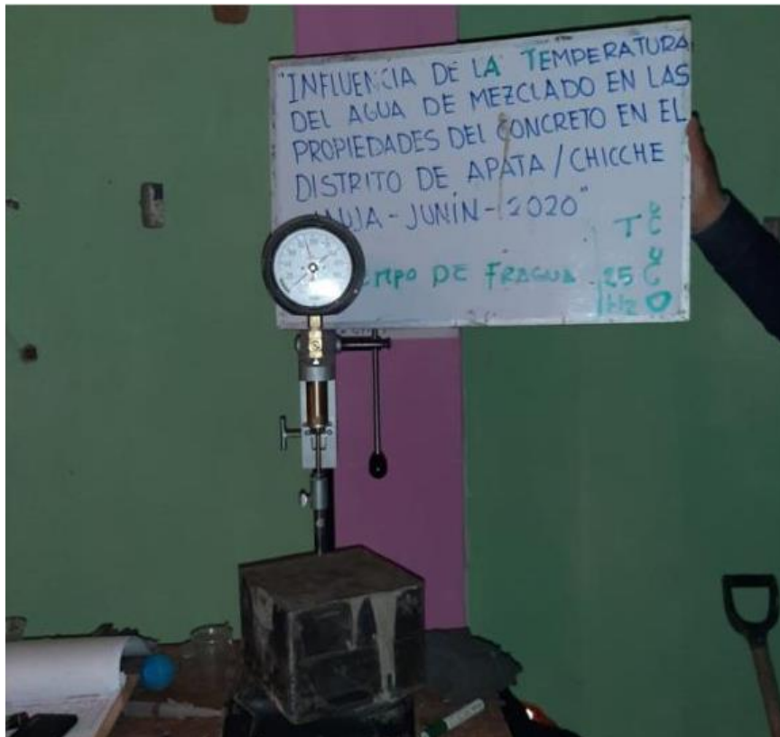
Fotografía 32. Ensayo de tiempo de fragua de la mezcla de concreto con agua a 25 °C.
