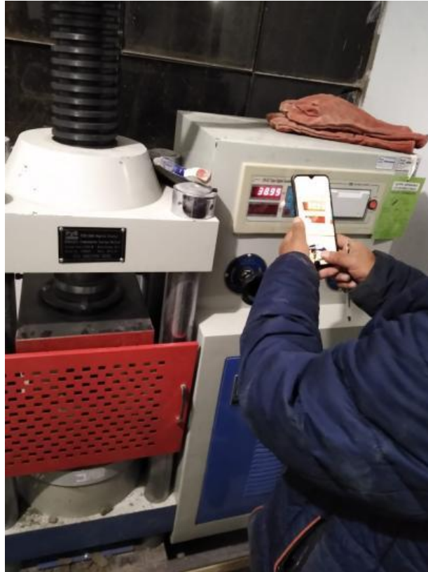
Fotografía 35. Rotura de testigos en laboratorio, según sea el método de medición, para compresión testigos de 4 x 8" y testigos de 6 x 12" para tracción .
