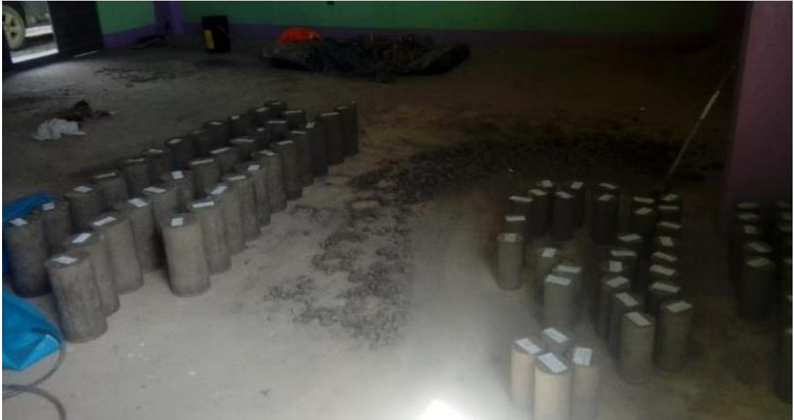
Fotografía 33. Desencofrado de los testigos para la rotura según los días especificados en la presente investigación.
