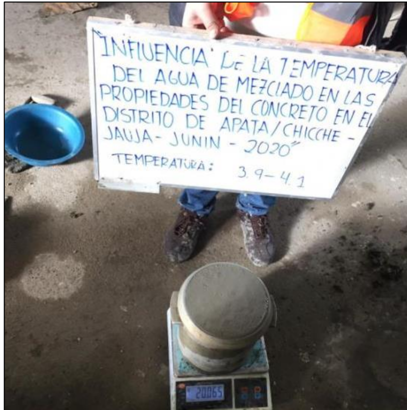
Fotografía 11. Control del peso unitario de la mezcla de concreto con agua a 4 °C.
