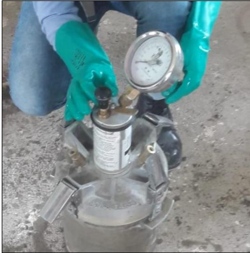
Fotografía 13. Ensayo de contenido de aire en la mezcla con agua a 4 °C.
