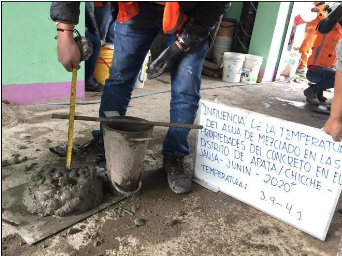
Fotografía 9. Medición de slump con el cono de Abrams para la mezcla con agua a 4 °C.
