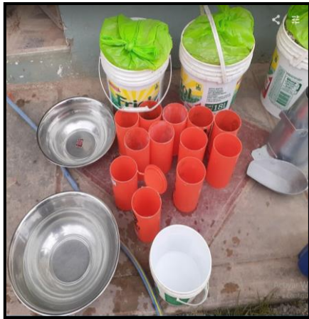
Fotografía 20 y Fotografía 21: Vista de moldes para la elaboración de los cilindros de concreto de acuerdo a la NTP 339.209
