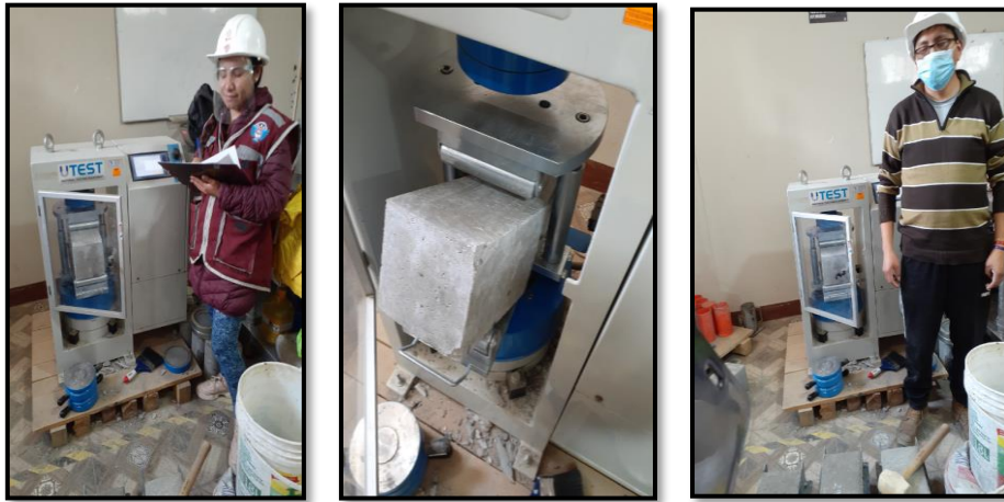
Fotografía 36, Fotografía 37 y Fotografía 38: Ensayo de la resistencia a flexión de vigas de concreto (NTP 339.078).
