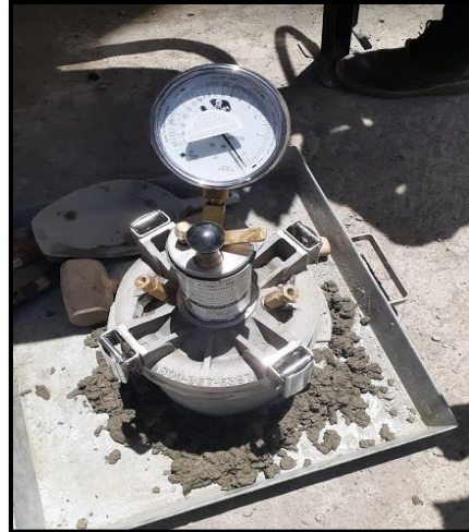
Fotografía 30 y Fotografía 31: Estacionando el manómetro en cero y medida del contenido de aire con aguas tratadas de biodigestores (NTP 339.085).
