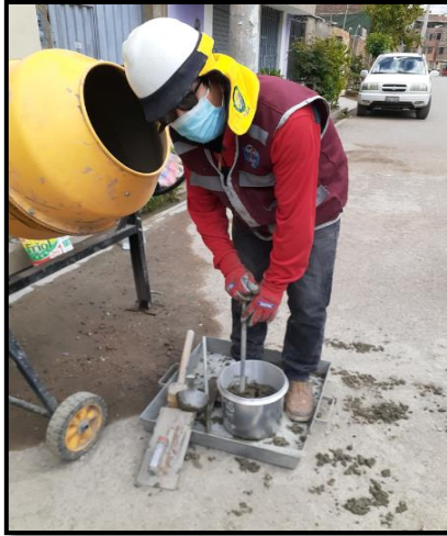
Fotografía 30 y Fotografía 31: Estacionando el manómetro en cero y medida del contenido de aire con aguas tratadas de biodigestores (NTP 339.085).
