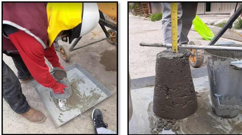
Fotografía 14 y Fotografía 15: medición del asentamiento con el cono de abrams (NTP 339.035)
