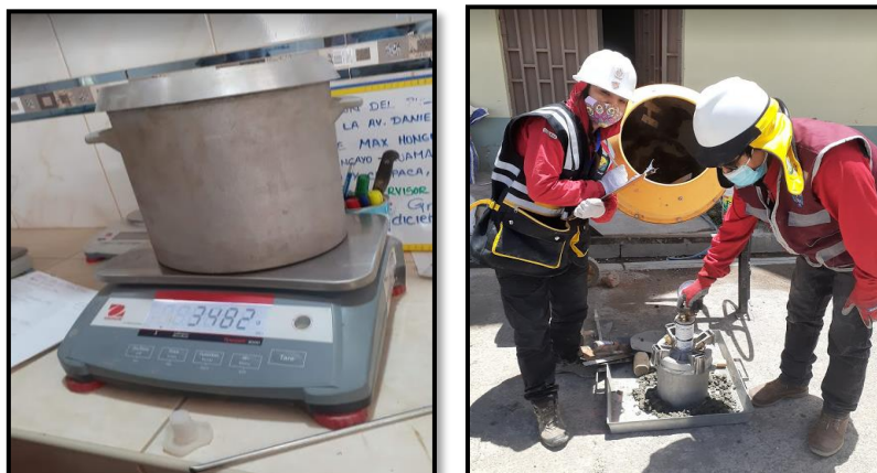
Fotografía 16 y Fotografía 17: Medición del molde y el contenido de aire por el método a presión del concreto (NTP 339.085).
