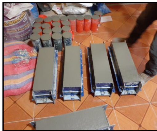
Fotografía 32: Elaboración de cilindros y vigas de concreto con aguas tratadas de biodigestores (NTP 339.183).
