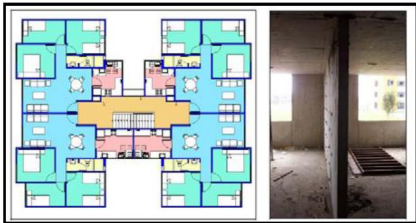
Figura N°10. Muros estructurales de C°A°
