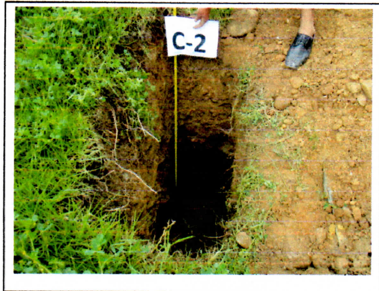
FOTO 06.- PROFUNDIDAD EXCAVADA DE LA C-2 A 2.10 mt
