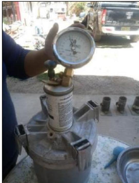
Fotografía 28. Medición del contenido de aire del concreto permeable.
