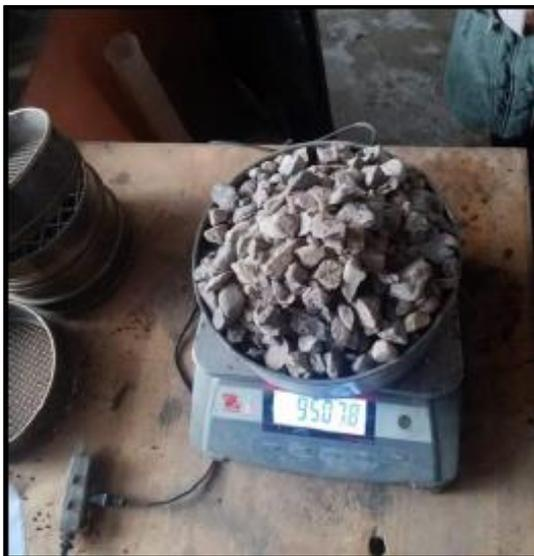
Fotografía 2. Pesaje del agregado grueso.
