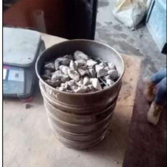
Fotografía 4. Tamizado del agregado grueso.
