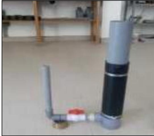
Figura 11. Permeámetro de carga variable.
