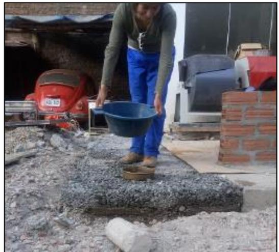
Fotografía 44. Vista de la permeabilidad del concreto permeable.
