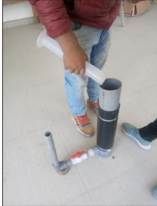
Fotografía 38. Medición de la permeabilidad del concreto.
