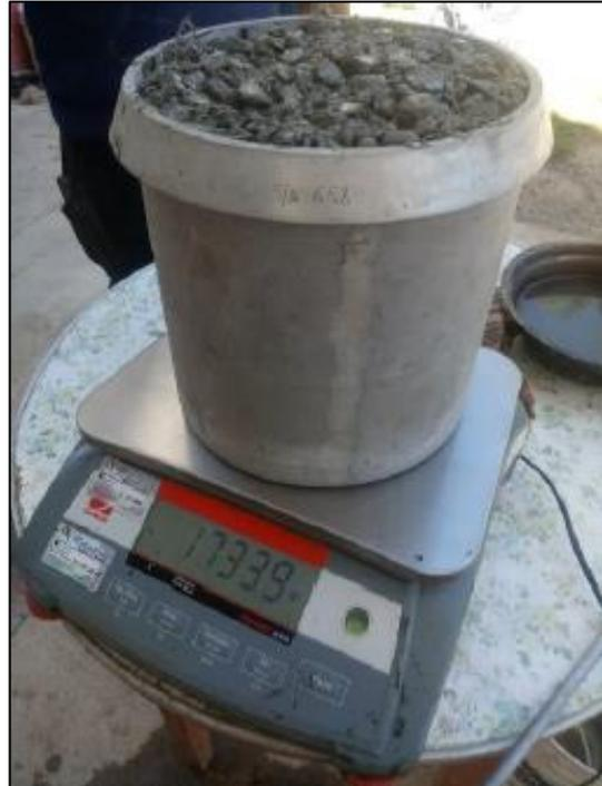
Fotografía 27. Pesaje de la muestra de concreto permeable.
