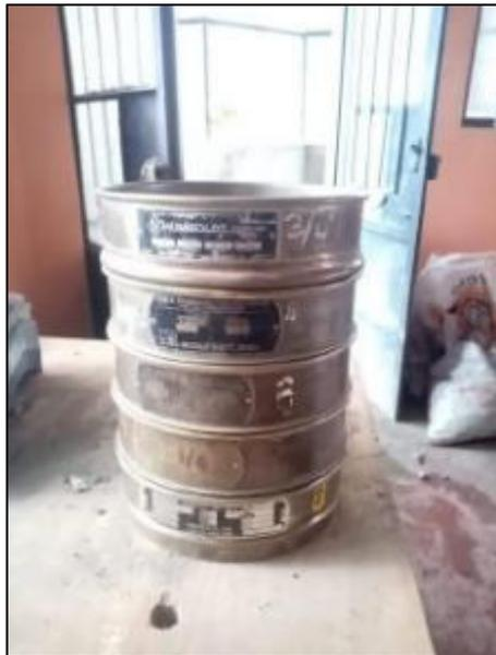
Fotografía 3. Tamices para el agregado grueso.
