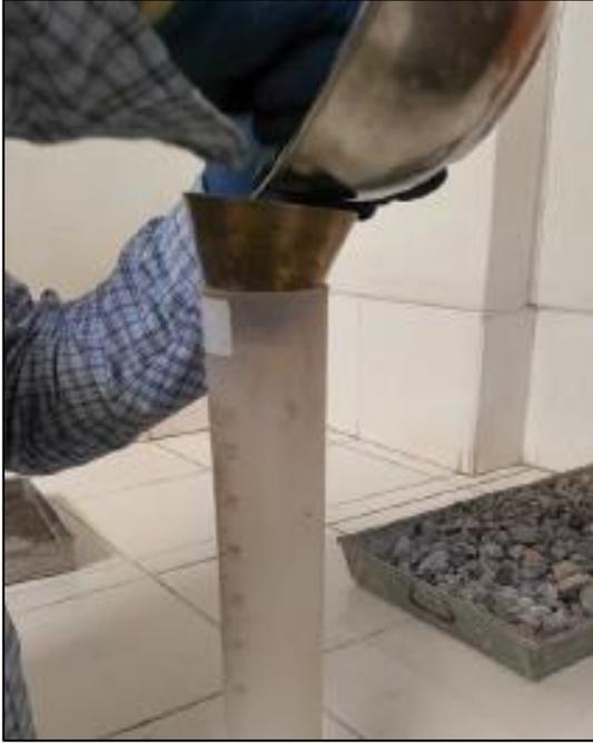
Fotografía 19. Colocado de la muestra en una probeta graduada de peso conocido.
