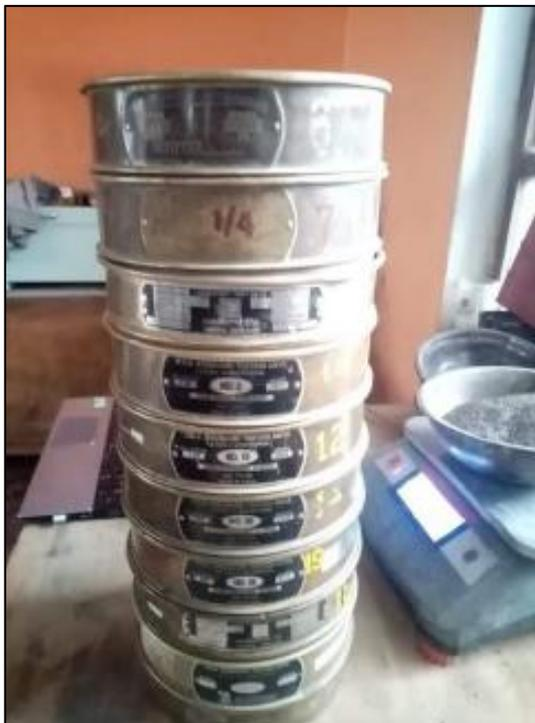
Fotografía 9. Tamices para el agregado fino.
