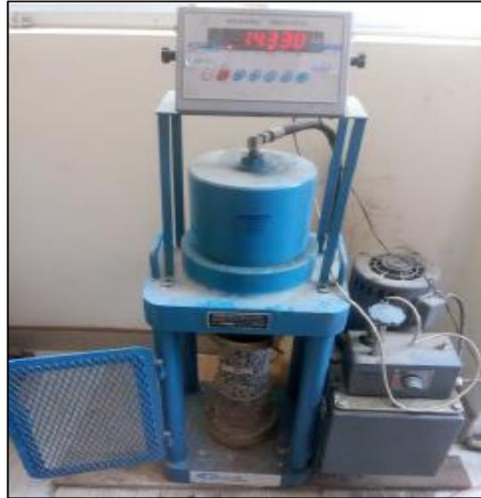
Fotografía 32. Rotura de probetas de concreto permeable.
