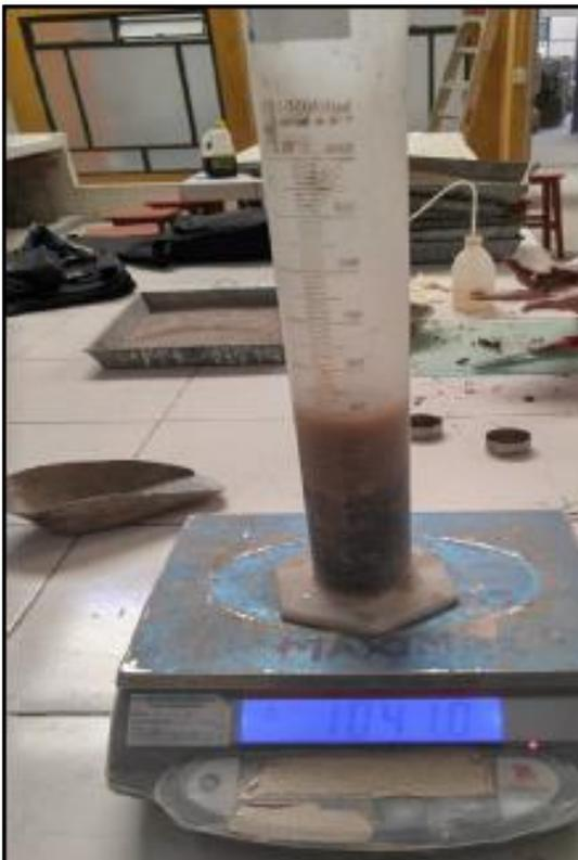
Fotografía 20. Adición progresiva de agua hasta saturar la muestra para el pesaje.
