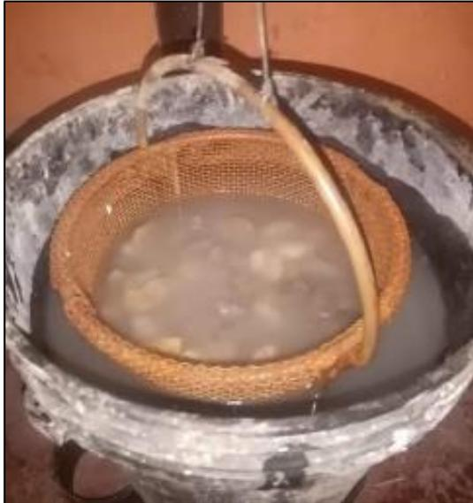
Fotografía 13. Material grueso saturado por 24 horas para el peso específico y absorción.
