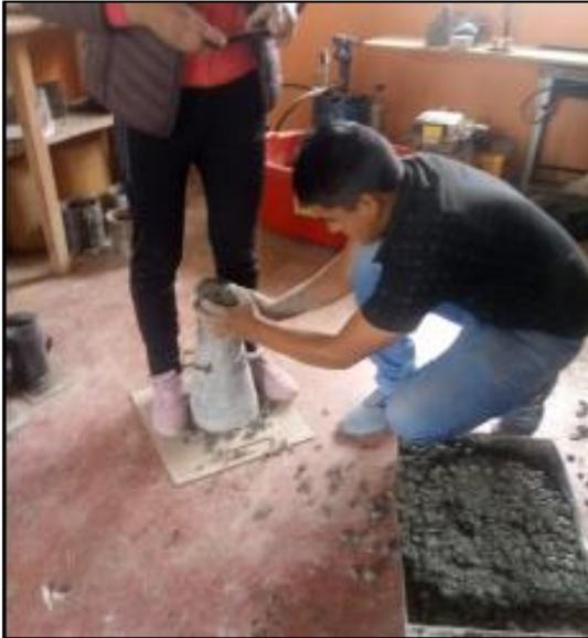
Fotografía 24. Llenado del concreto permeable para la medición del asentamiento.
