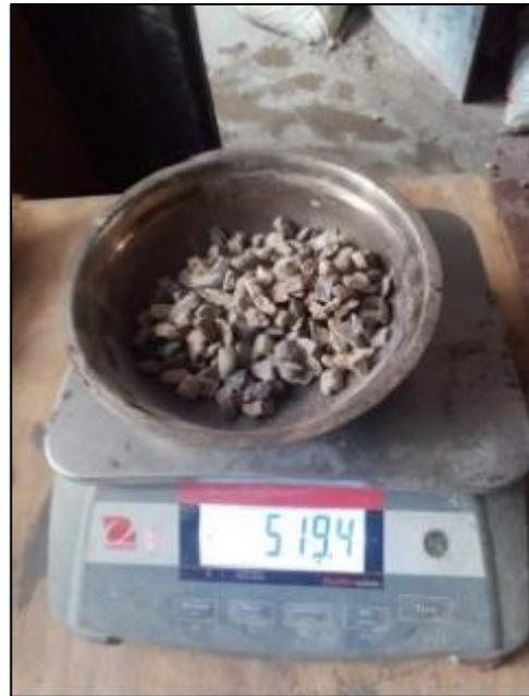
Fotografía 5. Pesaje del agregado grueso retenido.
