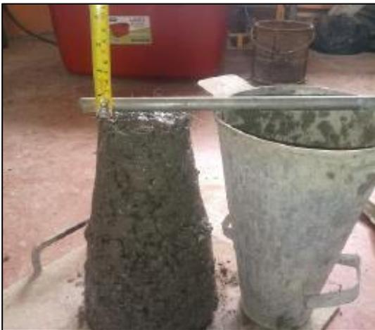
Fotografía 25. Medición del asentamiento del concreto permeable.
