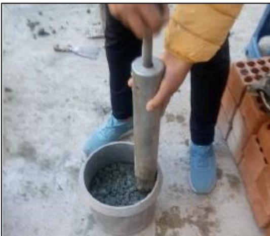
Fotografía 26. Preparado del concreto permeable para la medición del contenido de vacíos.
