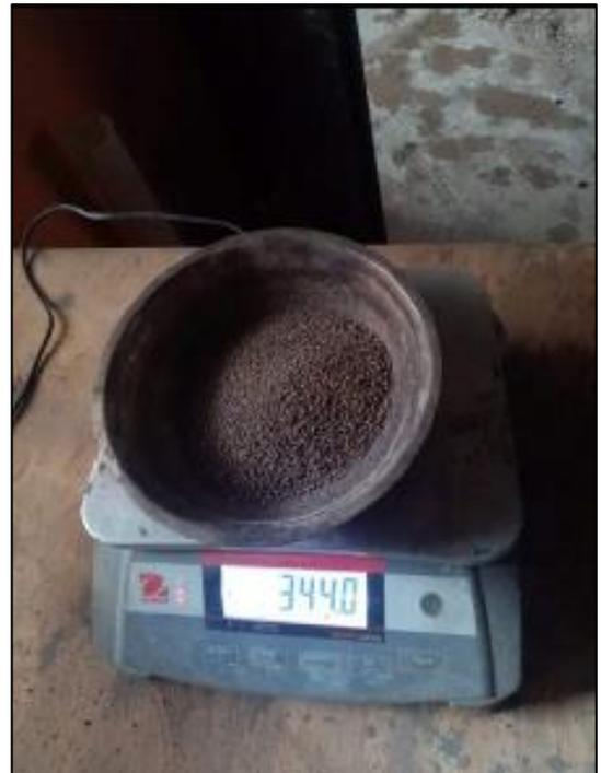
Fotografía 18. Pesaje del agregado fino con superficie seca.
