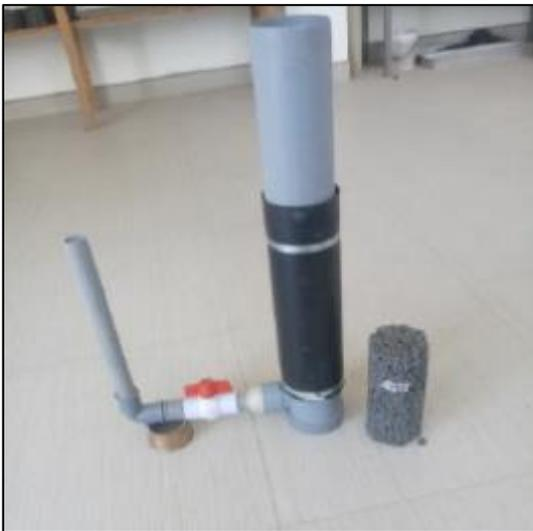
Fotografía 37. Vista del permeámetro de carga variable.
