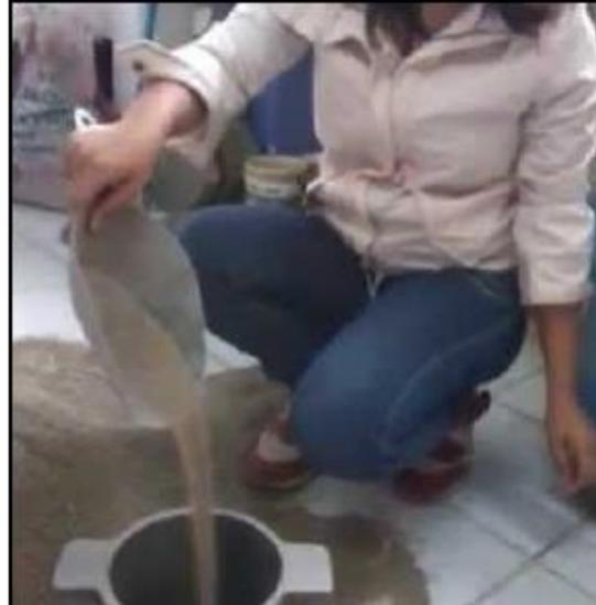
Fotografía 21. Llenado del agregado fino para el apisonado para el peso unitario del mismo.
