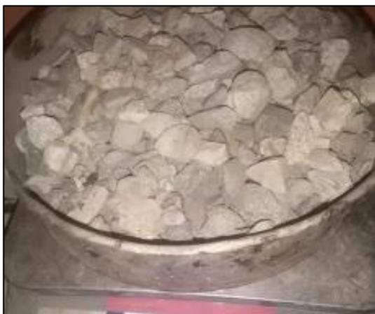
Fotografía 15. Pesado del agregado grueso con superficie seca.
