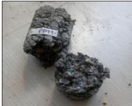
Fotografía 33. Probeta de concreto permeable roturada.
