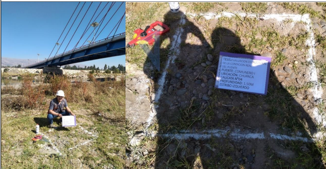
Calicata N°04 margen derecha, de 1.00 metro por 1.00 metro, excavación de 1.50m.
