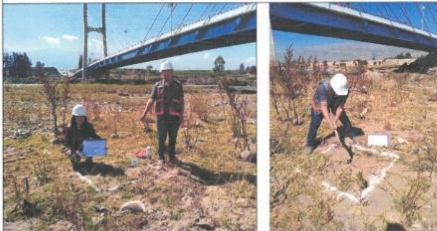
Calicata N°06 margen derecha, de 1.00 metro por 1.00 metro, excavación de 1.50m.
