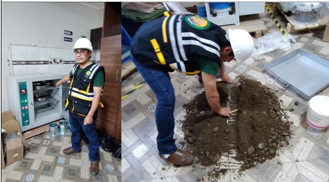
Secado y cuarteo de las muestras de las Calicatas de la margen Izquierda
