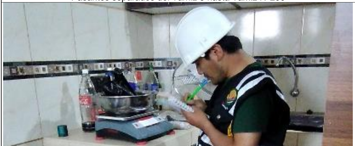
Tomando datos de los pesos parciales retenido en cada tamiz de las muestras de la margen derecha
