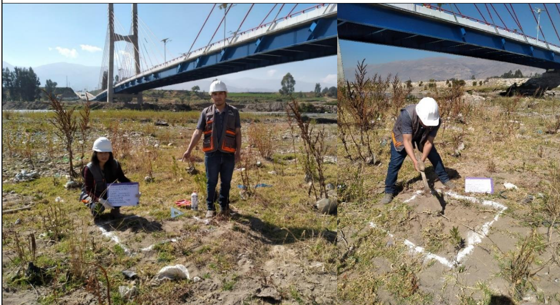
Calicata N°06 margen derecha, de 1.00 metro por 1.00 metro, excavación de 1.50m.
