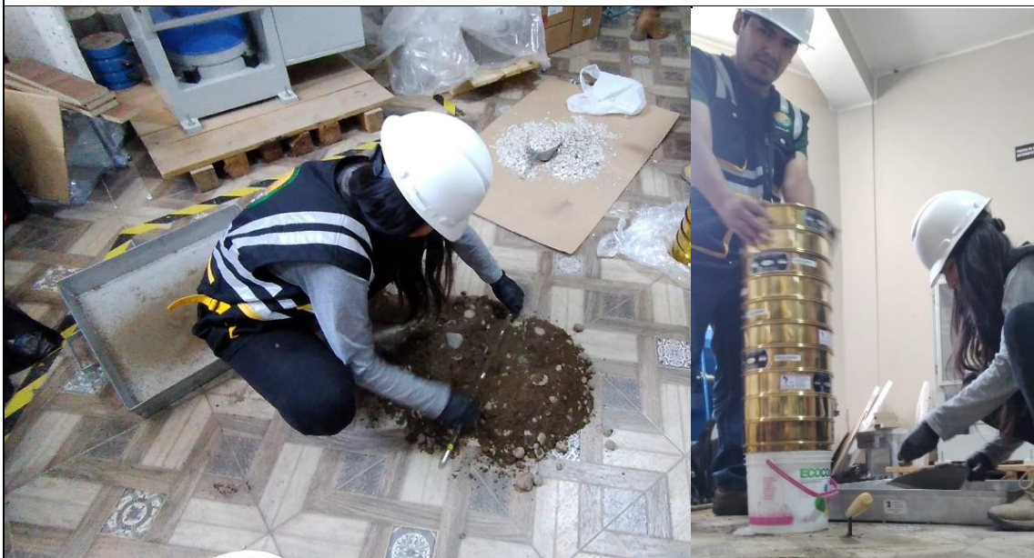
Cuarteo y granulometría de las muestras de las Calicatas de la margen Derecha
