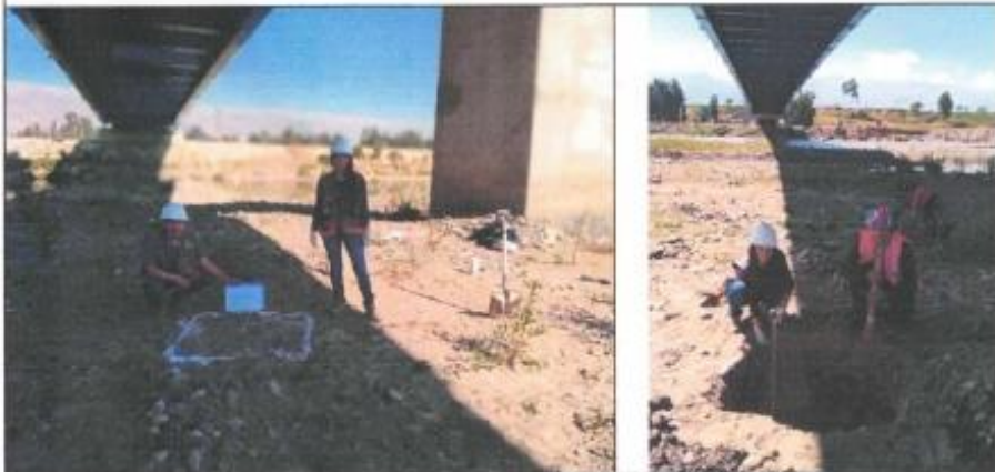
Calicata N°05 margen derecha, de 1.00 metro por 1.00 metro, excavación de 1.50m.
