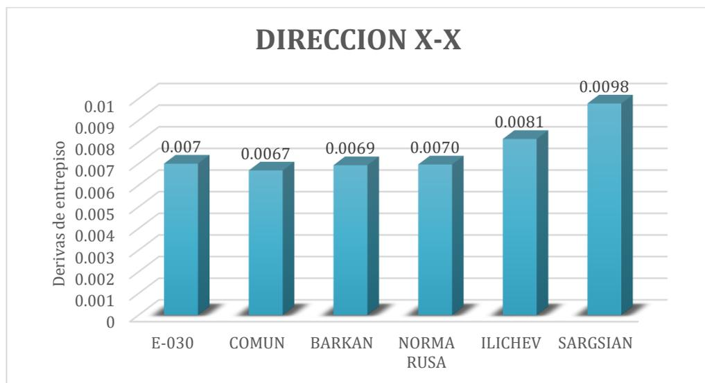
**Figura 64** Comparación derivas de entrepiso Dirección x.x- Huancayo
