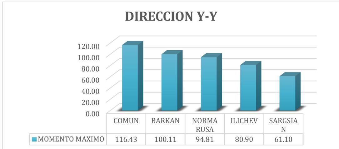
**Figura 73** Comparación del momento máximo dirección y.y – Huancayo
