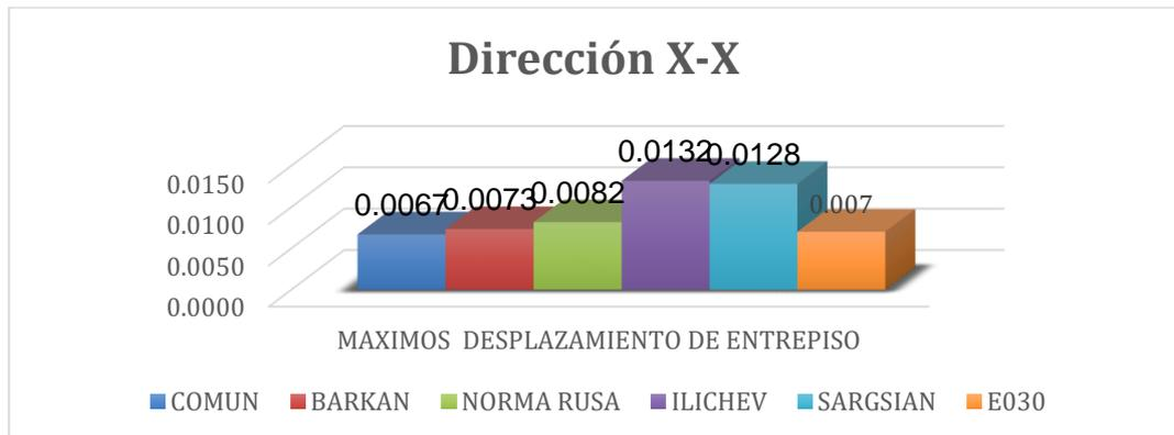
**Figura 88** Comparación derivas de entrepiso Dirección x.x- Chilca
