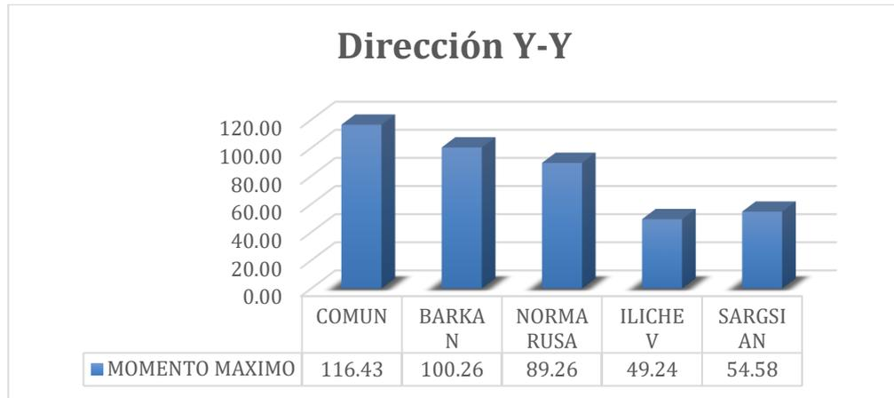
**Figura 85** Comparación del momento máximo dirección y.y – Tambo
