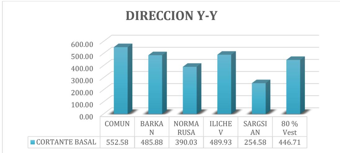
**Figura 69** Comparación de la cortante basal máxima Dirección y.y Huancayo
