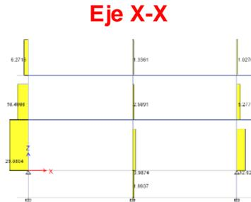
**Figura 40** Fuerza axial máxima x.x A.D.M. Espectral
