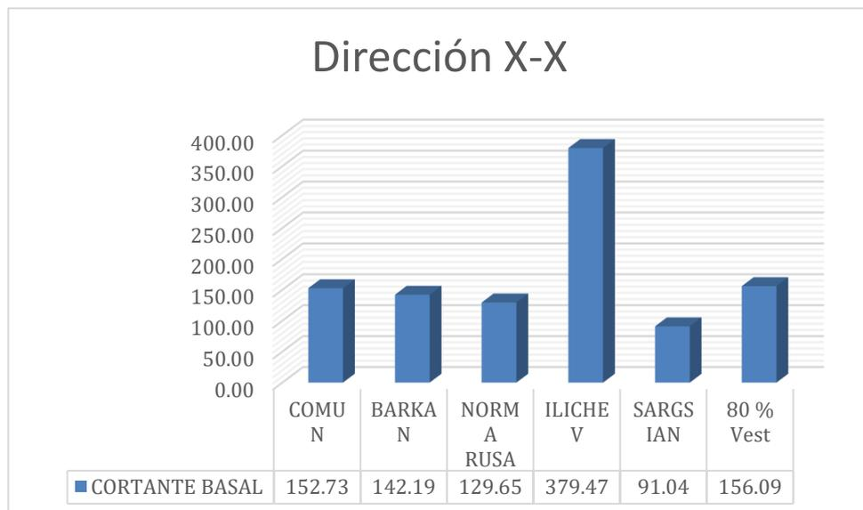
**Figura 80** Comparación de la cortante basal máxima Dirección x.x Tambo
