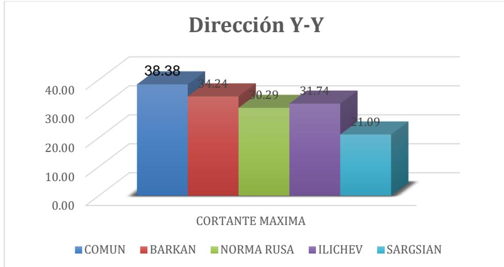
**Figura 95** Comparación de la cortante máxima dirección y.y - Chilca
