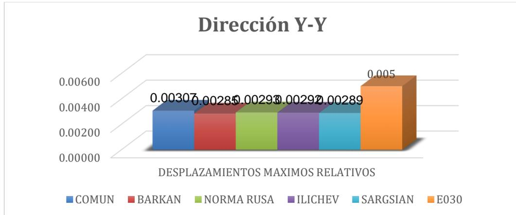
**Figura 89** Comparación derivas de entrepiso Dirección y.y- Chilca
