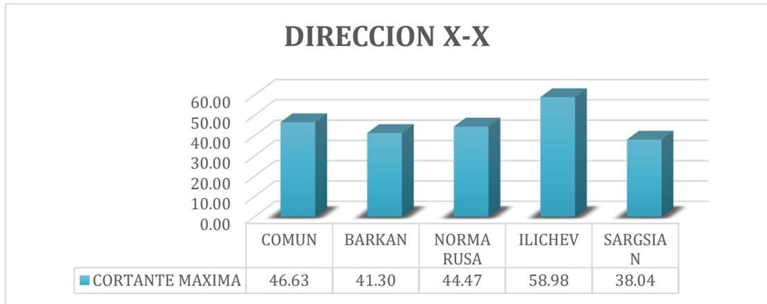
**Figura 70** Comparación de la cortante máxima dirección x.x – Huancayo
