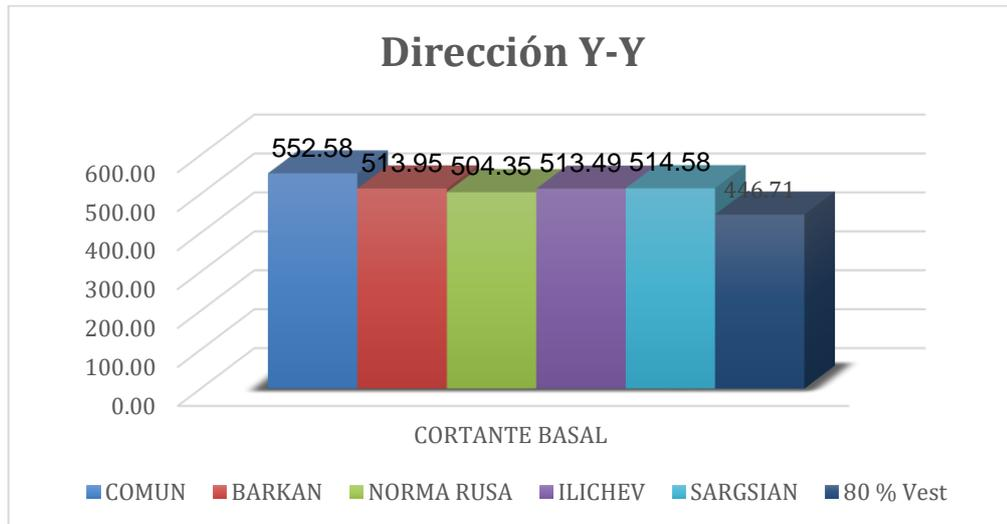
**Figura 93** Comparación de la cortante basal máxima Dirección y.y Chilca
