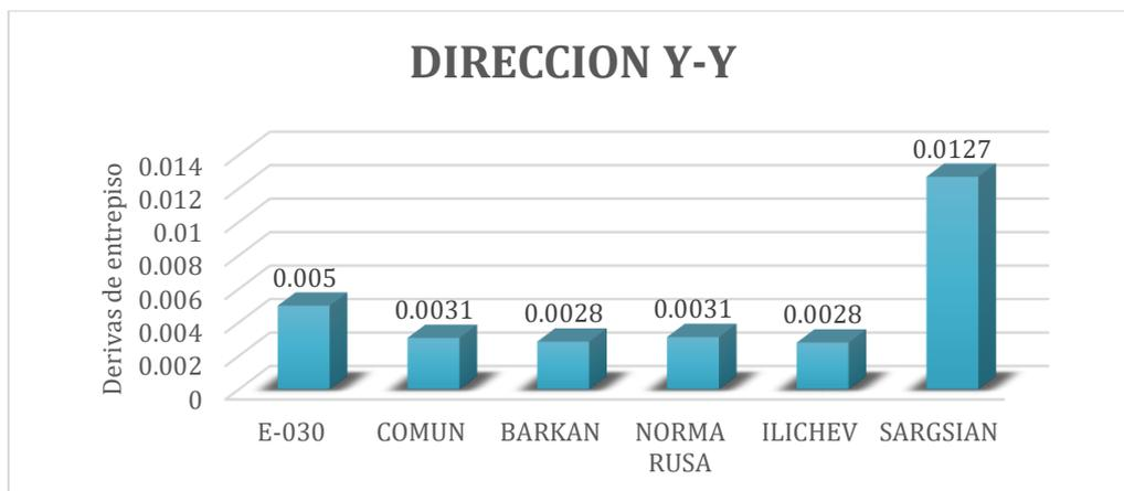
**Figura 65** Comparación derivas de entrepiso Dirección y.y Huancayo
