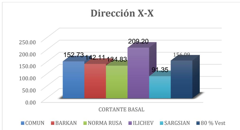
**Figura 92** Comparación de la cortante basal máxima Dirección x.x Chilca
