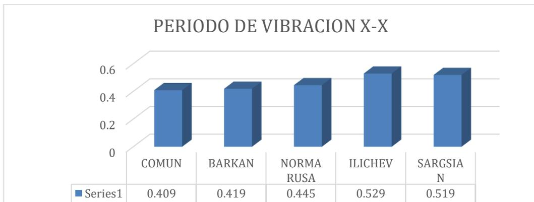
**Figura 78** Comparación de los periodos de vibración Dirección x.x Tambo
