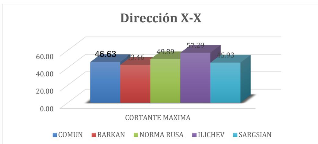
**Figura 94** Comparación de la cortante máxima dirección x.x – Chilca
