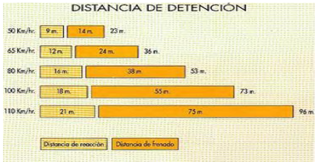
Figura 6. Distancia de frenado respecto a la velocidad Fuente: CONASET, 2016
