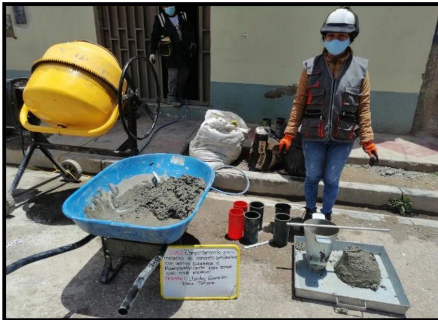
Fotografía 37: Ensayo para la medición de asentamiento del concreto fresco NTP 339.035 – Con 6"- concreto antideslave patrón.
