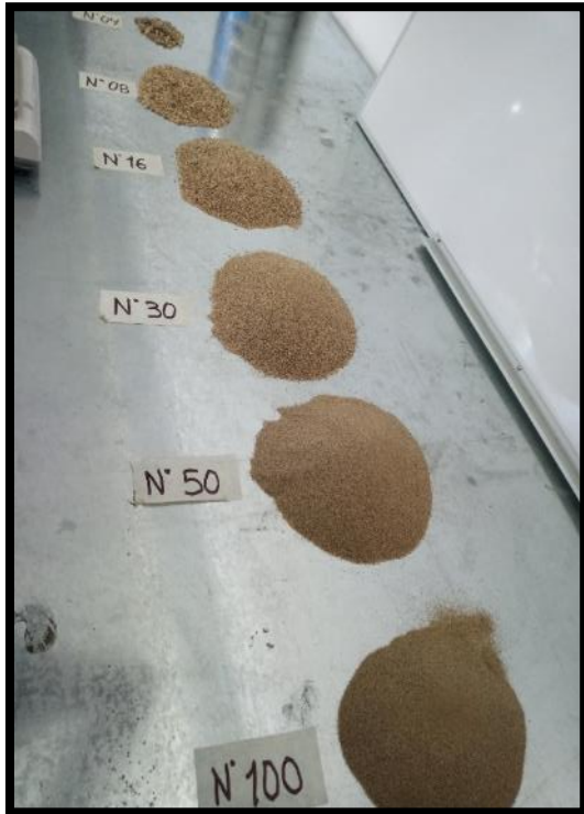
Fotografía 23 y Fotografía 24: Agregado grueso y fino tamizado. Ensayo de granulometría – NTP 400.012
