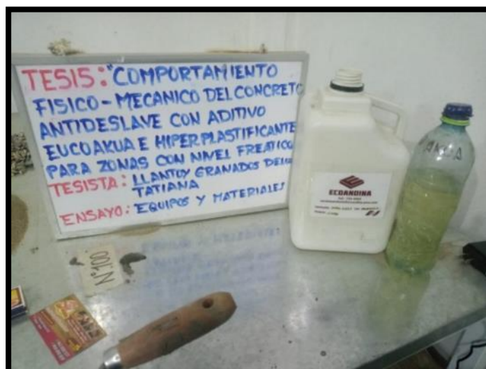
Fotografía 10, Fotografía 11 y Fotografía 12: Materiales para la realización el concreto antideslave agregados grueso y fino, cemento Andino Tipo I y aditivos Euco akua e hiperplastificantes - Ecoandina
