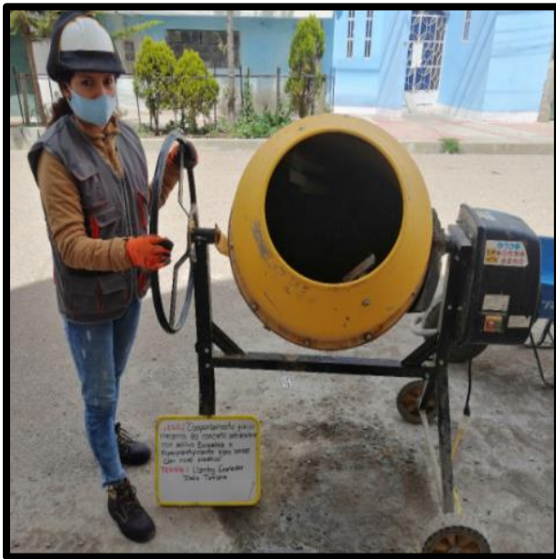
Fotografía 32 y Fotografía 33: Elaboración de concreto antideslave patrón sin aditivos – materiales en el trompo para su mezclado.
