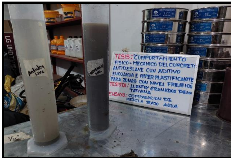
Fotografía 65, Fotografía 66 y Fotografía 67: Ensayo de comparación de mezcla bajo agua (NTP 339.088).
