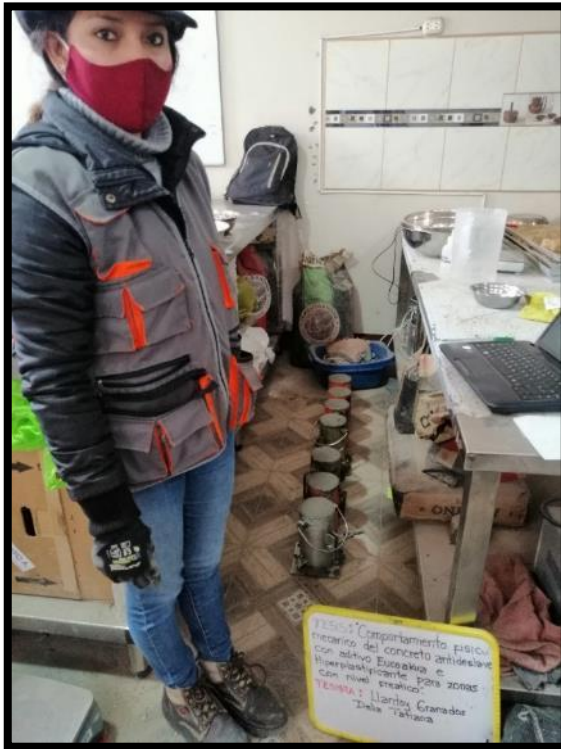
Fotografía 56 y Fotografía 57: Ensayo para el método para la elaboración de probetas cilíndricas NTP 339.033 con el concreto antidslave con aditivos Euco Akua e Hiperplastificante. Donde se tendrá probetas secando a temperatura ambiente.
