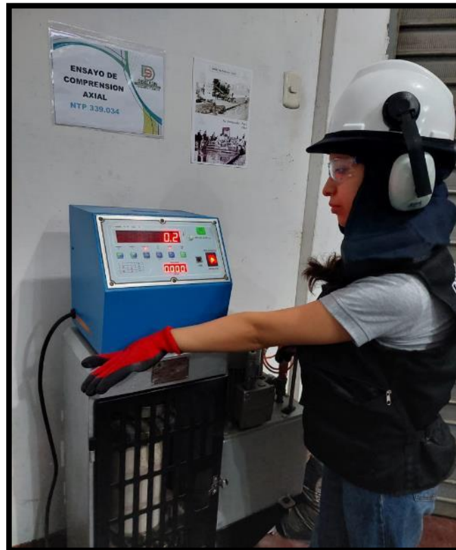
Fotografía 60: Ensayo de compresión axial de probetas cilíndricas NTP 339.034
