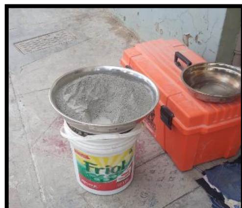
Fotografía 27, Fotografía 28, Fotografía 29 y Fotografía 30: Realizando los pesajes del agregado fino y grueso, agua y cemento, según Diseño de mezcla por módulo de finura para concreto antideslave patrón
