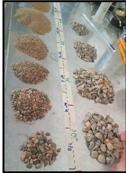
Fotografía 23 y Fotografía 24: Agregado grueso y fino tamizado. Ensayo de granulometría – NTP 400.012
