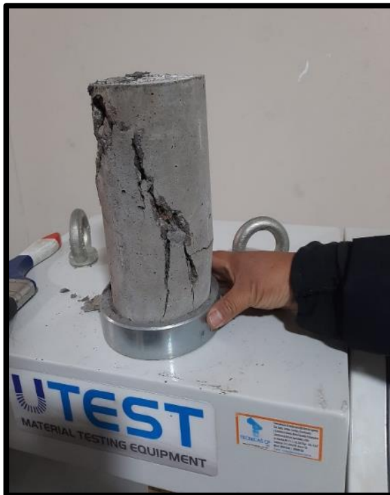
Fotografía 61, Fotografía 62, Fotografía 63 y Fotografía 64: Ensayo de la resistencia a compresión de probetas de concreto (NTP 339.034).
