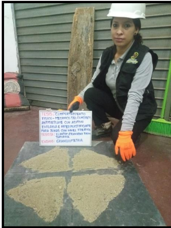
Fotografía 21: Ensayo muestreo de agregado fino y grueso – NTP 400.0.10
