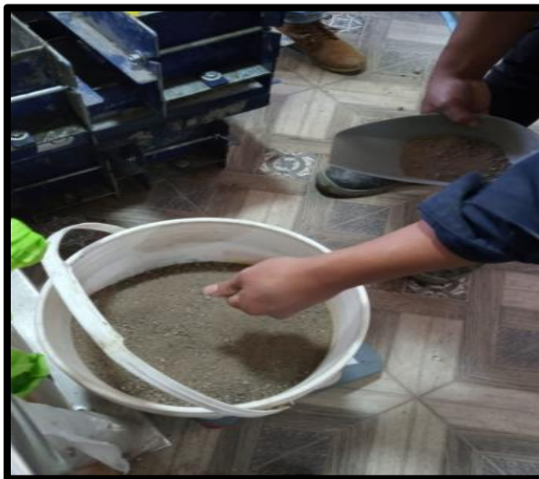
Fotografía 25 y Fotografía 26: Ensayo para determinar la gravedad específica y absorción del agregado fino y grueso (NTP 400.021).
