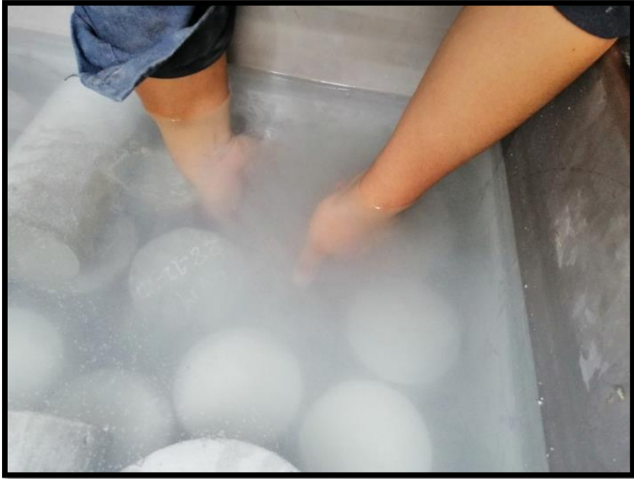
Fotografía 58 y Fotografía 59: Ensayo para el método para la elaboración de probetas cilíndricas NTP 339.033 con el concreto antideslave con aditivos Euco Akua e Hiperplastificante. Donde se tendrá probetas que se sumergió al agua aun siendo concreto fresco
