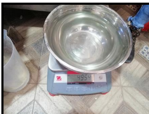
Fotografía 27, Fotografía 28, Fotografía 29 y Fotografía 30: Realizando los pesajes del agregado fino y grueso, agua y cemento, según Diseño de mezcla por módulo de finura para concreto antideslave patrón
