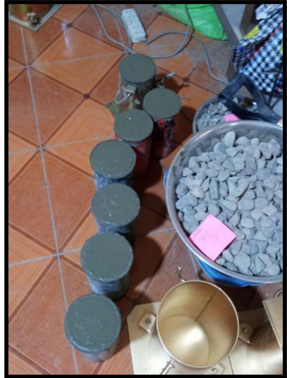
Fotografía 56 y Fotografía 57: Ensayo para el método para la elaboración de probetas cilíndricas NTP 339.033 con el concreto antidslave con aditivos Euco Akua e Hiperplastificante. Donde se tendrá probetas secando a temperatura ambiente.
