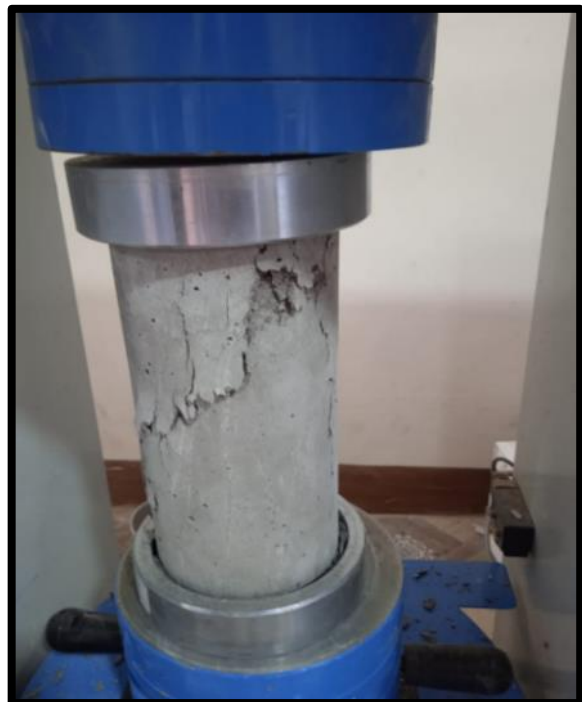
Fotografía 61, Fotografía 62, Fotografía 63 y Fotografía 64: Ensayo de la resistencia a compresión de probetas de concreto (NTP 339.034).
