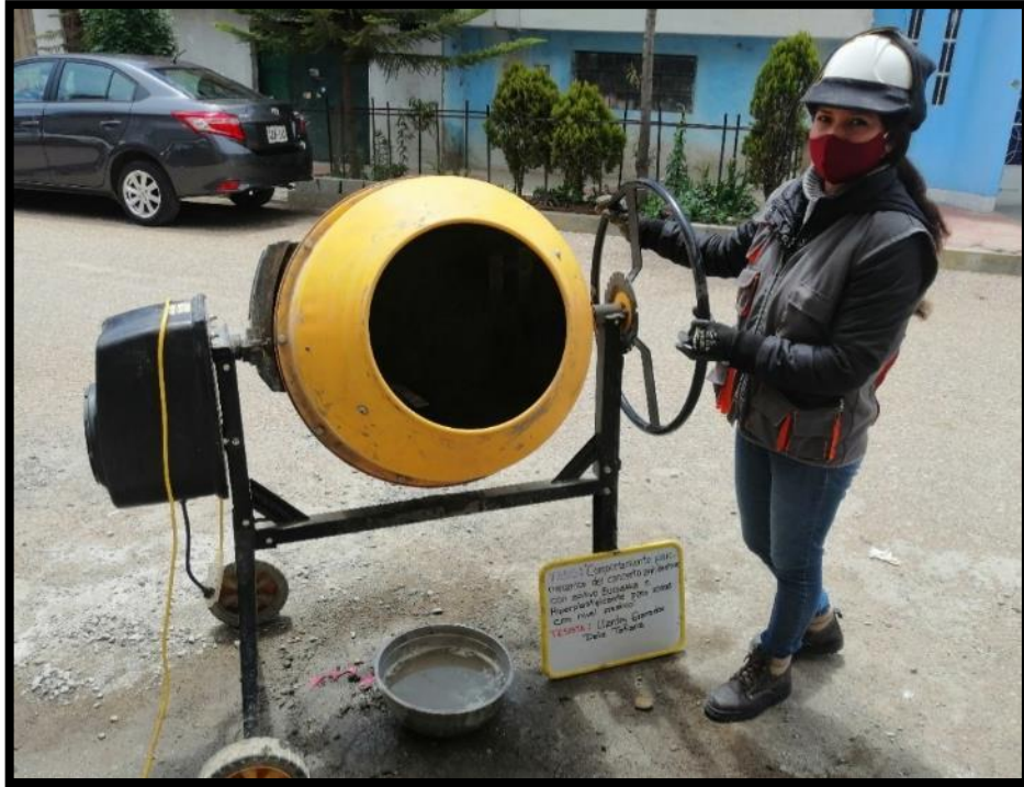
Fotografía 49: Elaboración del concreto antideslave con aditivos Euco akua e hiperplastificante
