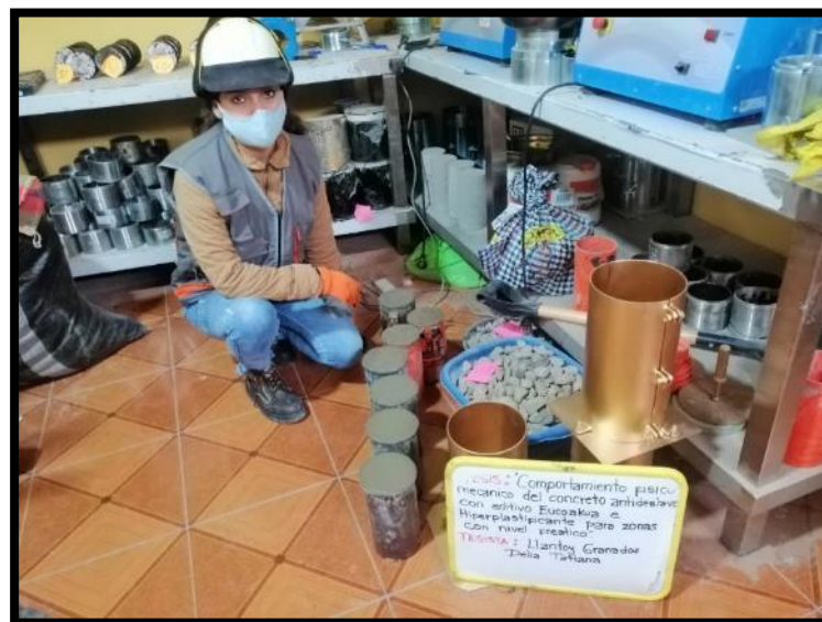
Fotografía 39, Fotografía 40 y Fotografía 41: Ensayo método para la elaboración con probetas cilíndricas. NTP 339.033 – Concreto antideslave patrón
