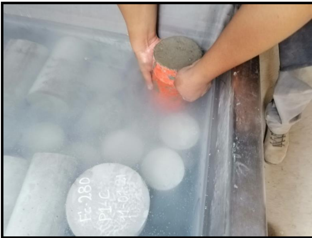
Fotografía 56 y Fotografía 57: Ensayo para el método para la elaboración de probetas cilíndricas NTP 339.033 con el concreto antidslave con aditivos Euco Akua e Hiperplastificante. Donde se tendrá probetas secando a temperatura ambiente.
