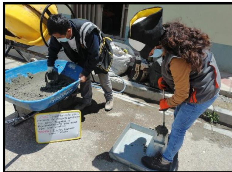
Fotografía 34, Fotografía 35 y Fotografía 36: Ensayo para la medición del asentamiento del concreto fresco NTP 339.035 – concreto antideslave patrón sin aditivos.
