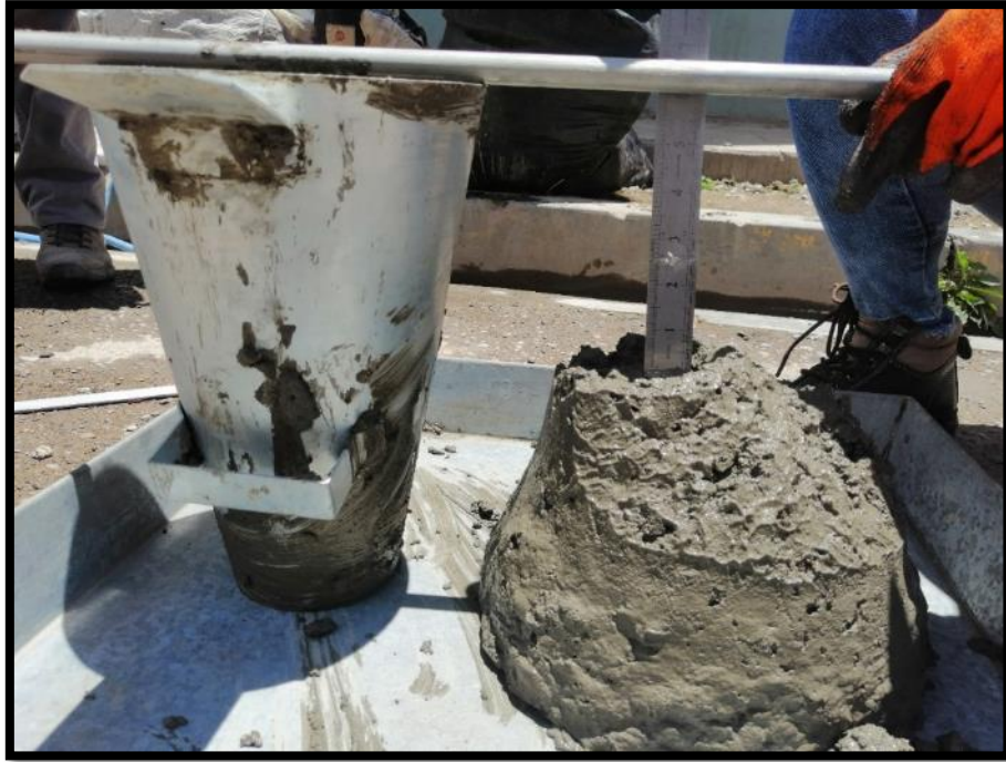
Fotografía 37: Ensayo para la medición de asentamiento del concreto fresco NTP 339.035 – Con 6"- concreto antideslave patrón.
