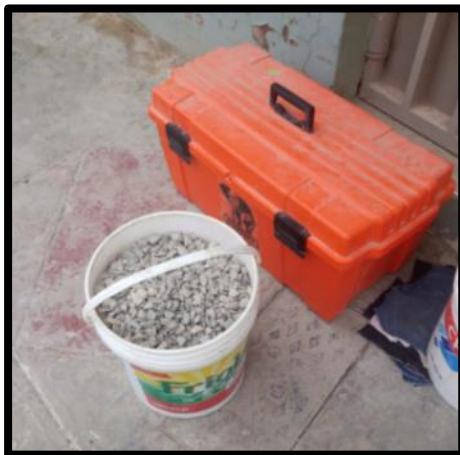
Fotografía 43, Fotografía 44 y Fotografía 45: Pesos de agregado fino, agregado grueso y agua. Según el diseño de mezcla por método de finura para concreto antideslave con aditivos.
