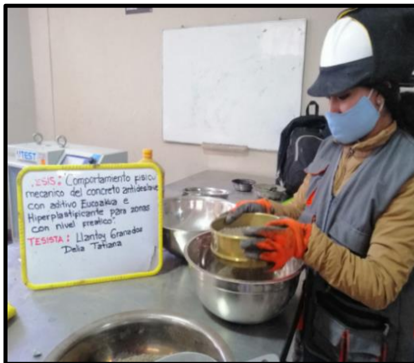
Fotografía 22: Tamizado de agregados – Ensayo de granulometría – NTP 400.012
