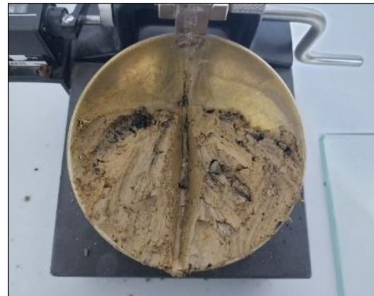
Fotografía 44 y Fotografía 45. Ensayo de límite líquido del suelo con 8 % de emulsión asfáltica catiónica.
