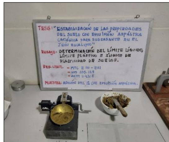
Fotografía 64 y Fotografía 65. Ensayo de límite líquido al suelo con 12 % de emulsión asfáltica catiónica.
