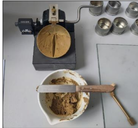
Fotografía 30 y Fotografía 31. Ensayo para determinar el límite líquido del suelo.
