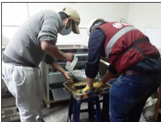
Fotografía 38 y Fotografía 39. Mezclado de la emulsión asfáltica con el suelo.
