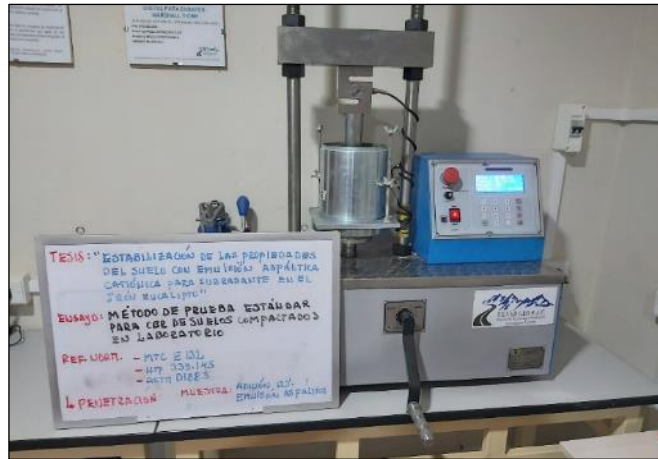
Fotografía 61, Fotografía 62 y Fotografía 63. Ensayo de CBR al suelo con adición de 12 % de emulsión asfáltica.
