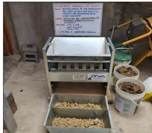
Fotografía 26 y Fotografía 27. Cuarteo mecánico de muestras de suelo.
