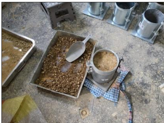
Fotografía 40 y Fotografía 41. Vista de muestras compactadas para el ensayo de Proctor modificado.
