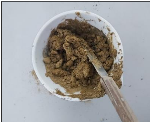
Fotografía 44 y Fotografía 45. Ensayo de límite líquido del suelo con 8 % de emulsión asfáltica catiónica.
