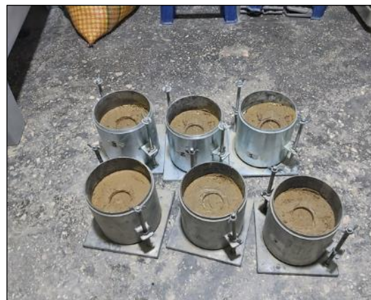
Fotografía 52 y Fotografía 53. Ensayo de CBR del suelo con 10 % de emulsión asfáltica catiónica.
