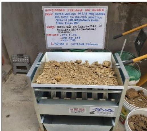
Fotografía 26 y Fotografía 27. Cuarteo mecánico de muestras de suelo.
