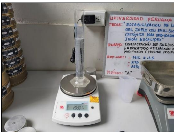
Fotografía 15. Pesado del agua para ser añadida al suelo.
