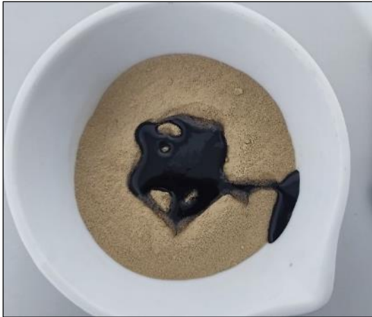
Fotografía 54 y Fotografía 55. Ensayo de límite líquido del suelo con 10 % de emulsión asfáltica catiónica.
