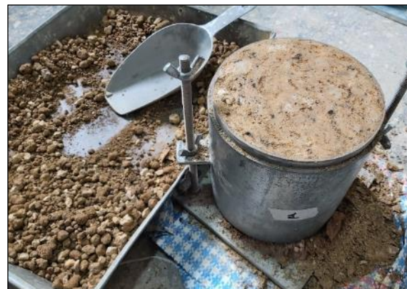
Fotografía 40 y Fotografía 41. Vista de muestras compactadas para el ensayo de Proctor modificado.
