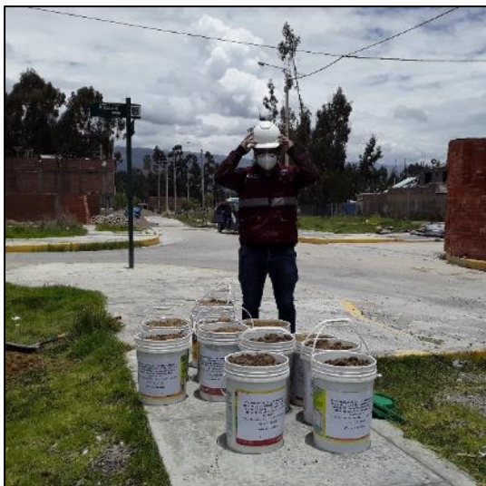
Fotografía 23 y Fotografía 24. Vista del material extraído de la calicata y traslado del mismo al laboratorio de mecánica de suelos.
