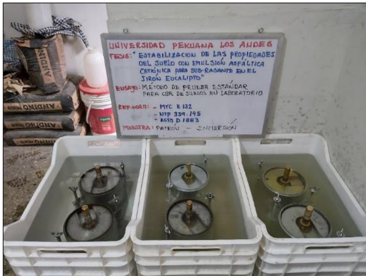
Fotografía 20. Inmersión de los moldes durante 96 horas.
