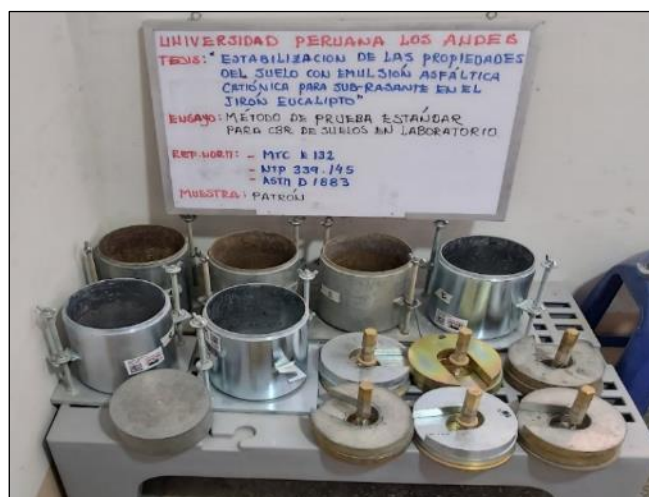
Fotografía 17. Moldes y pesas de carga para la ejecución del ensayo CBR.
