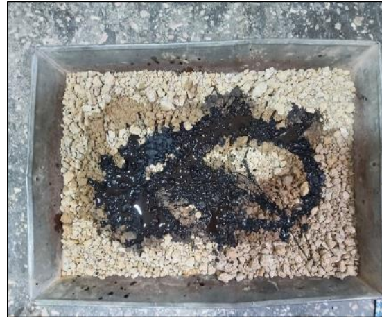
Fotografía 57 y Fotografía 58. Dosificación y mezclado de 12 % de emulsión asfáltica al suelo.
