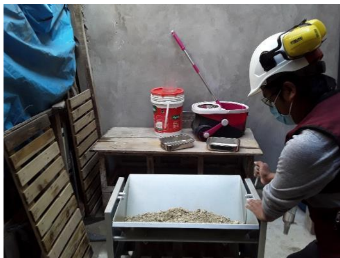
Fotografía 4. Cuarteo mecánico para la obtención de muestras representativas.
