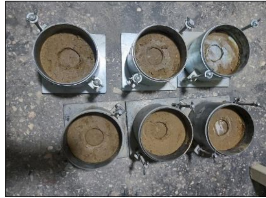
Fotografía 42 y Fotografía 43. Ensayo de CBR de muestras de suelo con 8 % de emulsión asfáltica catiónica.
