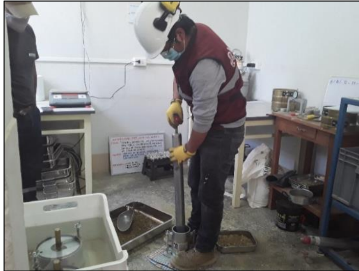
Fotografía 16. Compactación del suelo por capas.
