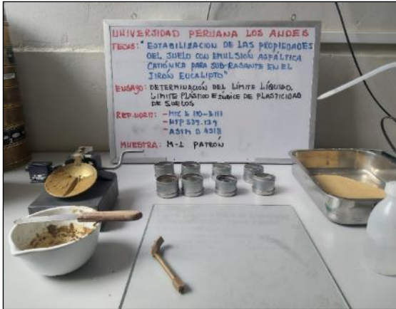
Fotografía 30 y Fotografía 31. Ensayo para determinar el límite líquido del suelo.
