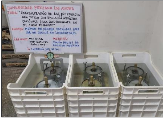
Fotografía 42 y Fotografía 43. Ensayo de CBR de muestras de suelo con 8 % de emulsión asfáltica catiónica.
