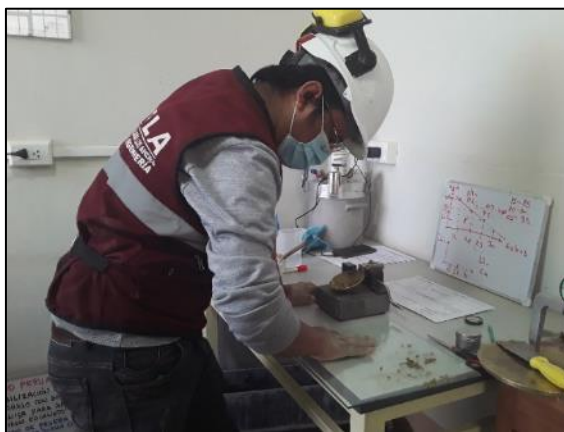
Fotografía 13. Ejecución del ensayo para determinar el límite plástico del suelo.
