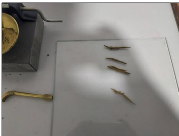
Fotografía 66. Ensayo de límite plástico del suelo con 12 % de emulsión asfáltica catiónica.
