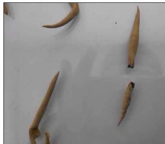
Fotografía 46 y Fotografía 47. Ensayo de límite plástico del suelo con 8 % de emulsión asfáltica catiónica.
