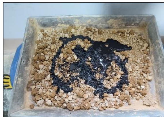
Fotografía 38 y Fotografía 39. Mezclado de la emulsión asfáltica con el suelo.
