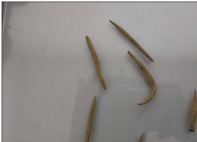
Fotografía 56. Ensayo de límite plástico del suelo con 10 % de emulsión asfáltica catiónica.
