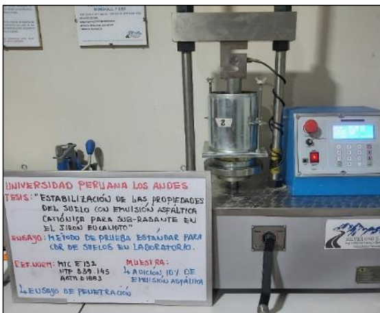
Fotografía 52 y Fotografía 53. Ensayo de CBR del suelo con 10 % de emulsión asfáltica catiónica.
