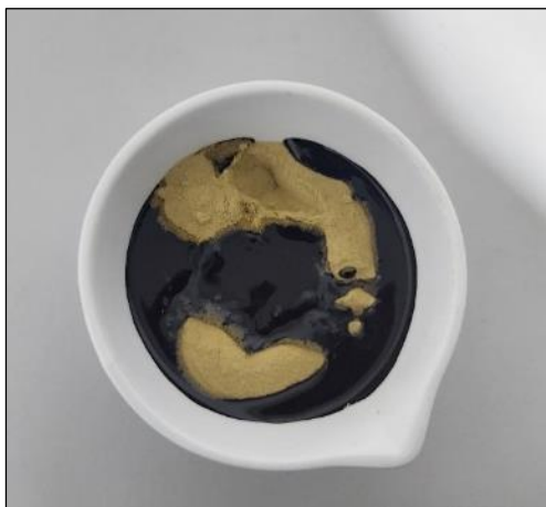
Fotografía 64 y Fotografía 65. Ensayo de límite líquido al suelo con 12 % de emulsión asfáltica catiónica.
