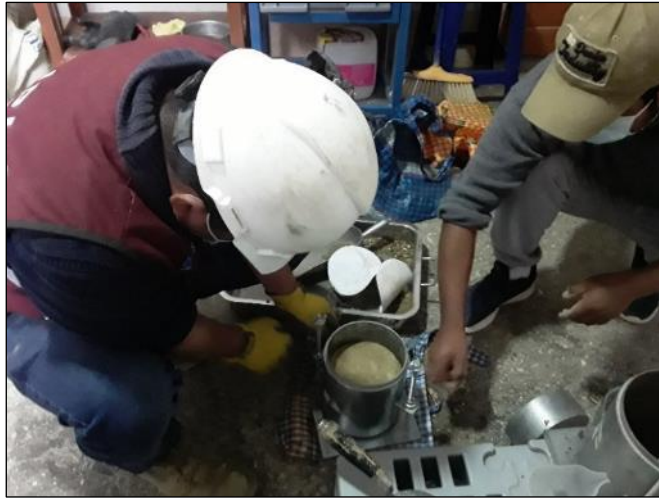
Fotografía 18. Compactación del suelo para el ensayo CBR.
