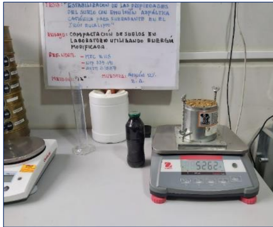
Fotografía 59 y Fotografía 60. Ensayo de Proctor modificado al suelo con 12 % de emulsión asfáltica catiónica.
