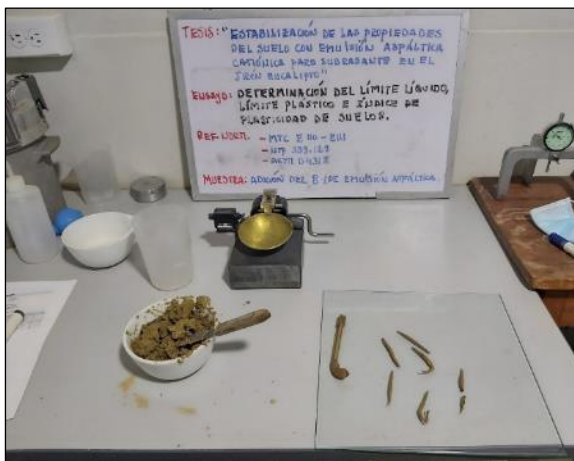
Fotografía 46 y Fotografía 47. Ensayo de límite plástico del suelo con 8 % de emulsión asfáltica catiónica.
