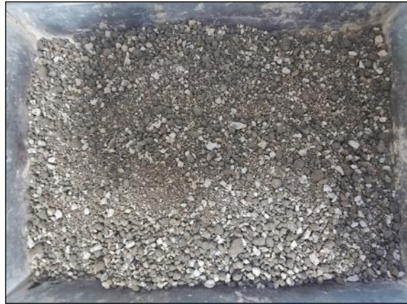
Fotografía 48 y Fotografía 49. Vista de la dosificación y muestra de suelo con 10 % de emulsión asfáltica catiónica.
