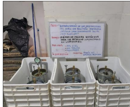
Fotografía 59 y Fotografía 60. Ensayo de Proctor modificado al suelo con 12 % de emulsión asfáltica catiónica.
