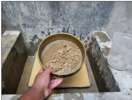
Fotografía 8. Lavado del suelo con empleo de la malla N° 200.
