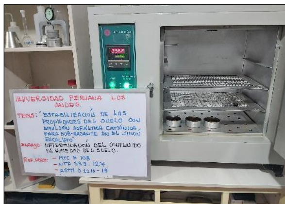
Fotografía 5. Ensayo para determinación de la humedad natural del suelo.
