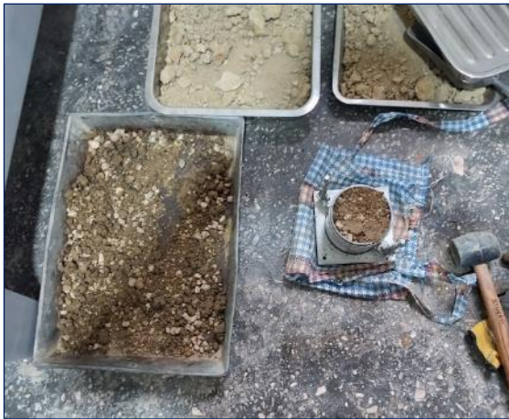
Fotografía 59 y Fotografía 60. Ensayo de Proctor modificado al suelo con 12 % de emulsión asfáltica catiónica.
