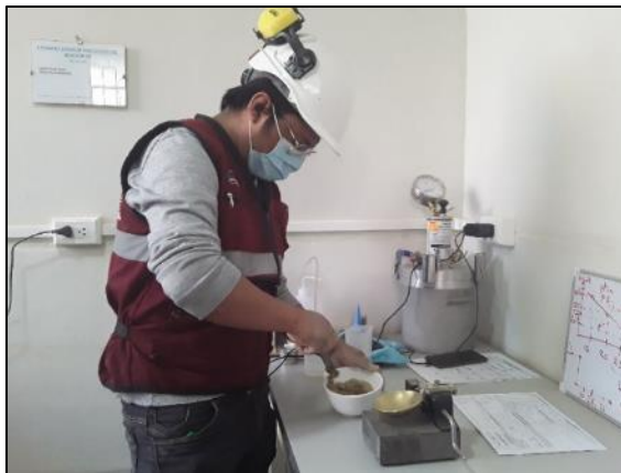
Fotografía 12. Ejecución del ensayo para determinar el límite líquido del suelo.
