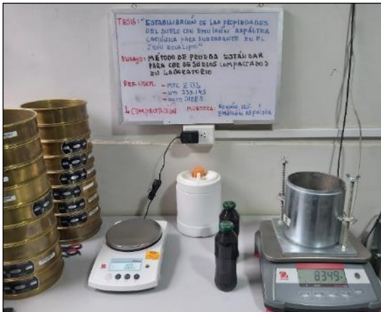
Fotografía 59 y Fotografía 60. Ensayo de Proctor modificado al suelo con 12 % de emulsión asfáltica catiónica.
