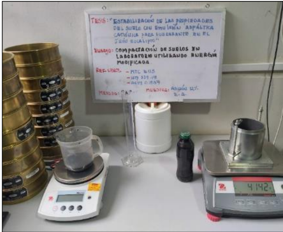
Fotografía 57 y Fotografía 58. Dosificación y mezclado de 12 % de emulsión asfáltica al suelo.
