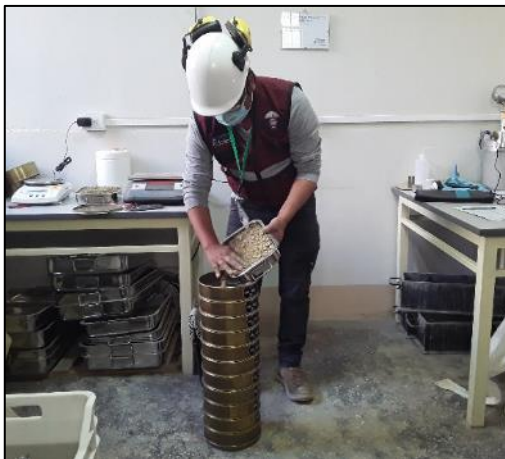
Fotografía 28 y Fotografía 29. Tamizado y pesado de material retenido por malla.
