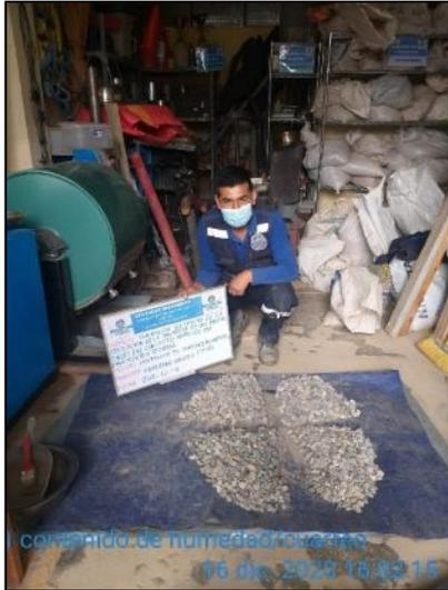
Fotografía 1. Cuarteo del agregado grueso para determinar el contenido de humedad según ASTM C-566.
