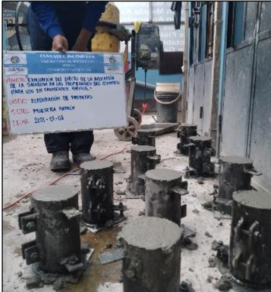
Fotografía 13. Vista de la elaboración de las probetas de concreto patrón para el ensayo de resistencia a compresión según la NTP 339.183.
