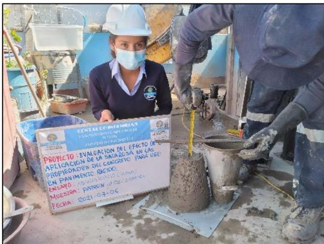
Fotografía 9. Medición del slump del concreto más 0.05 % de sacarosa siguiendo la NTP 339.035.
