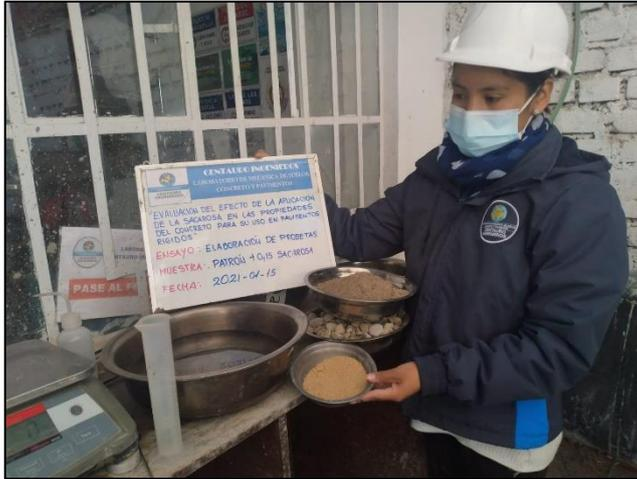
Fotografía 7. Elaboración de probetas de concreto más 0.15 % de sacarosa.
