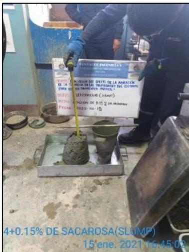
Fotografía 11. Medición del slump del concreto más 0.15 % de sacarosa siguiendo la NTP 339.035.
