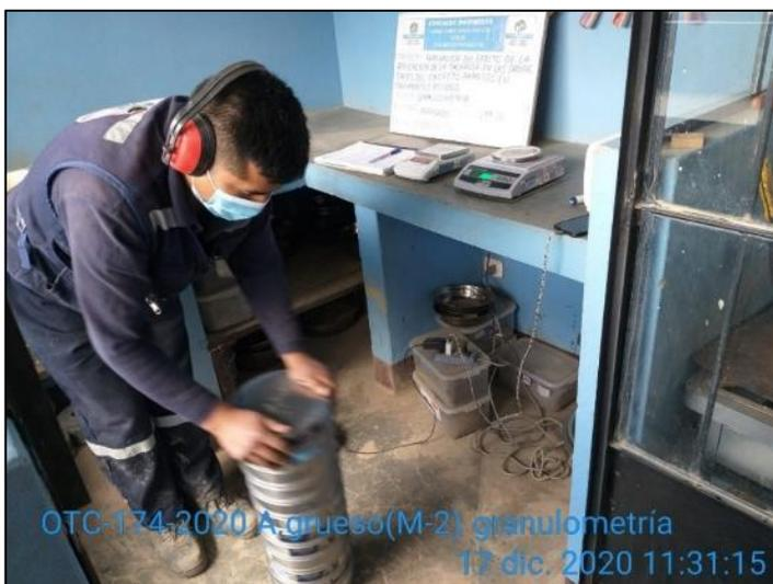
Fotografía 3. Análisis granulométrico del agregado grueso acorde al ASTM C136/C136M.
