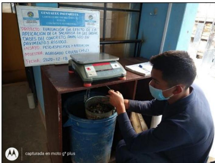
Fotografía 5. Determinación del peso específico y absorción del agregado grueso según el MTC E206.
