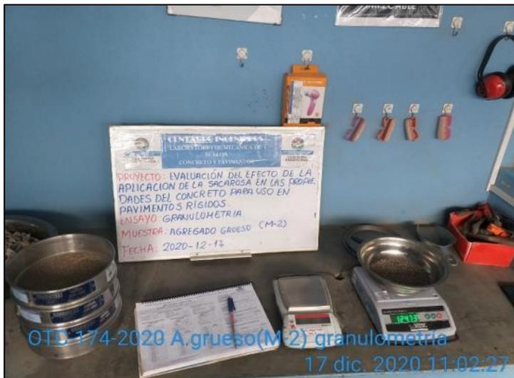
Fotografía 4. Pesado del agregado grueso retenido por tamiz para el análisis granulométrico acorde al ASTM C136/C136M.
