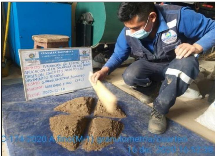
Fotografía 2. Cuarteo del agregado fino para el ensayo de granulometría según el ASTM C136/C136M..
