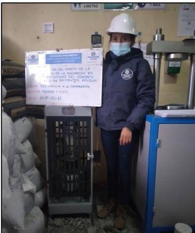
Fotografía 15. Rotura de probetas del concreto con adición de 0.10 % de sacarosa según la norma ASTM C39/C39M -20.
