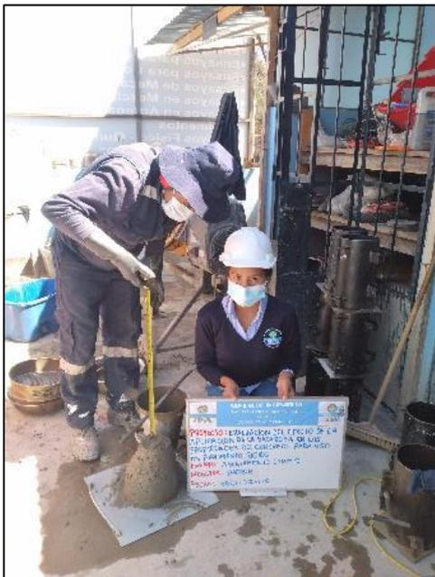
Fotografía 8. Medición del slump del concreto patrón siguiendo la NTP 339.035.
