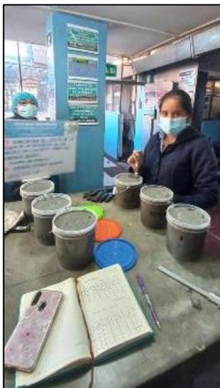
Fotografía 12. Medición del tiempo de fragua del concreto patrón acorde a la NTP 339.082.
