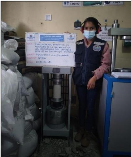
Fotografía 14. Rotura de probetas del concreto patrón según la norma ASTM C39/C39M -20.
