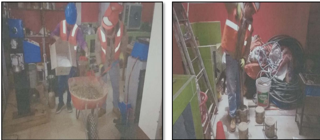
Imagen 7: CBR con poliestireno extruido. Fuente: Propia
