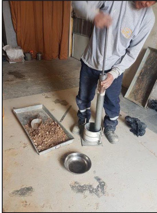
Imagen 6: Compactación de material de .
