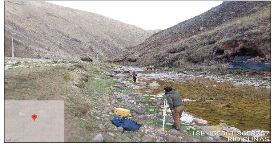
FOTO N° 10: CAMBIO DE PUNTO DE ESTACIÓN PARA FINALIZACIÓN DEL LEVANTAMIENTO TOPOGRAFICO DEL RIO CUNAS.
