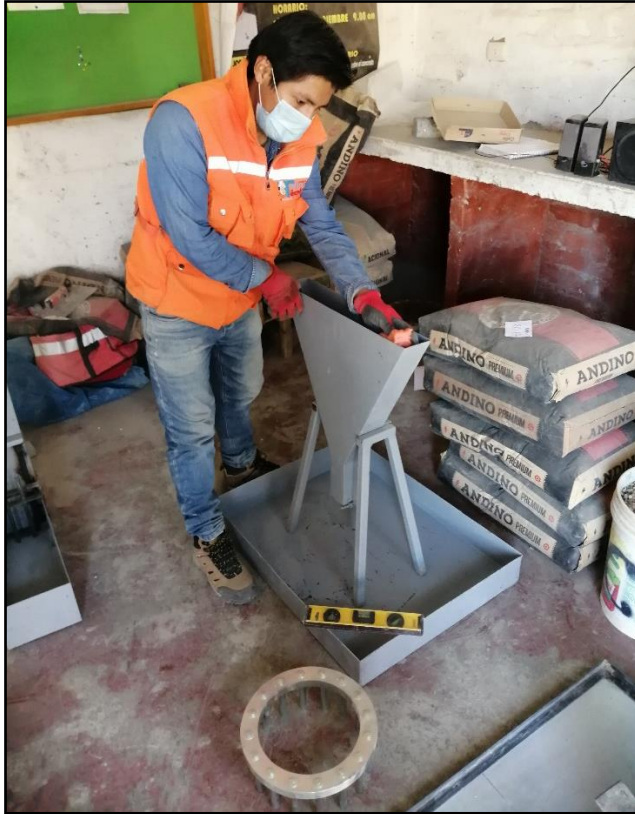
Figura 4.2 Midiendo el flujo de Asentamiento ensayo anillo J
