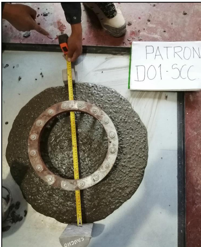
Figura 4.2 Midiendo el flujo de Asentamiento ensayo anillo J
