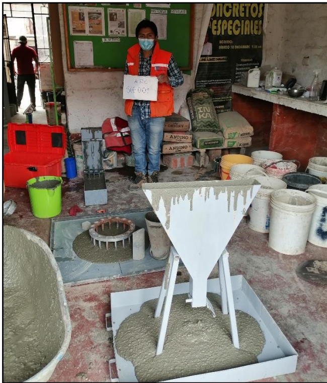
Figura 4.4 Ensayo contenido de aire
