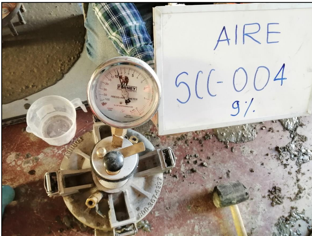
Figura 4.4 Ensayo contenido de aire
