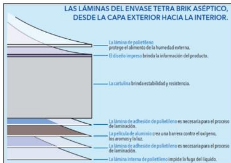
Figura 5. Capas según su funcionalidad
