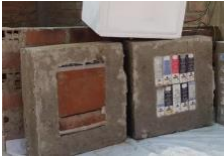
Figura 157. Losa aligerada para ensayo de 60cmx65cm.
