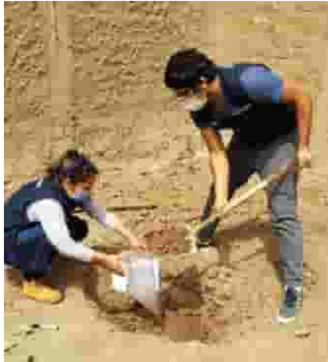
Figura 23. Toma de muestra para ensayos de propiedades físicas y mecánicas en laboratorio.
