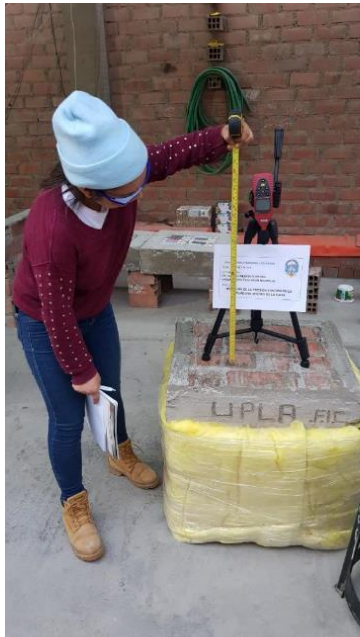
Figura 202. Medición de absorción acústica de murete pandereta.
