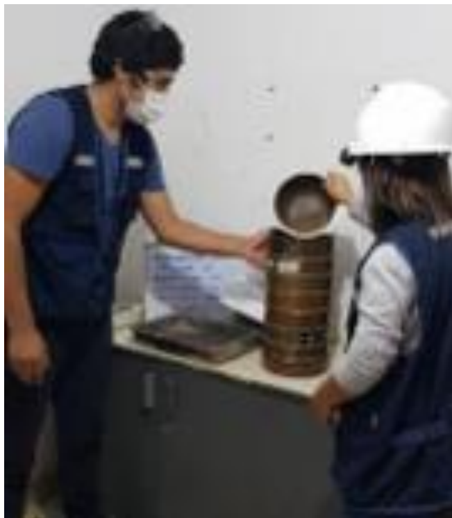
Figura 122. Ensayo de granulometría de la muestra de arcilla.
