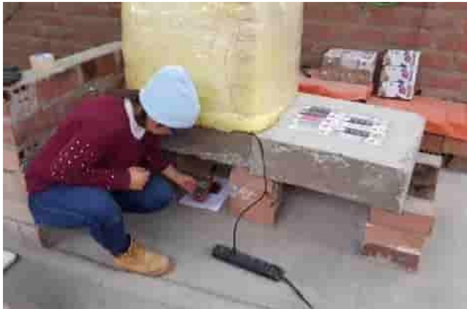
Figura 212. Configurando sonómetro para medición.
