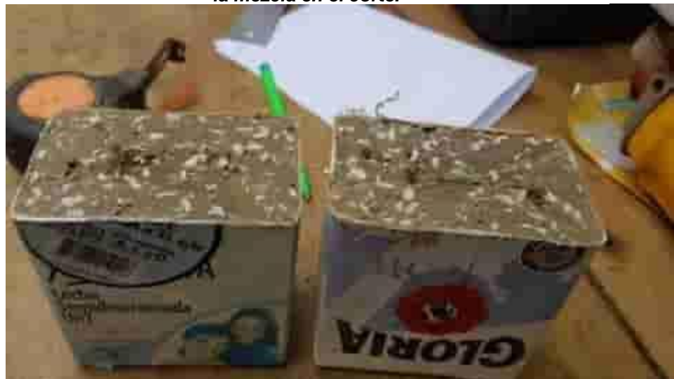
Figura 241. Piezas cortadas donde se muestra uniformidad de la mezcla en el corte.
