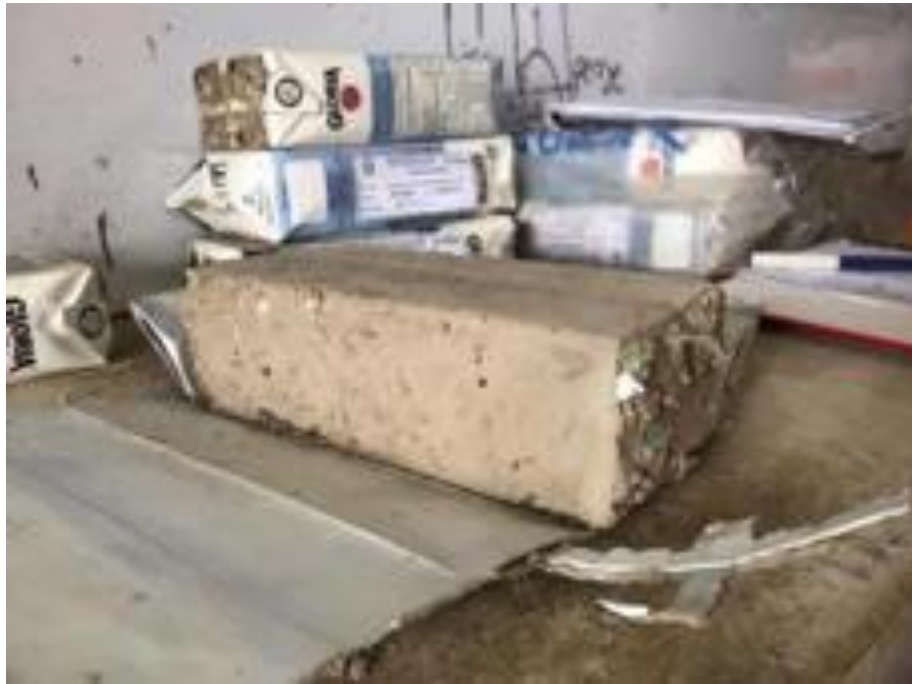
Figura 140. Muestra sin empaque para ensayo a Compresión.
