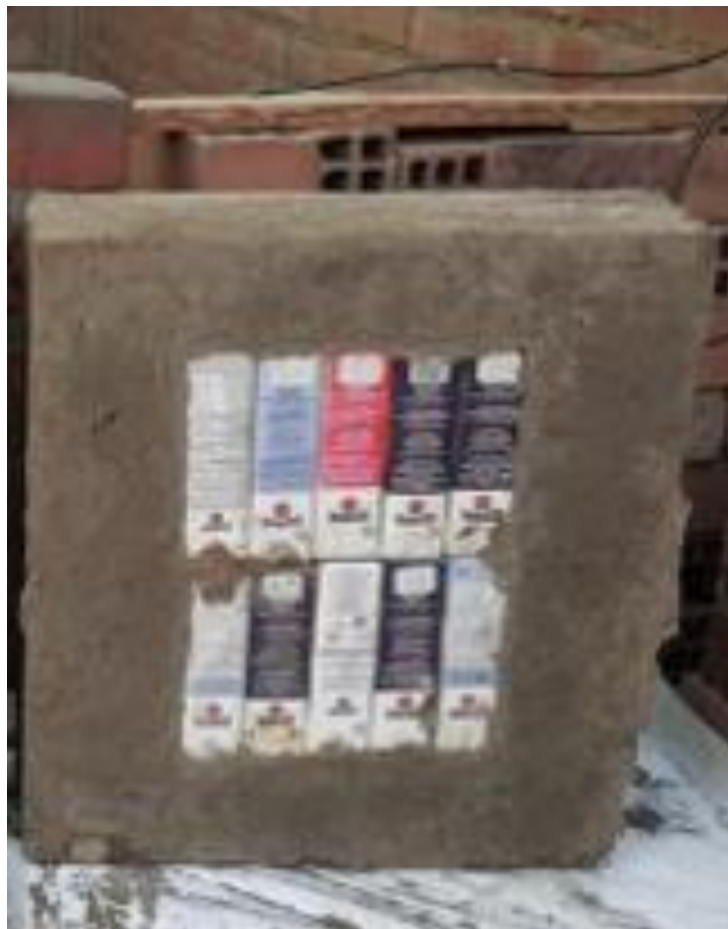
Figura 185. Espécimen de losa aligerada con eco bloques terminado y secando.
