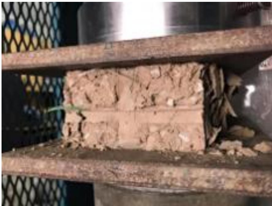
Figura 143. Muestra con inicio de deformación durante ensayo de Compresión.
