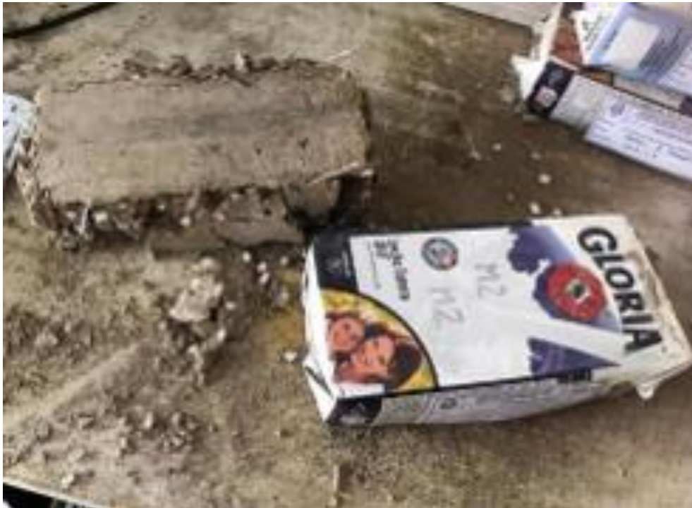
Figura 146. Vista de salida de ensayo de compresión de 2 eco ladrillos con caja y sin caja.
