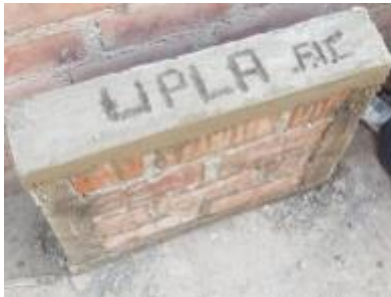
Figura 169. Murete listo para ensayo acústico.
