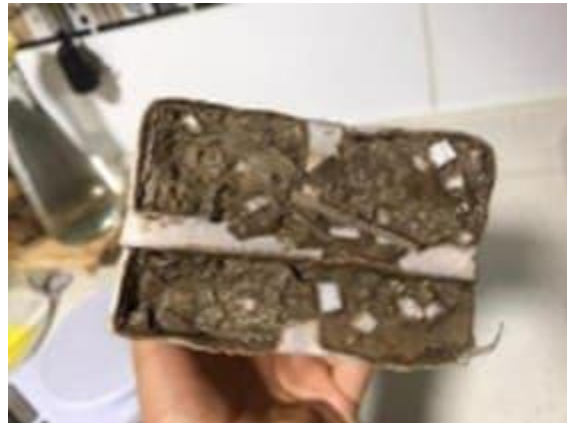
Figura 114. Cara de llenado de Eco ladrillo por donde absorbió mayor cantidad de agua.
