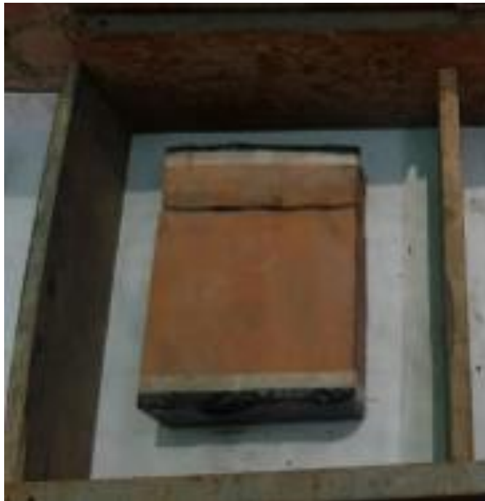
Figura 176. Espécimen de losa aligerada listo para vaciar.
