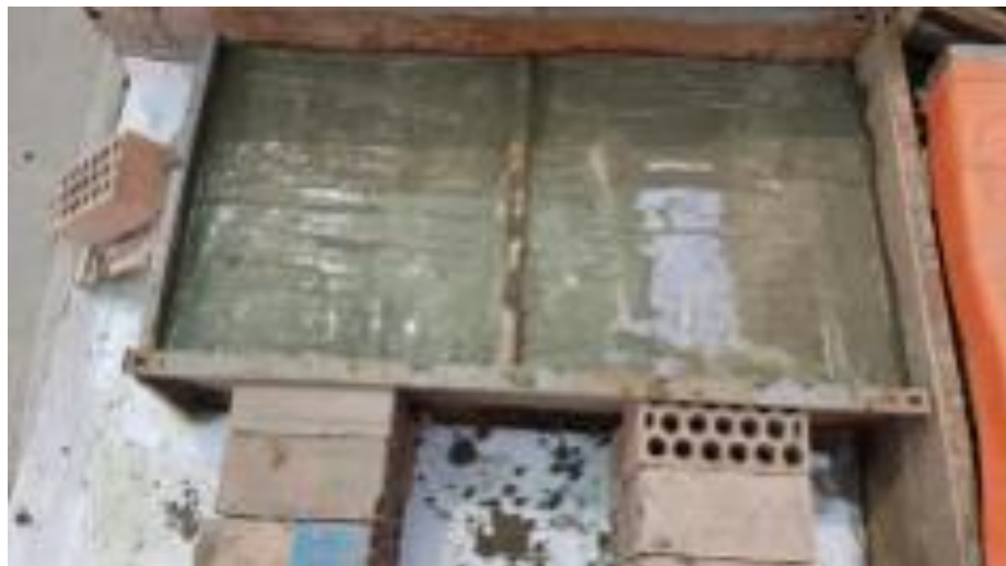
Figura 180. Espécimen de losa aligerada terminado y fraguando.
