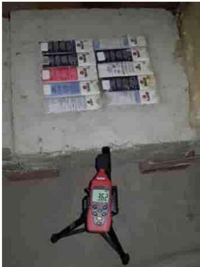
Figura 207. Losa aligerada lista para medición acústica.
