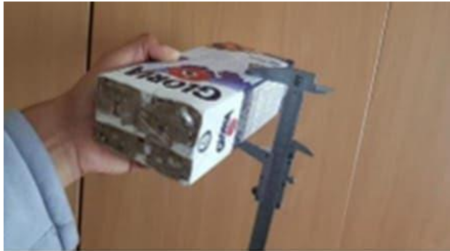
Figura 109. Se tomó 4 medidas de las alturas, cada medida en el centro de cada lado de la cara de asiento.
