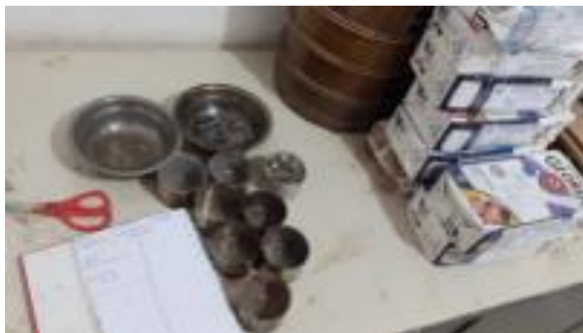
Figura 149. Taras para inicio de ensayo de humedad en laboratorio.
