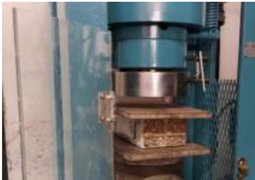
Figura 137. Primera muestra M1 en la máquina de ensayo a compresión.
