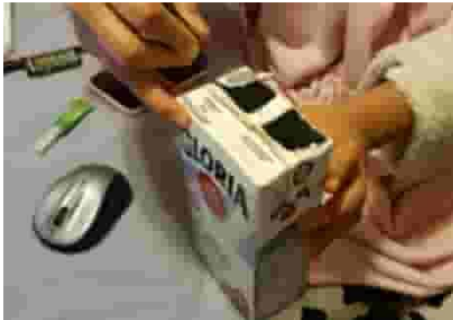
Figura 68. Corte de aberturas para ingresar y compactar la mezcla de los eco ladrillos.
