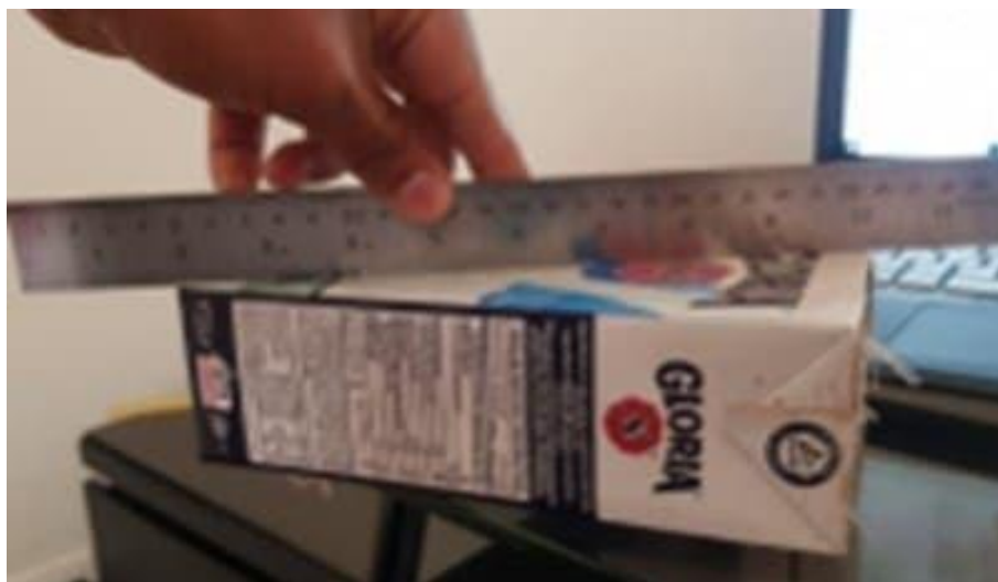
Figura 105. Verificación de concavidad y convexidad con regla metálica.
