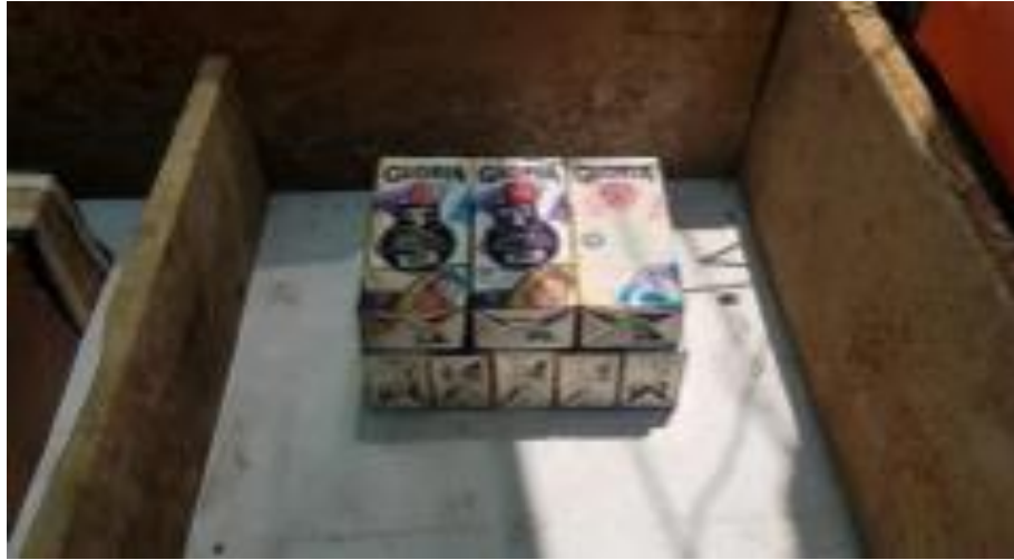
Figura 182. Espécimen de losa aligerada con eco bloque listo para vaciar.
