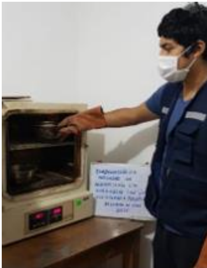
Figura 124. Muestra colocada al horno a 110^{\circ}\text{C} \pm 5^{\circ}\text{C}
