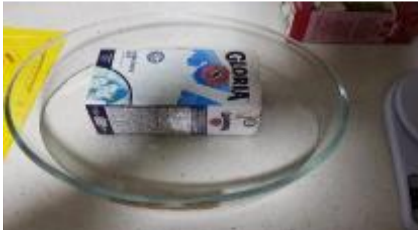
Figura 118. Eco ladrillo sumergido en agua con 3 mm de altura.
