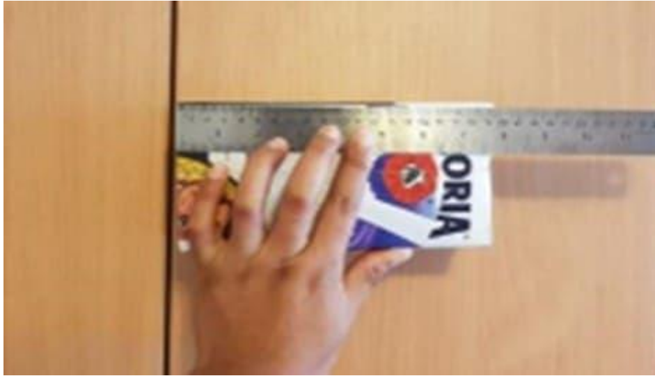
Figura 107. Toma de 4 medidas de longitudes, 2 por cada cara.
