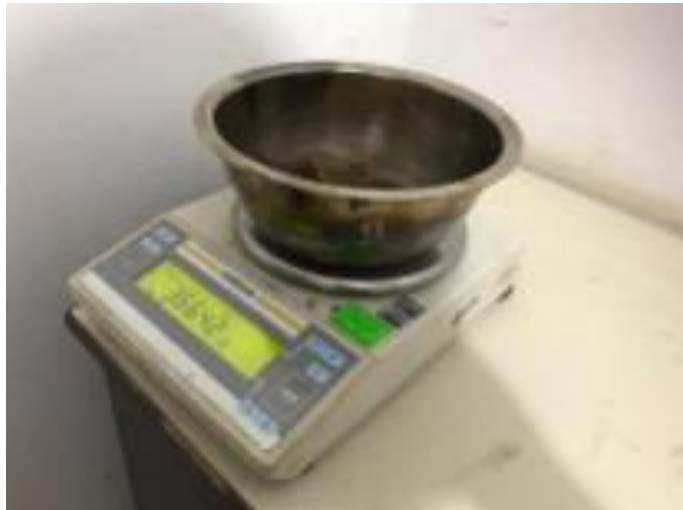
Figura 123. Pesaje de la muestra de arcilla para calcular el contenido de humedad.
