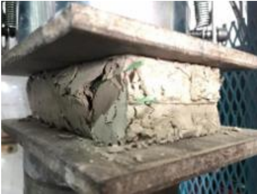
Figura 144. Muestra con 1cm de deformación en ensayo de Compresión.
