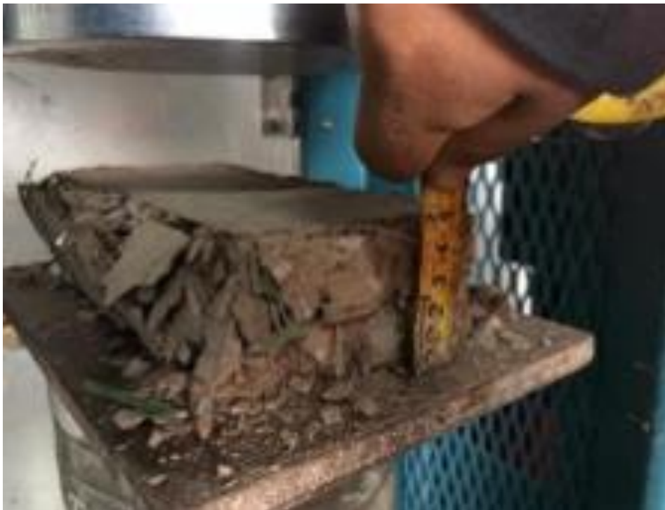
Figura 145. Toma de datos finales del ensayo de Compresión de eco ladrillo sin caja.
