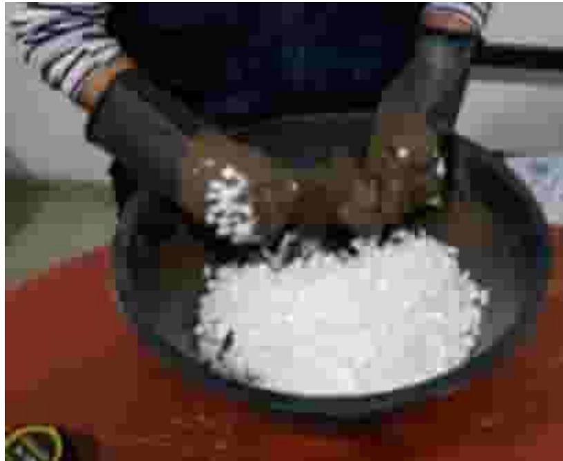
Figura 76. Mezcla de agua, cemento, arcilla, PET y poliestireno.
