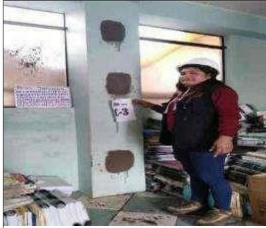
despues de colocacion de mezcla en los tres 3 ubicaciones del ensayo de esclerometro
