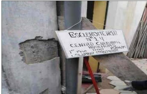
columna esquinada C-2 se observa la ubicaciones de 25x25 cm sin revestimiento y marcado de 10 puntos a 1" para el disparo del ensayo de esclerometria en en lado inferior
