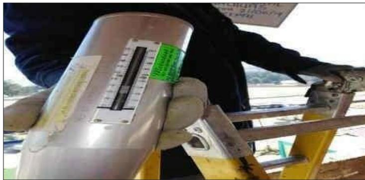
columna esquinada C-4 se observa el dato en el esclerometro despues de tomar el disparo
