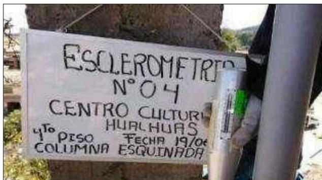
columna esquinada C-4 se observa el dato en el esclerometro despues de tomar el disparo
