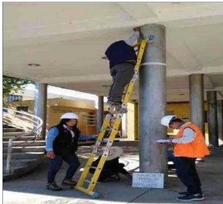
columna circular céntrica C-7 se observa trazado de las tres 3 ubicaciones superior, medio e inferior de 25 x 25 cm empezando con el disparo en el lado inferior
