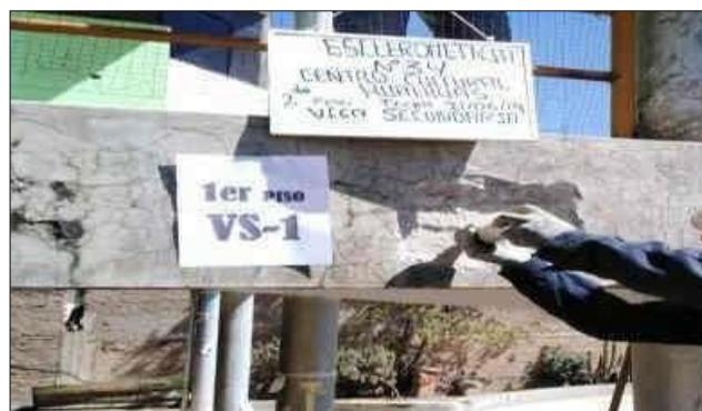
representación del ensayo con el martillo de rebote en la viga secundaria de 25 x 25 cm empezando con el disparo en el lado derecho
