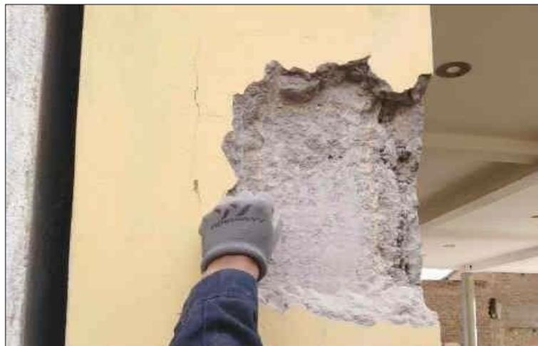
columna esquinada C-1 se quita el revestimiento de 25x25 cm hasta llegar al concreto de la estructura para poder empezar con el ensayo esclerométrico (no destructivo)
