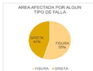
Dicha figura muestra y confirma lo indicado en la descripción anterior, en donde un 55.00% corresponde a columnas fisuradas del 45.00% a grietas, de igual manera las grietas son de severidad moderada, en donde el rango de agrietamiento es de 0.50 a 1.00 mm.
