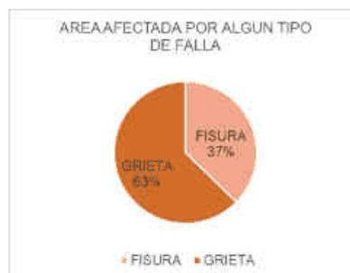
Resultados de la figura muestra confirma lo indicado en la descripción anterior, en donde un 37.00% corresponde a columnas fisuradas, el 63.00%”, a grietas, de igual manera las grietas son de severidad moderado, en donde el rango de agrietamiento es de 0.50 a 1.00 mm.
