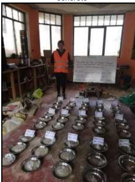
Fotografía 15.- Muestras a ensayar con el porcentaje convencional de polvo de concreto
