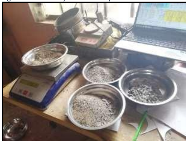
Fotografía 11.- Ensayo Cántabro para un Diseño de Mezcla
