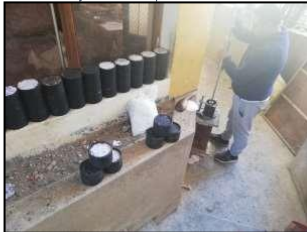
Fotografía 13.- Ensayo Cántabro para un Diseño de Mezcla al 1.5%
