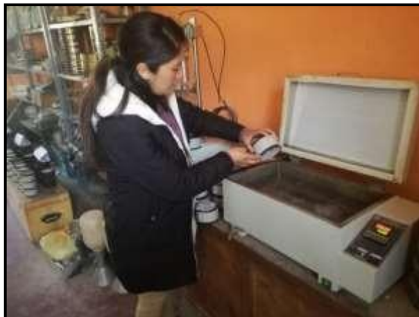
Fotografía 17.- Ensayo de Baño María para las briquetas elaboradas
