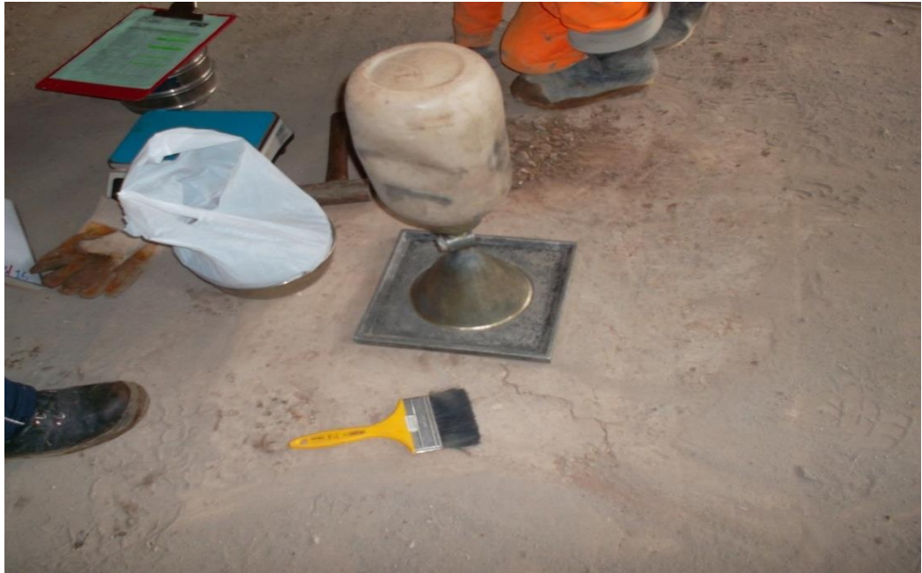
Ensayo de Cono de arena en el Jr. Aguirre Morales.
