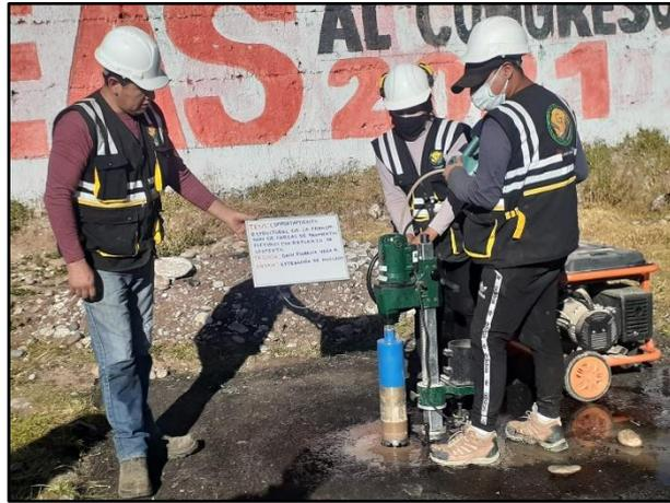
**Fotografía N° 13:** Determinación del grado de compactación de una mezcla bituminosa (MTC E 509)
