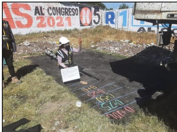
**Fotografía N° 11:** Ensayo de reflectometría – Registro de lecturas de los diales de la viga benkelman.
