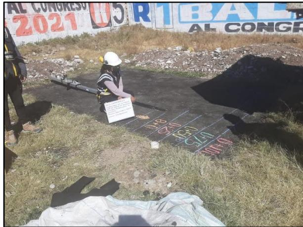
**Fotografía N° 10:** Ensayo de reflectometría – presentación del camión de carga de pesaje 8.2Tn
