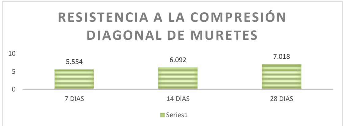
Figura 40: Comparación de promedios de resultados de la Resistencia a compresión diagonal de muretes de 600 mm x 600 mm para el cemento Quisqueya.
