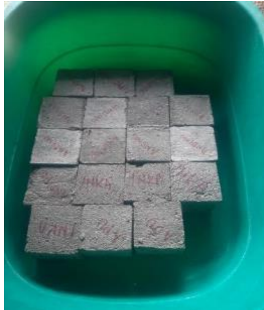
Figura 04: Curado de especímenes cúbicos
