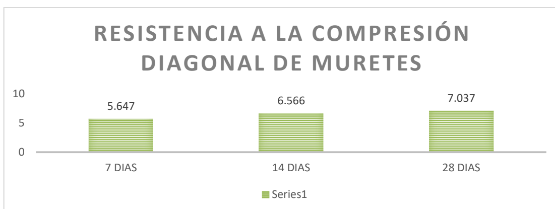
Figura 32: Comparación de promedios de resultados de la Resistencia a compresión diagonal de muretes de 600 mm x 600 mm para el cemento Andino
