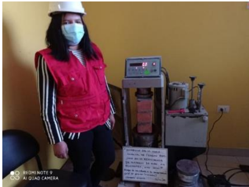
Fig N°03: Rotura de prismas
