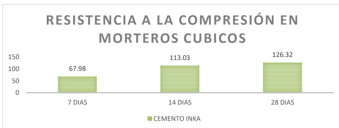
Figura 14: Comparación de promedios de resultados de la resistencia a la compresión de morteros con cemento INKA.
