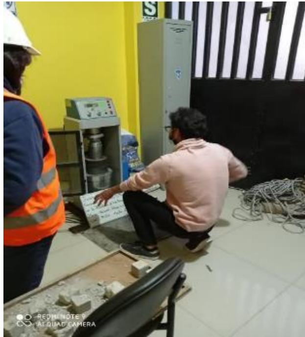
Fig N°05: Rotura de morteros cúbicos
