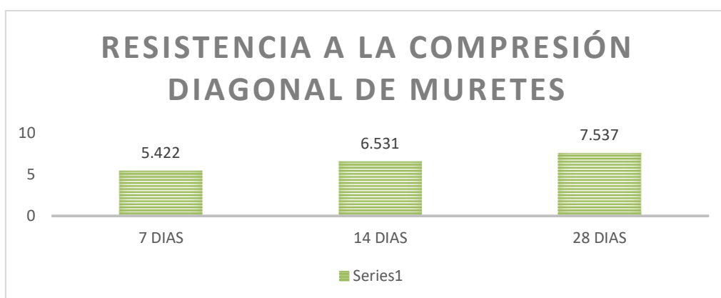
Figura 36: Comparación de promedios de resultados de la Resistencia a compresión diagonal de muretes de 600 mm x 600 mm para el cemento Inka
