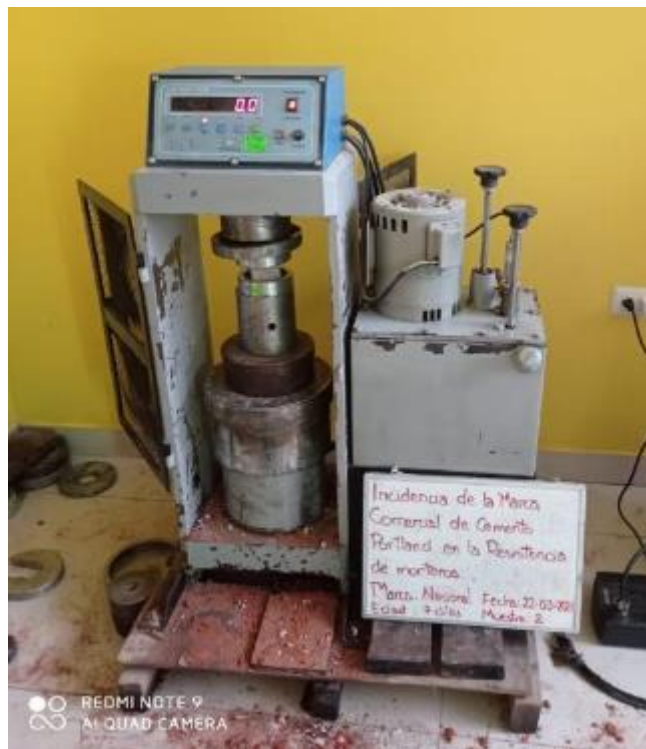
Figura 05: Ensayo de resistencia a la compresión de mortero
