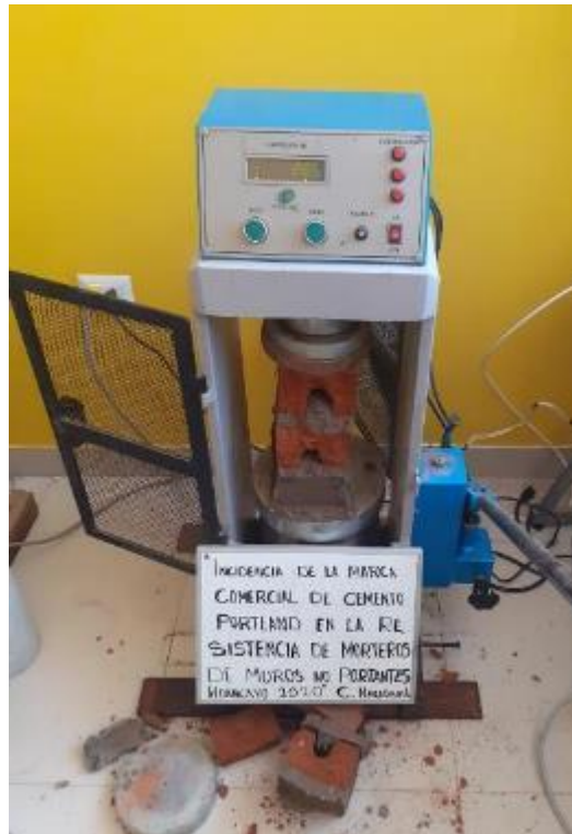
Figura 07: Ensayo de resistencia a la compresión en prisma
