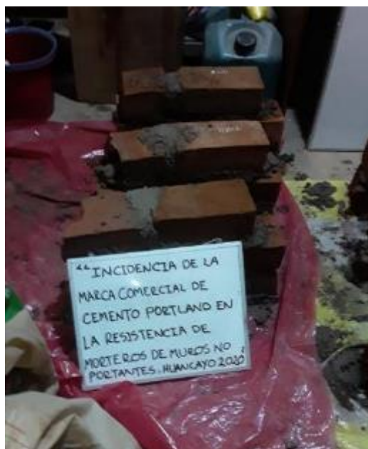
Figura 06: Elaboración de prismas (3 hiladas)
