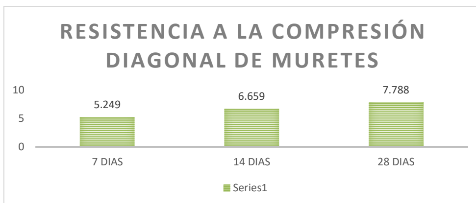
Figura 38: Comparación de promedios de resultados de la Resistencia a compresión diagonal de muretes de 600 mm x 600 mm para el cemento Nacional.
