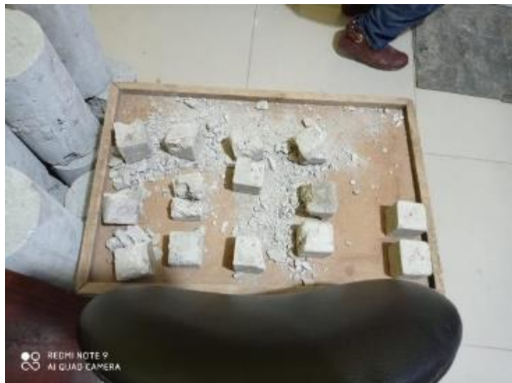
Fig N°06: Rotura de morteros cúbicos
