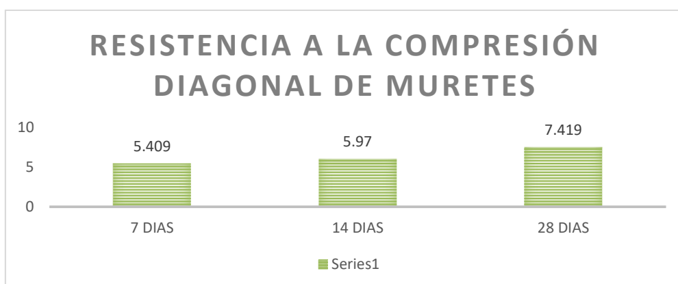
Figura 34: Comparación de promedios de resultados de la Resistencia a compresión diagonal de muretes de 600 mm x 600 mm para el cemento Apu
