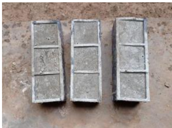
Figura 03: Elaboración de muestras cubicas 50mm x 50mm
