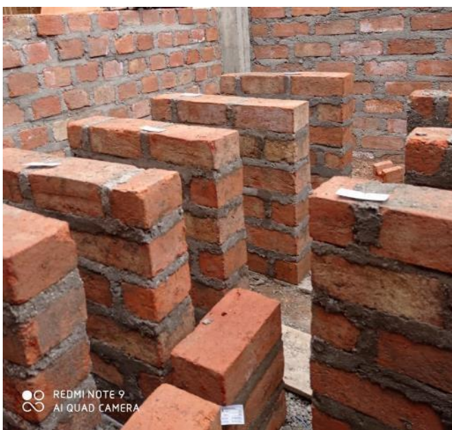
Figura 08: Elaboración de especímenes para muretes
