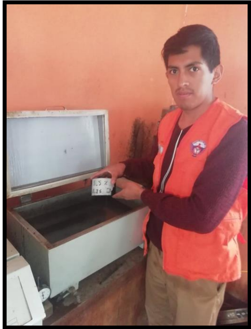
Figura 28. Colocación de briquetas en baño maría.
