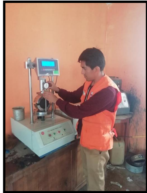
Figura 29. Colocación de briquetas para ensayo Marshall.
