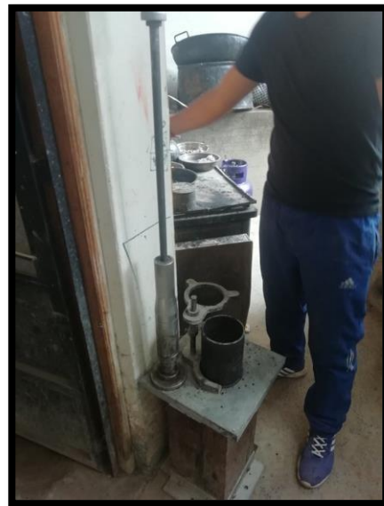
Figura 16. Pedestal y martillo de compactación.
