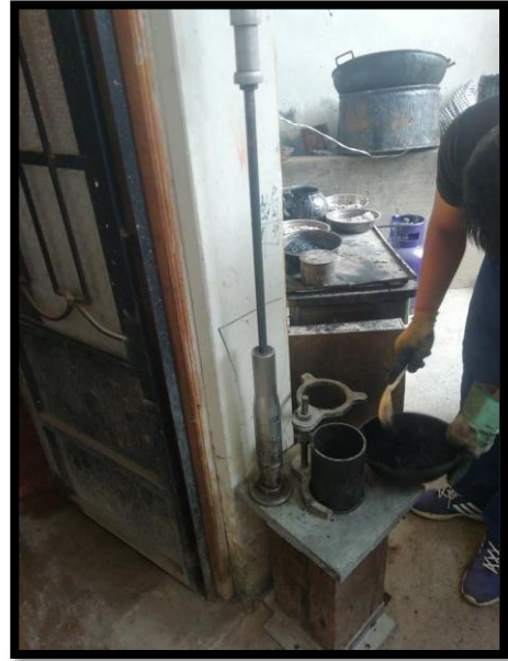
Figura 22. Compactación del material.
