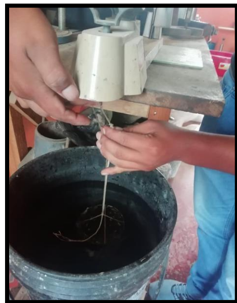
Figura 26. pesado en agua de briquetas.
