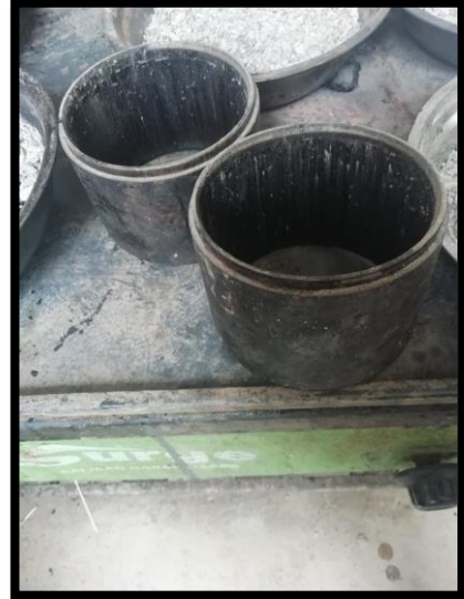
Figura 18. Moldes para briquetas.
