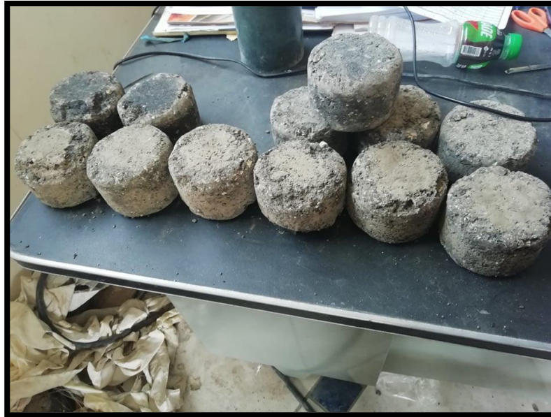
Figura 34. Las diferentes briquetas ensayadas de convencionales y modificadas según su porcentaje de contenido de líquido asfáltico y contenido de molienda de caucho de vehículos pesados y ligeros.
