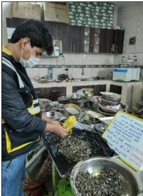
Fotografía 3 Ensayo de Absorción de los agregados de acuerdo a la MTC E205
