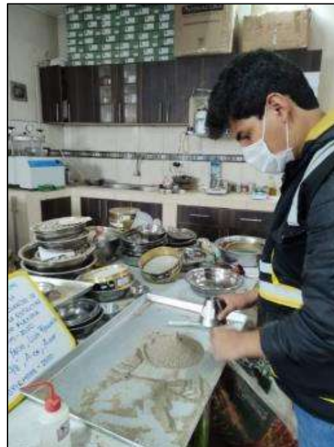
Fotografía 3 Ensayo de Absorción de los agregados de acuerdo a la MTC E205
