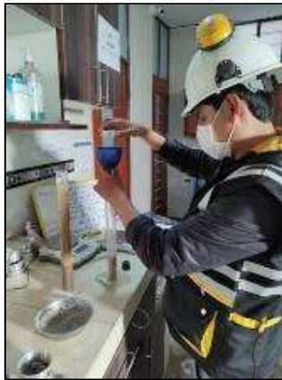
Fotografía 7 Ensayo Equivalente de Arena según la NTP 339.146
