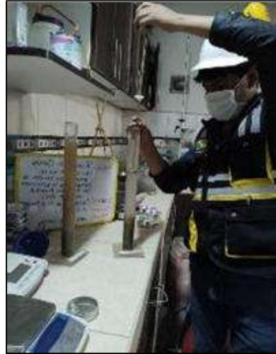
Fotografía 14 Del Ensayo Equivalente de Arena
