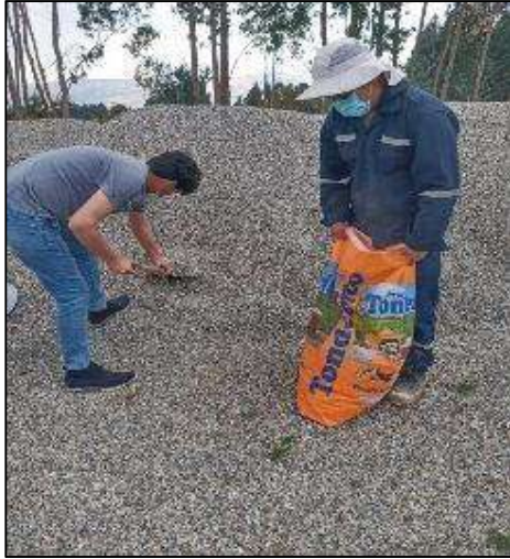
Fotografía 1 Muestreo de agregado grueso para concreto (piedra chancada)
