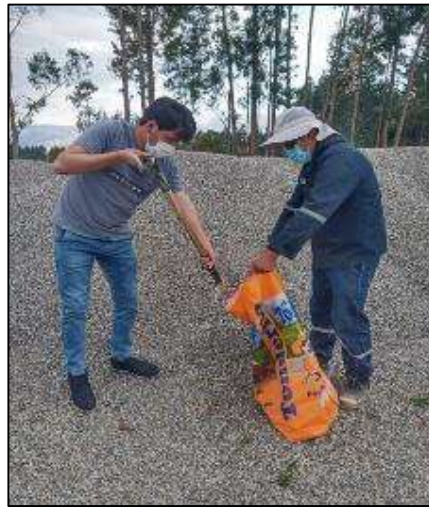
Fotografía 1 Muestreo de agregado grueso para concreto (piedra chancada)
